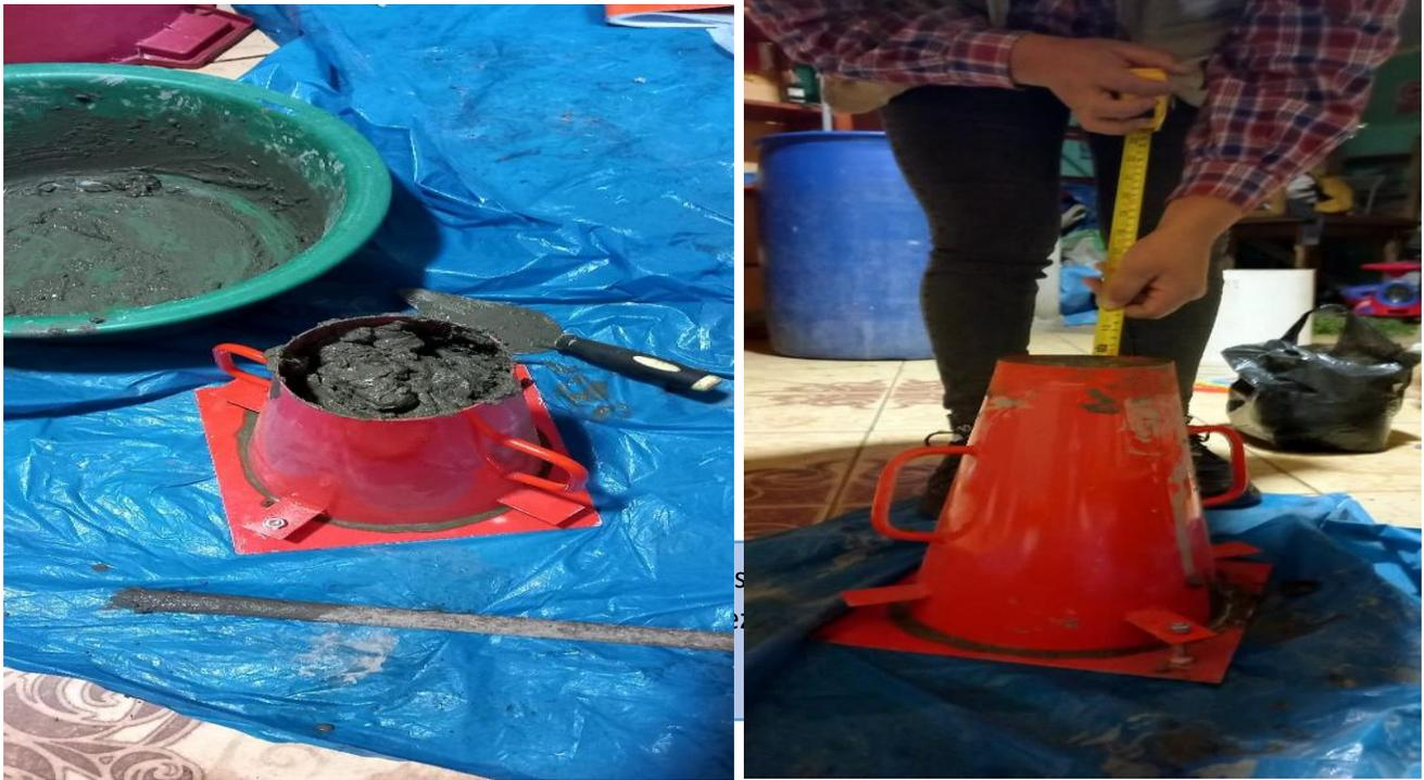
Se procedió a realizar la mezcla para realizar en slump la primera capa debemos apisonarla con la varilla un total de 25 veces penetrando toda la profundidad de esta capa, para la segunda deberemos llenar el molde hasta la mitad igual con 25 golpes, el llenado de la tercera capa es igual, luego voltearemos el molde al revés y lo ponemos junto al concreto, colocamos la varilla sobre el molde y procedemos medir determinando al asentamiento para concreto convencional para el 14 día salió 4”.
