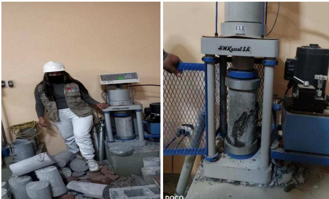
1er testigo a los 7 días con agregado convencional teniendo un tipo de rotura c (cono y corte)
