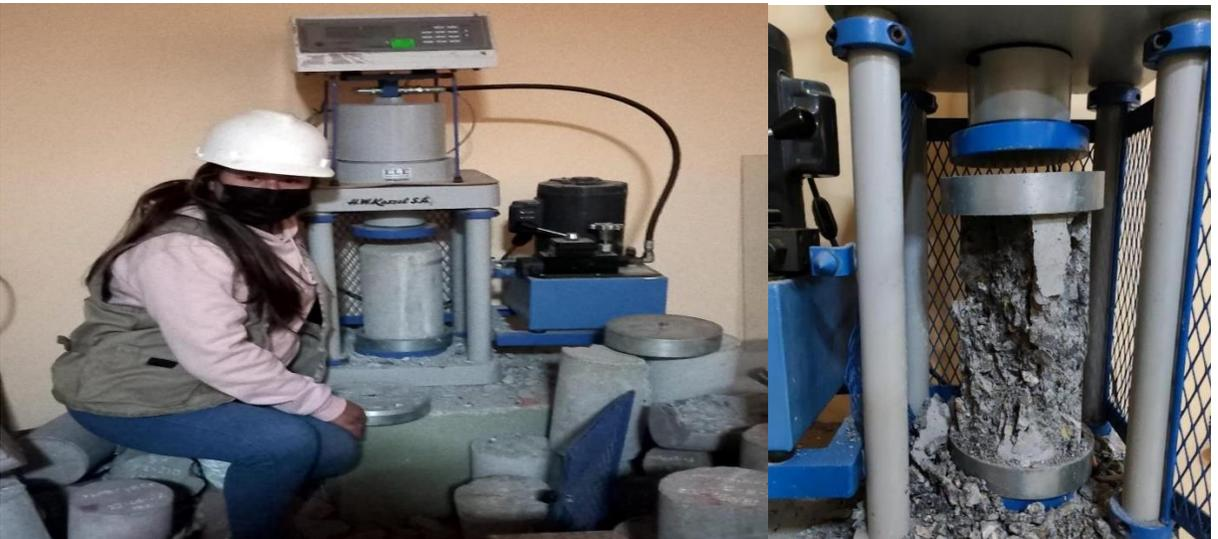
1er testigo a los 7 días con agregado grueso Reciclado con porcentaje de sustitución 40% con tipo de rotura C, 2do testigo teniendo un tipo de rotura C, 3er testigo teniendo un tipo de rotura C (cono y corte).
