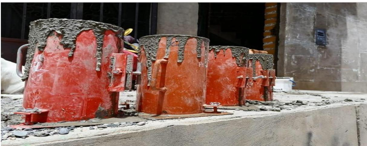
Se observa los moldes llenados, luego procedemos a desmoldar las probetas pasado 24 horas, su llevarlos en recipiente con agua durante durante 14 días
