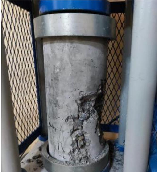
1er testigo a los 21 días con el agregado grueso convencional teniendo un tipo C(cono y corte)
