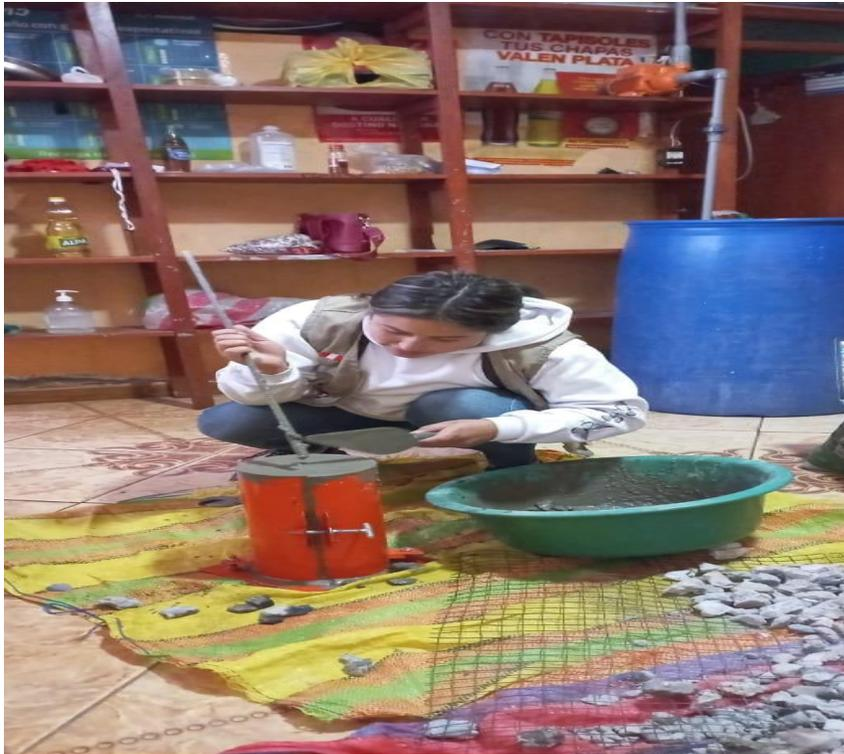
Se procedió a realizar la mezcla para el slump la primera capa debemos apisonarla con la varilla un total de 25 veces penetrado toda la profundidad esa capa, para la segunda capa hasta que este lleno y lo enrasaremos con ayuda de la varilla con el porcentaje del concreto reciclado de 40%.
