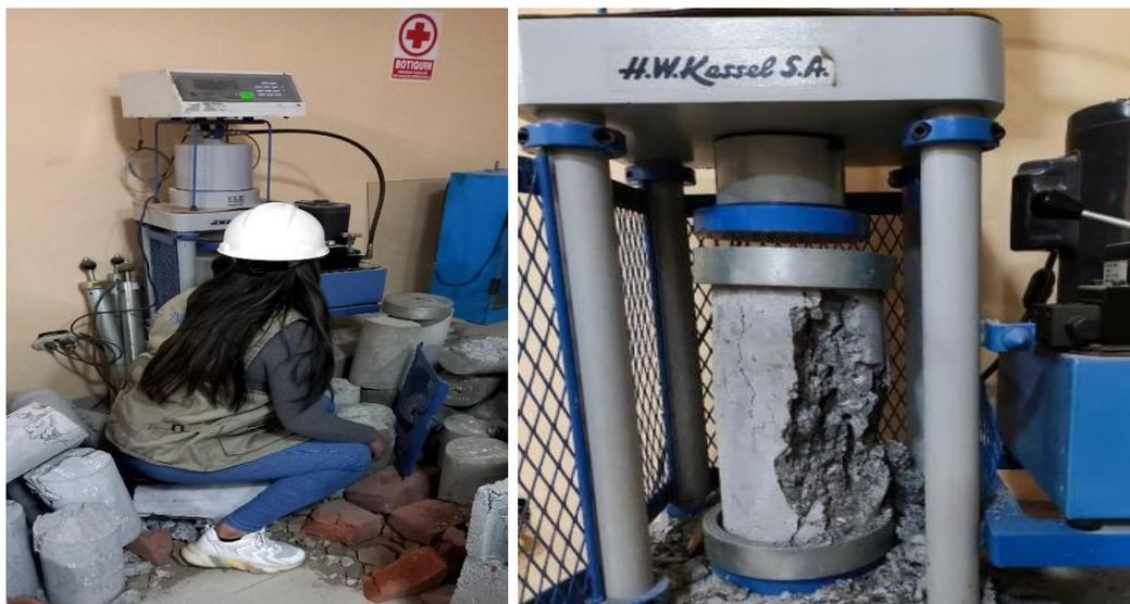
2do testigo a los 14 días con agregado grueso convencional teniendo un tipo de rotura C (cono y corte), 3er testigo a los 14 días con agregado grueso teniendo un tipo de rotura C (cono y corte).
