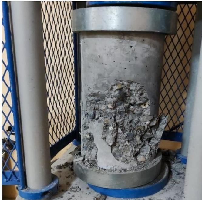
2do testigo a los 21 días con agregado grueso convencional teniendo un tipo C(cono y corte), 3er testigo a los 21 días con agregado grueso convencional teniendo un tipo C (cono y corte)
