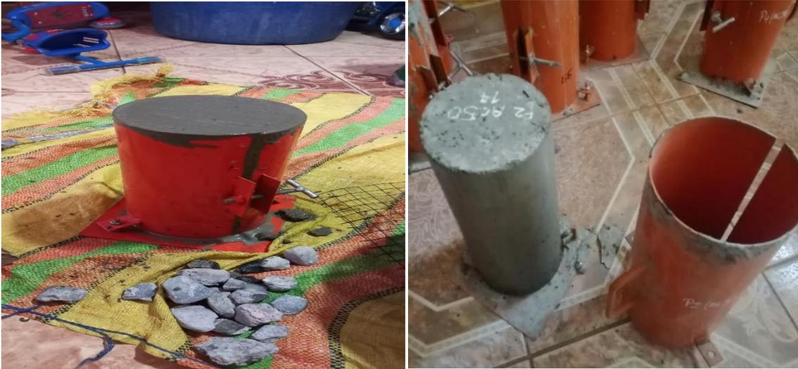
Procedemos a desmoldar las probetas pasado las 24 horas se realizar, después de haber sido desmoldada se procede a colocar las probetas inmediatamente en recipientes con agua potable, para su curado durante los 7 días sumergidos en agua
