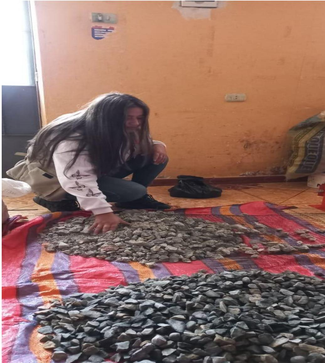
Se procedió a tamizar el agregado reciclado para mayor presión por la malla  $\frac{3}{4}$  después de trasladarlo de la chancadora y obtuvimos el material requerido para la realización de las probetas.
