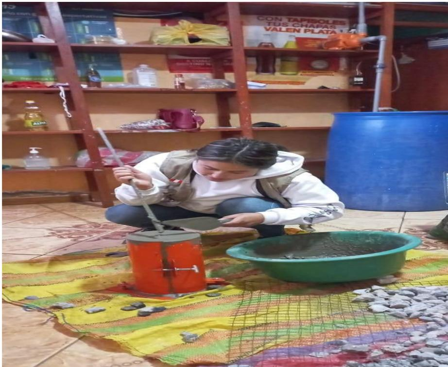
Se procedió a realizar la mezcla para realizar el slump con el porcentaje de agregado reciclado de 30%
