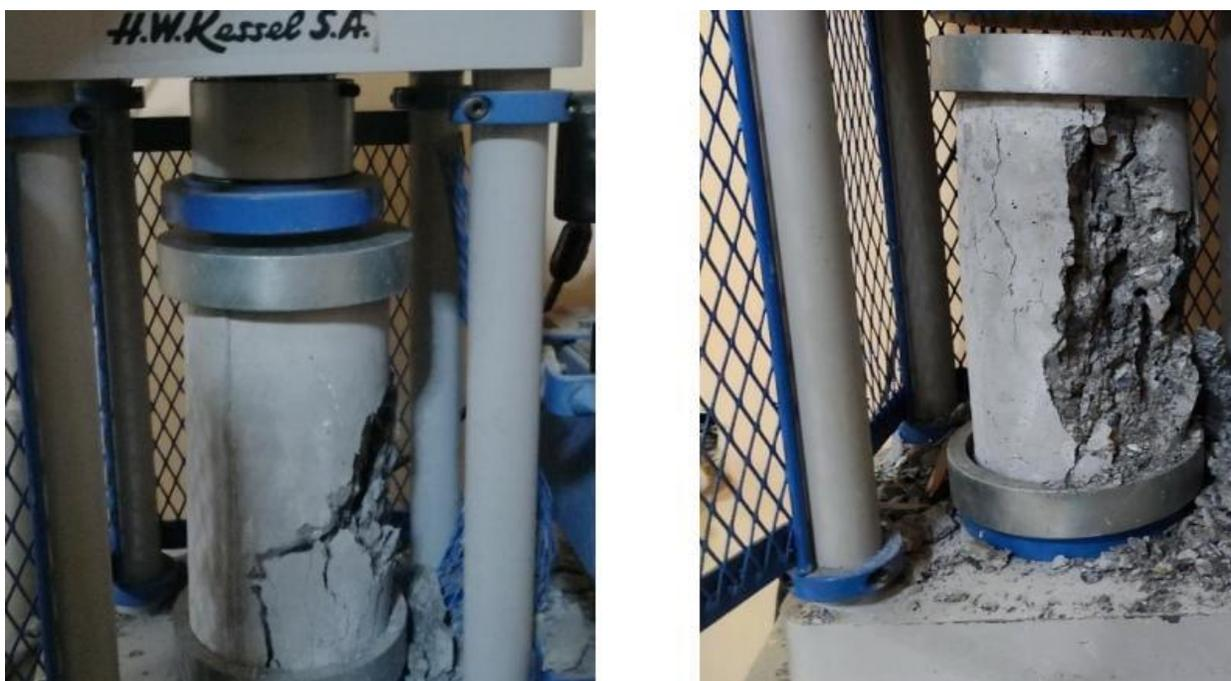
2do testigo a los 28 días con agregado grueso convencional teniendo un tipo de rotura C (cono y corte), 3er testigo a los 28 con agregado grueso convencional tenido un tipo de rotura C (cono y corte)
