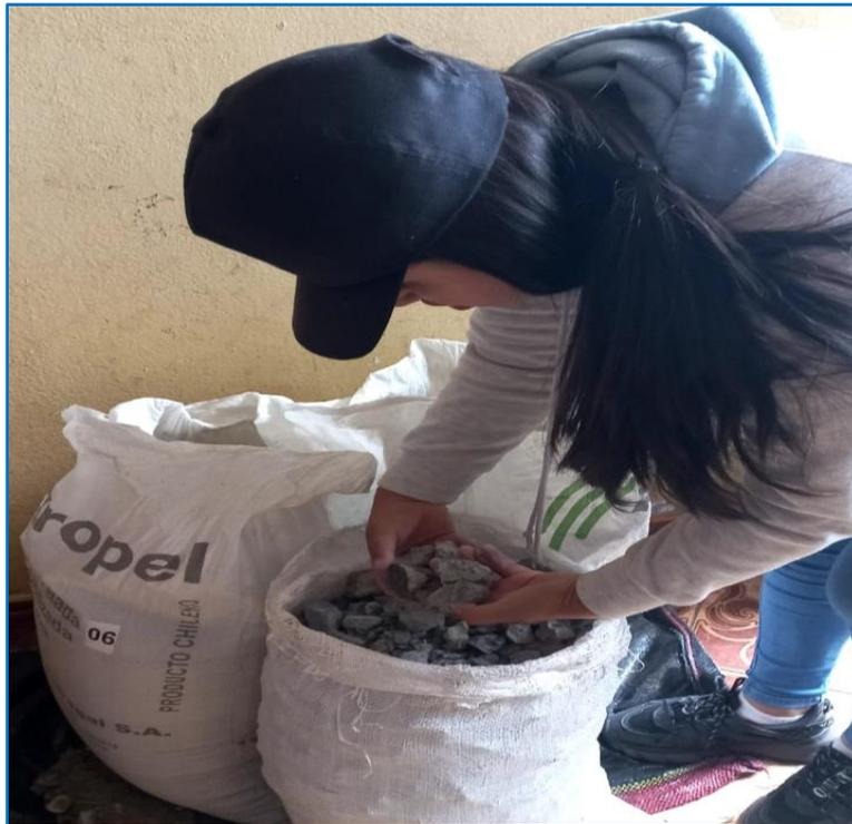
Se observa, el material reciclado recogido de la chancadora con el tamaño requerido de  $\frac{3}{4}$ ".
