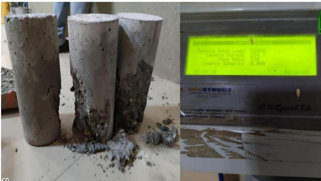
2do testigo a los 7 días con agregado grueso reciclado con porcentaje en sustitución 30% teniendo un tipo de rotura C (cono y corte), 3er testigo a los 7 días con agregado grueso reciclado con porcentaje de sustitución de 30% teniendo un tipo C (cono y
