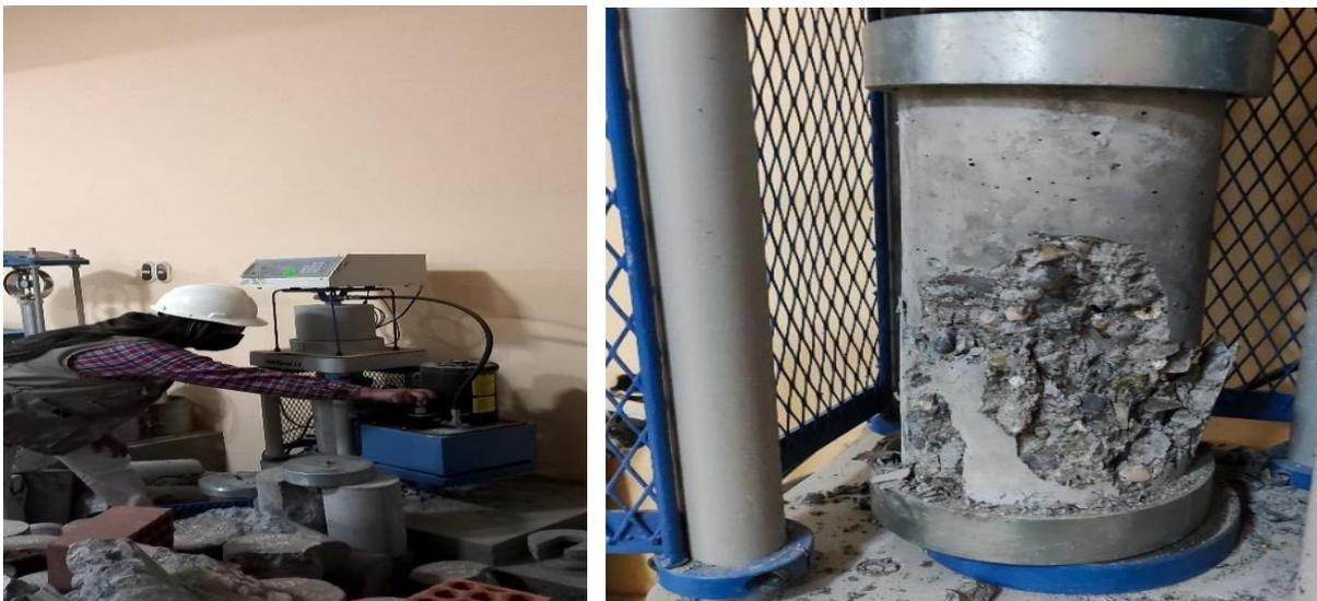
1er testigo a los 28 días con agregado grueso convencional teniendo un tipo de rotura C (cono y corte)
