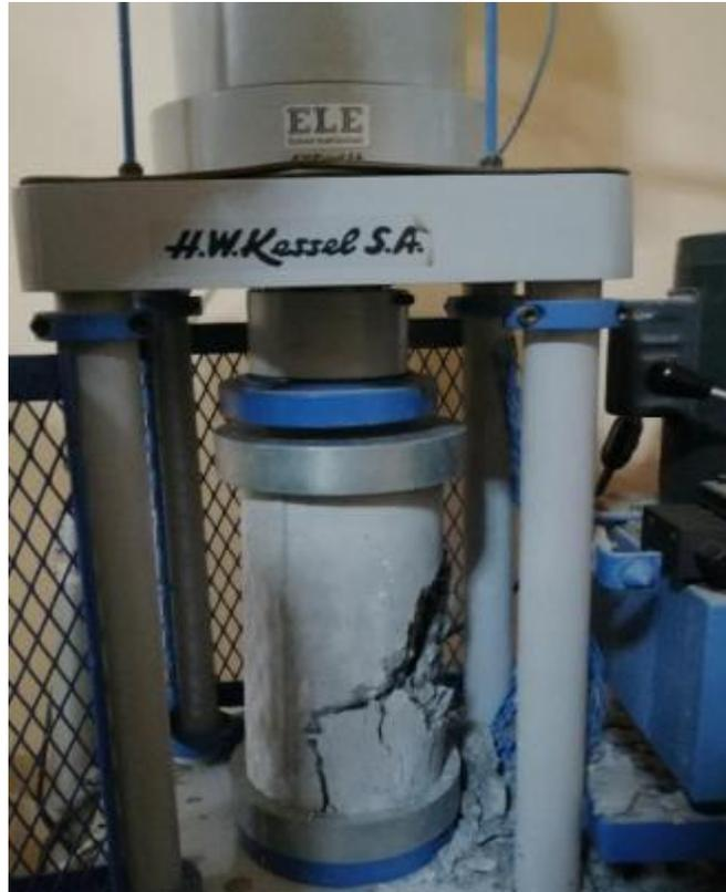
Rotura del 1er testigo de probetas a los 14 días con agregado grueso Reciclado con porcentaje sustitución de 40% tipo de rotura B (cono y corte), 2do testigo teniendo un tipo B (cono y corte), 3er testigo teniendo un tipo de rotura C (cono y corte).
