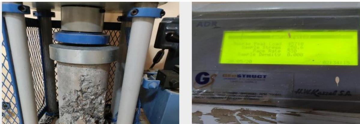
Rotura del 1er testigo de probetas a los 21 días con agregado grueso Reciclado con porcentaje de sustitución 40% con tipo de rotura C, 2do testigo teniendo un tipo de rotura C, 3er testigo teniendo un tipo de rotura C (cono y corte).
