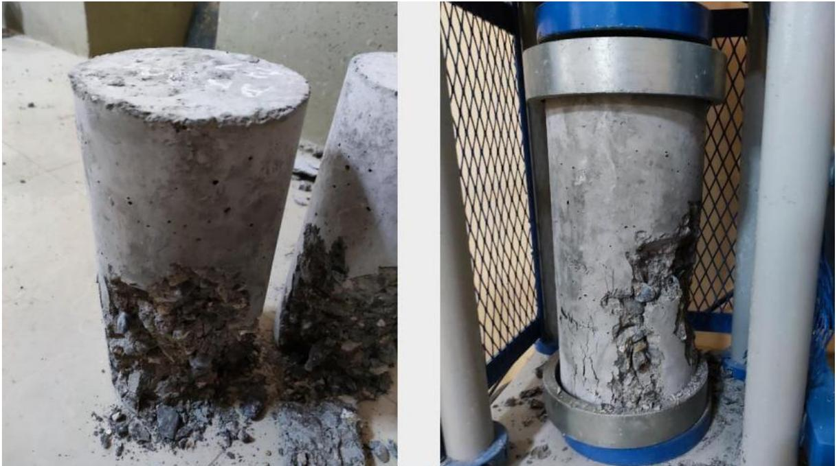
1er testigo a los 28 días con agregado reciclado con porcentaje de sustitución 30% con tipo de rotura C (cono y corte), 2do testigo teniendo un tipo de rotura C, 3er teniendo un tipo de rotura C (cono y corte).
