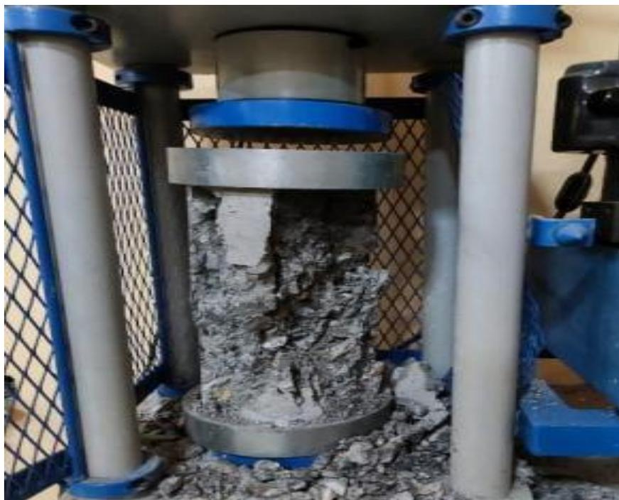
1er testigo a los 14 días con agregado grueso convencional teniendo un tipo de rotura C (cono y corte)
