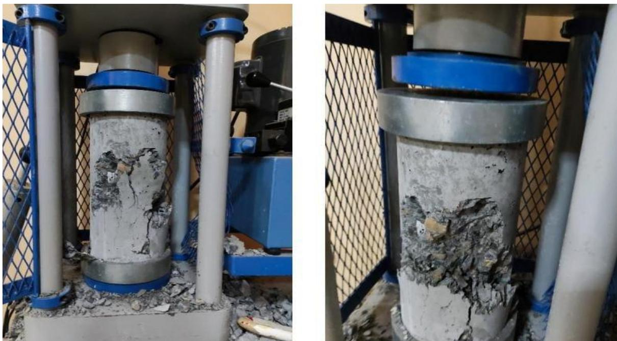
1er testigo a los 28 días de agregado grueso Reciclado en los porcentajes de sustitución 40% con rotura tipo C, 2do testigo teniendo un tipo de rotura C, 3er testigo teniendo un tipo de rotura C (cono y corte)
