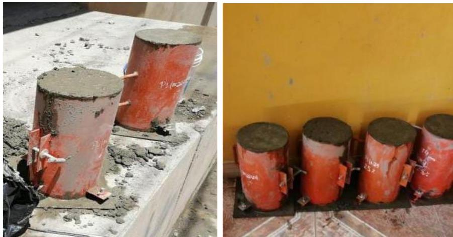
Se observa los moldes llenados de concreto reciclado con porcentaje de 40 %, luego se desmolde, luego inmediatamente es llenado en recipiente con agua potable para su curado de 7 días sumergidos en agua
