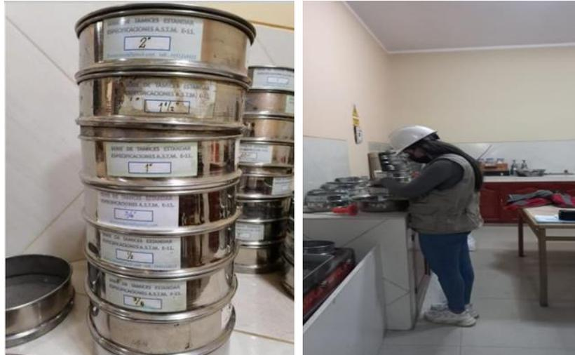
Para los **análisis granulométrico** se lava los materiales y colamos los tamices, para el agregado grueso se utilizara, los tamices de 2" hasta el número 4" es considerado el agregado grueso y todo lo que pasa el N° 4 al N°200.
