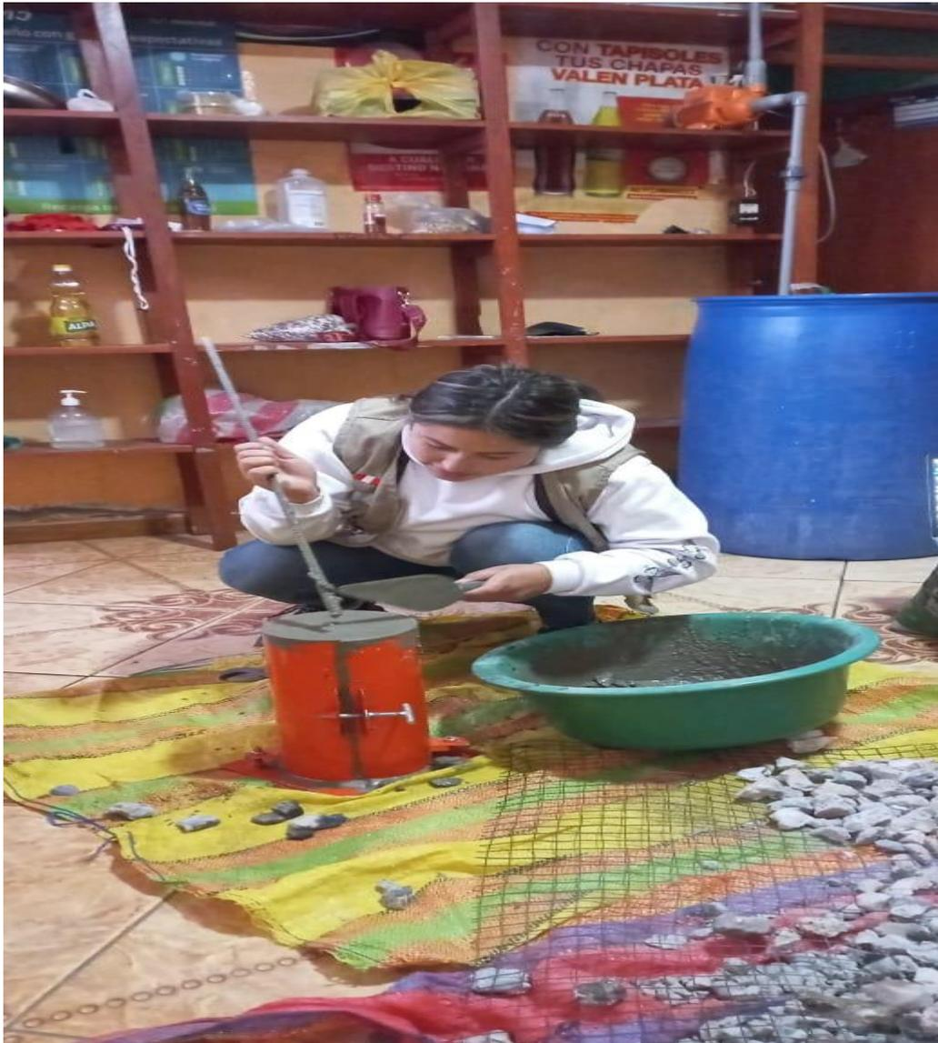
Se procedió a realizar la mezcla para realizar en slump la primera capa debemos apisonarla con la barrila un total de 25 veces penetrando toda la profundidad de esta capa, para segunda capa deberemos llenar el molde hasta la mitad igual con 24 golpes. El relleno de la tercera capa es igual al de la segunda hasta que esté lleno y lo enseraremos con la ayuda de la varilla, luego que levantamos el molde y procedemos a medir determinado el asentamiento para el concreto convencional salió 4".
