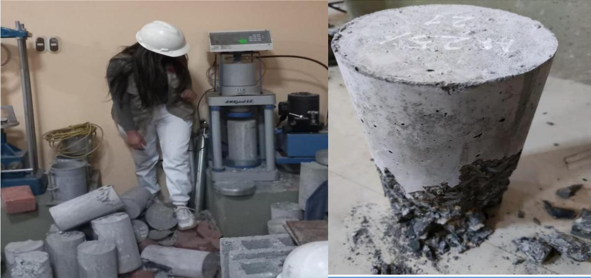
1er testigo a los 14 días con agregados grueso Reciclado con porcentaje 30% con tipo de rotura "B", 2do testigo teniendo un tipo de rotura "B" (cono y corte), 3er testigo teniendo un tipo C (cono y corte)
