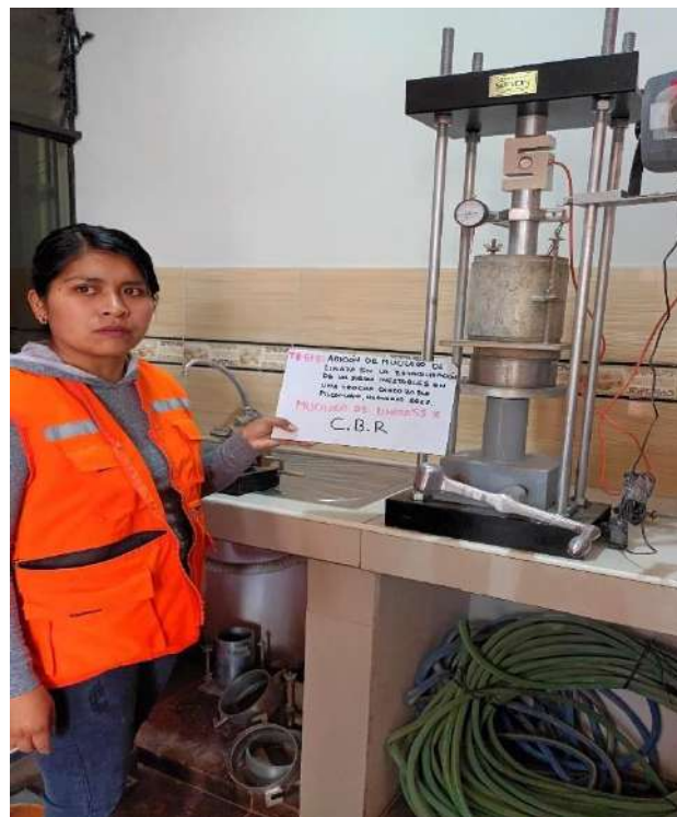
Imagen 21: ensayo de CBR al 55% ML
