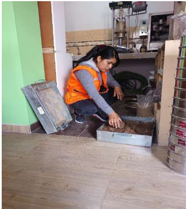
Imagen 13: mezclado y colocación de la muestra para el CBR
