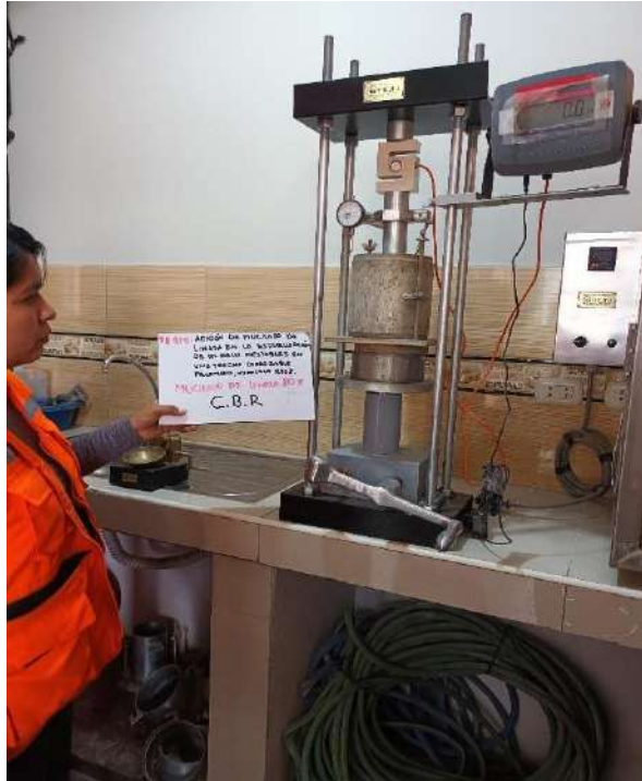
Imagen 14: ensayo de CBR para ver el grado de penetración al 30%ML
