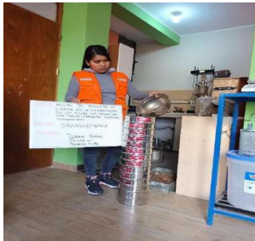
Imagen 9: ensayo de granulometría con la muestra lavada
