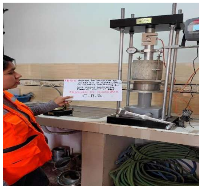
Imagen 23: ensayo de CBR al 80% ML
