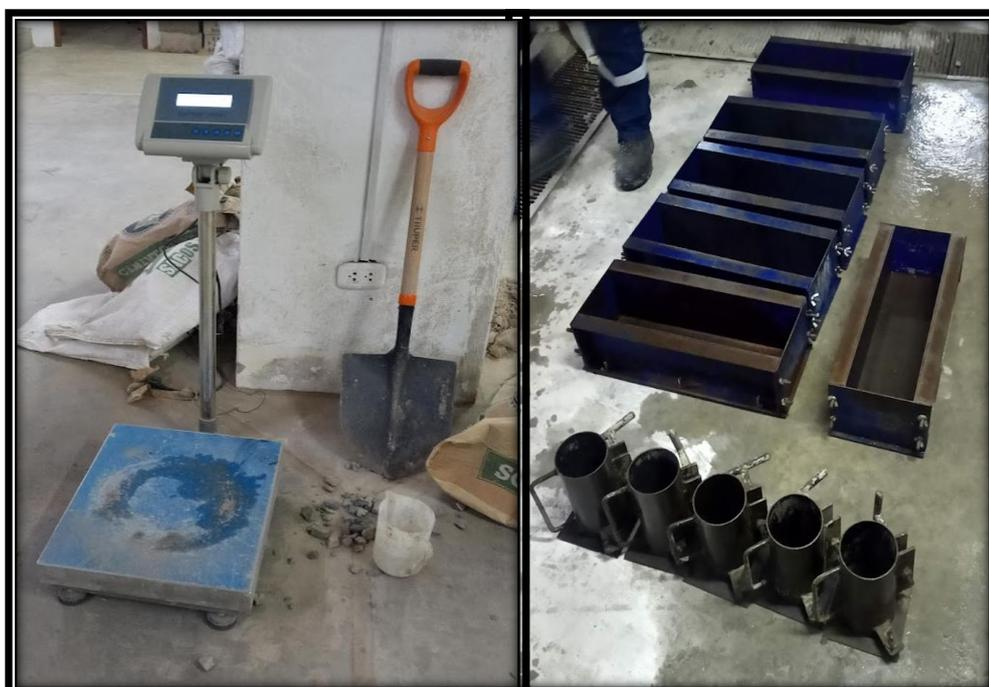
*Figura 12 Balanza – pala – moldes para probetas cilíndricas y vigas*
