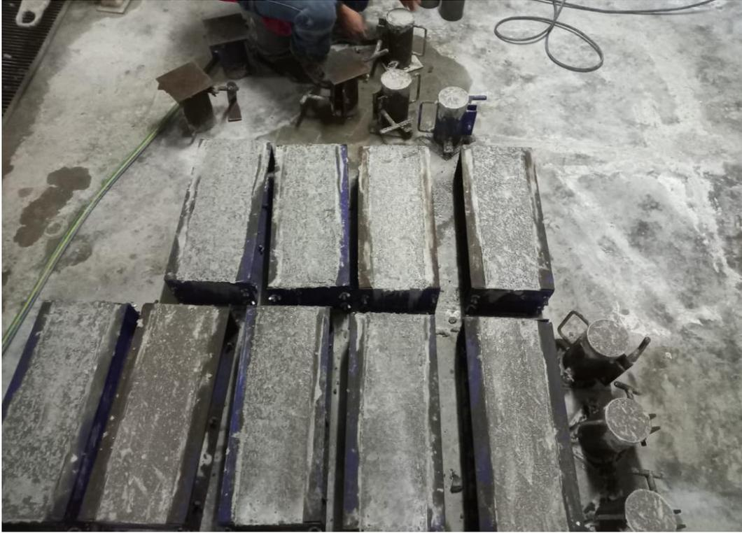
**Figura 13** Desmoldado de las probetas y vigas de concreto
