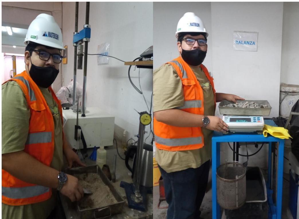
**Figura 8** Ensayo de peso específico de los agregados
