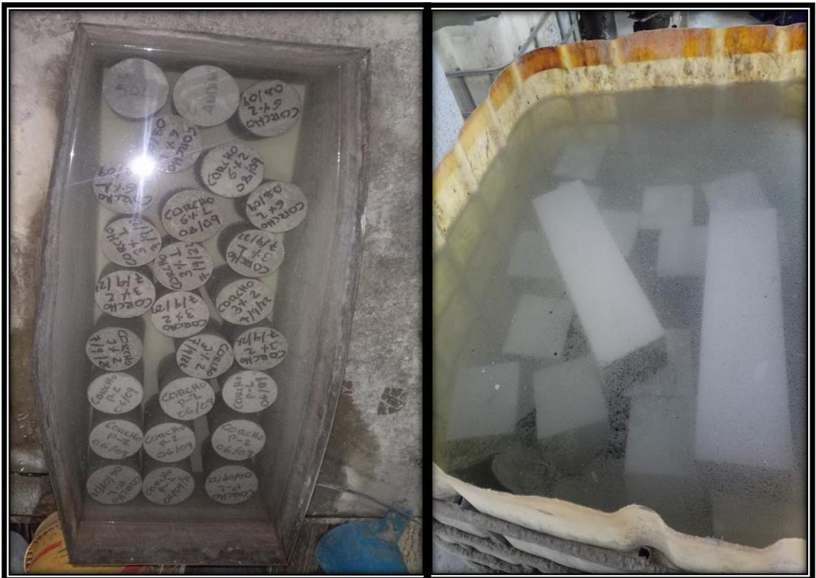
*Figura 16 Curado de probetas y vigas de concreto.*
