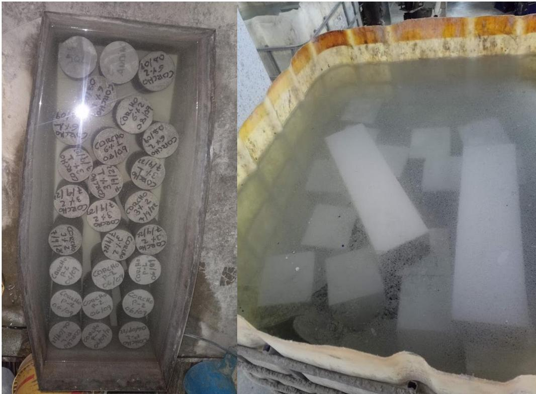
**Figura 14** Curado de probetas y vigas de concreto
