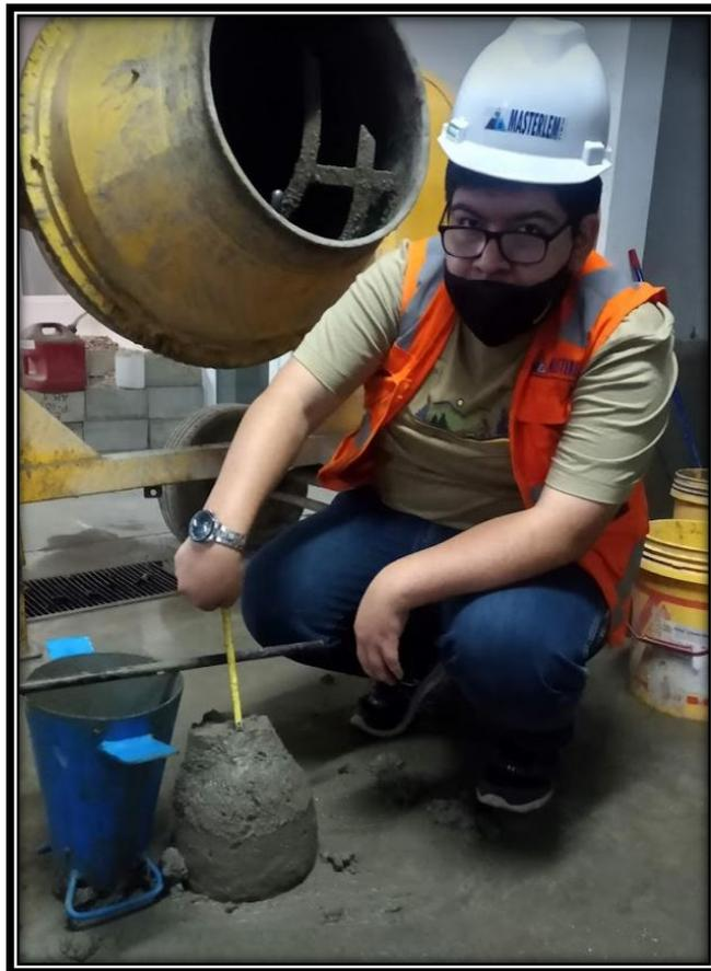
*Figura 18 Medición del asentamiento del concreto patrón.*
