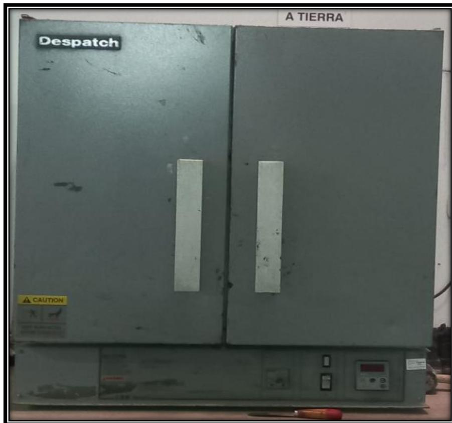
*Figura 8 Horno de secado*
