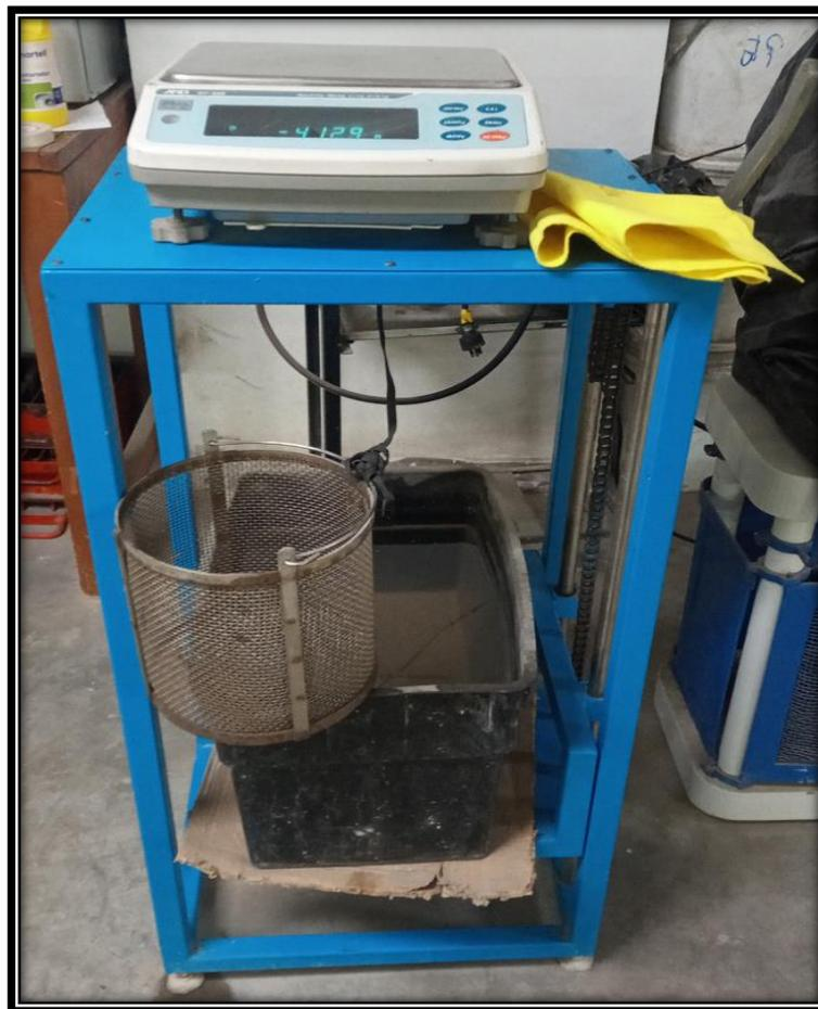
*Figura 11 Balanza – cesta – depósito de agua*
