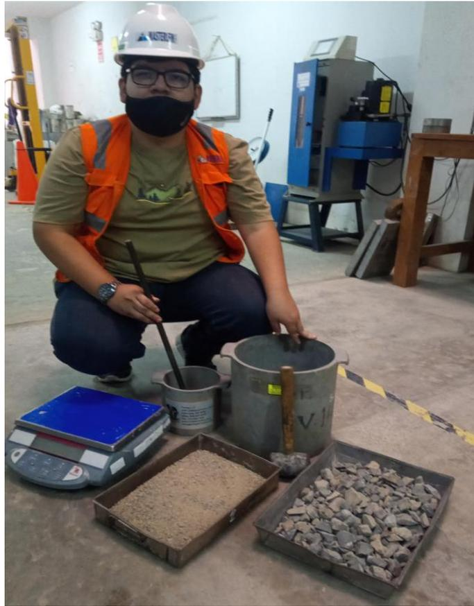
**Figura 7** Ensayo de peso unitario suelto y compactado
