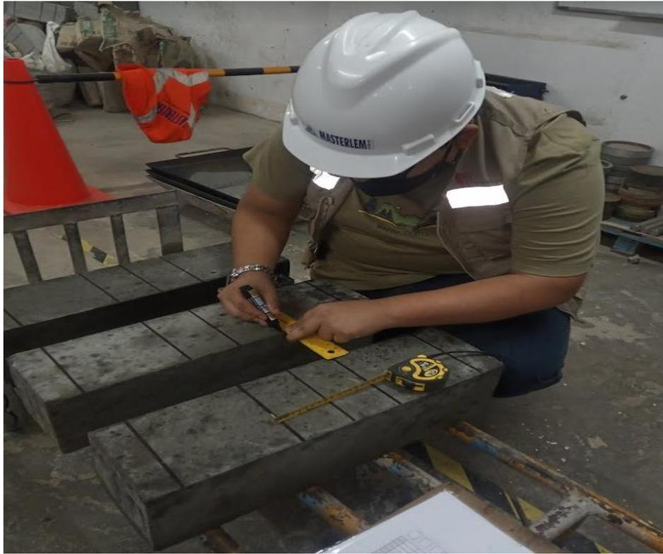
**Figura 15** Trazado de línea para la ubicación de los apoyos para el ensayo de flexión
