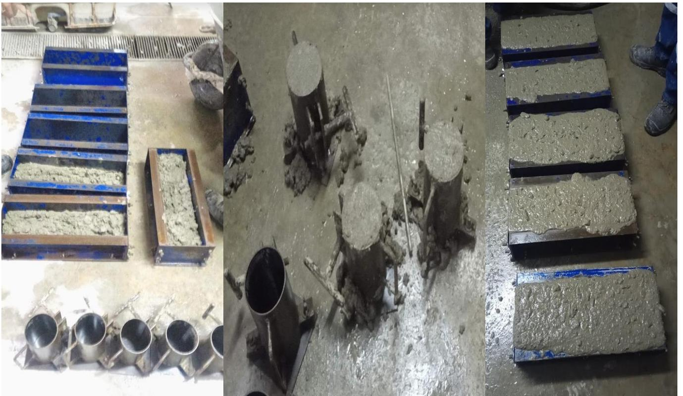
**Figura 12** Elaboración de probetas cilíndricas y vigas de concreto
