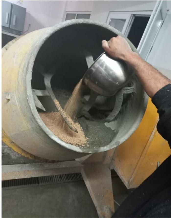
**Figura 9** Adición del corcho a la mezcladora
