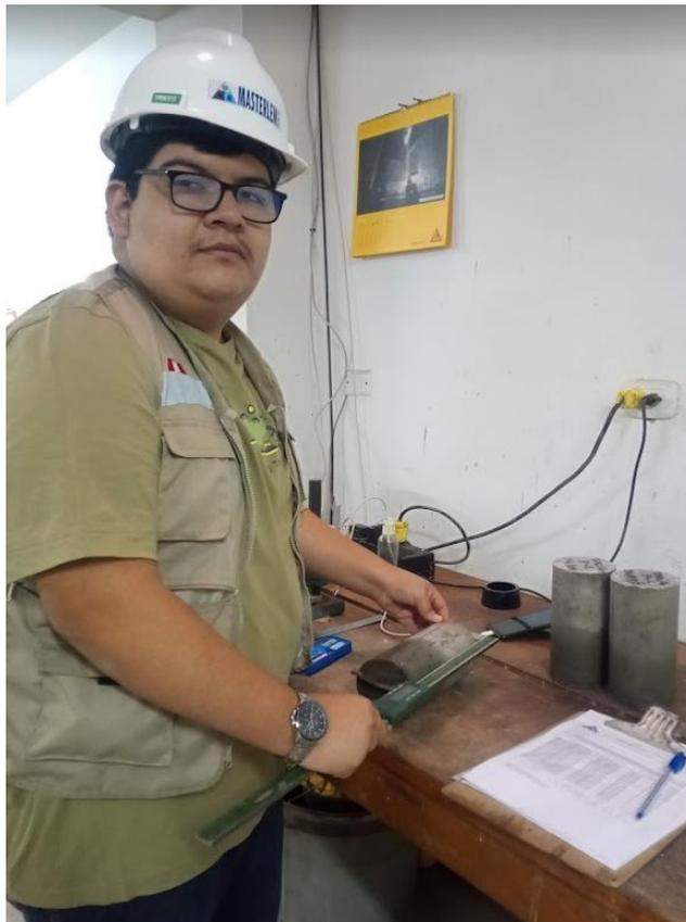
**Figura 16** Toma de medidas de diámetro y altura de las probetas
