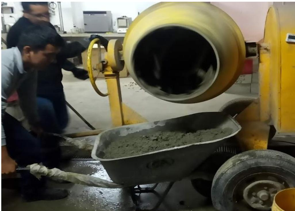
**Figura 10** Recepción del concreto para ensayo de asentamiento
