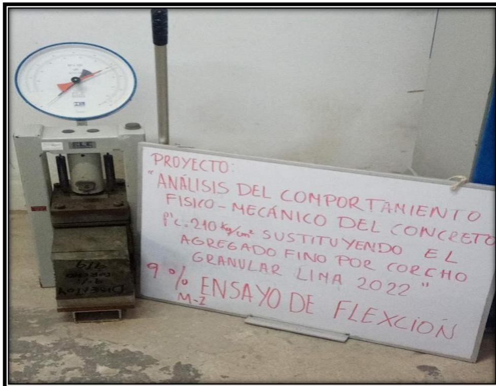
Figura 27 Ensayo de flexión del concreto con sustitución de 8% a los 7 días.
