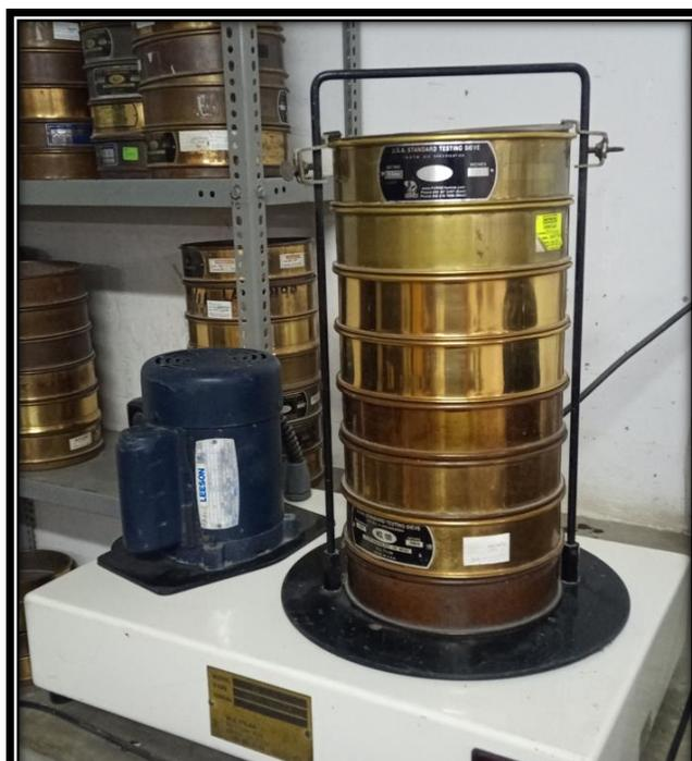
Figura 6 Agitador mecánico de tamices
