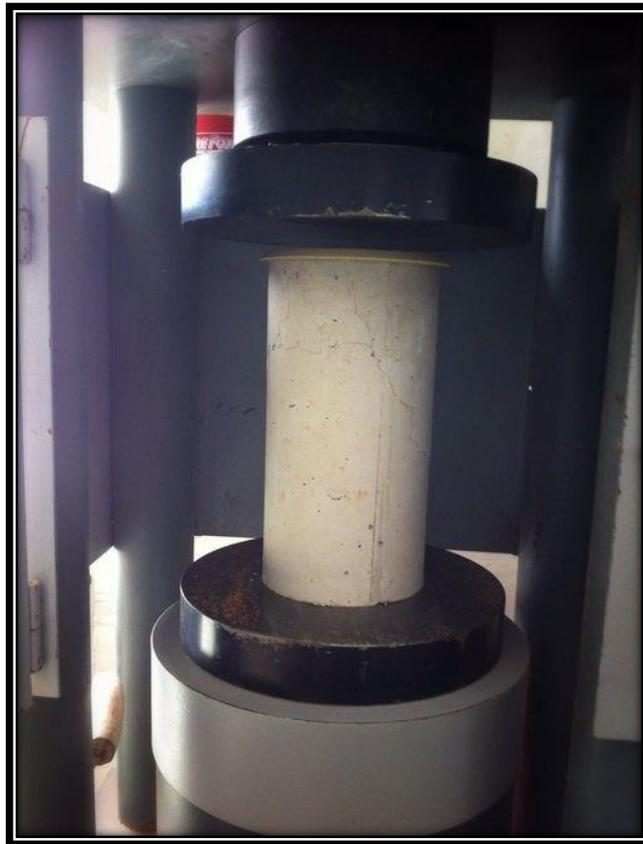
*Figura 3 Ensayo de compresión del concreto*
