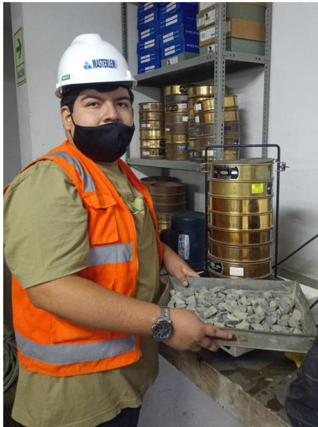
**Figura 6** Ensayo granulométrico del agregado grueso
