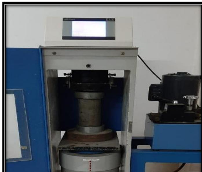
Figura 20 Ensayo de compresión de concreto con sustitución de 3% a los 28 días.
