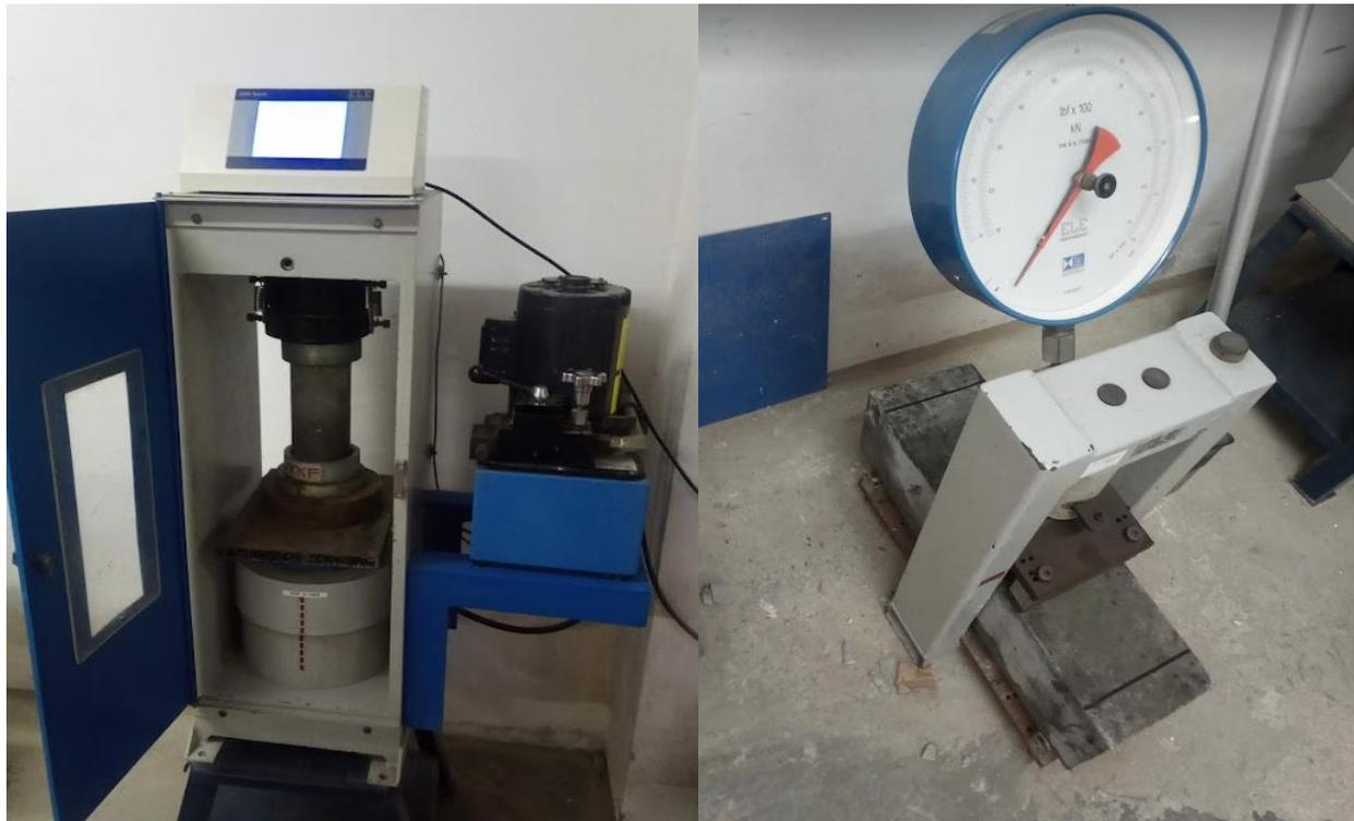
Figura 17 Ensayo de compresión y flexión del concreto
