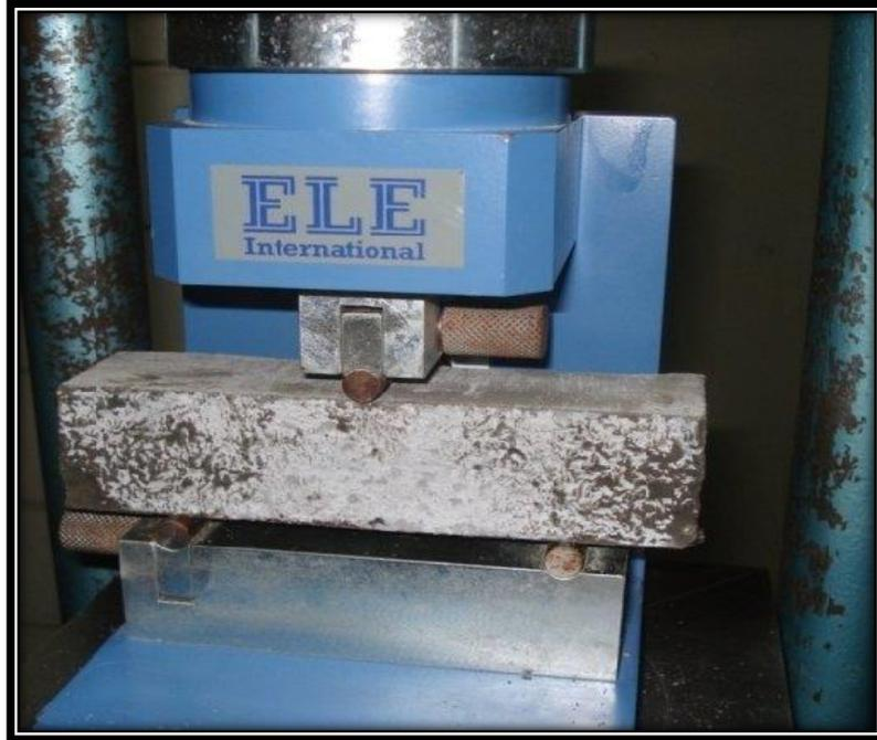
*Figura 4 Ensayo de flexión en viga de concreto.*
