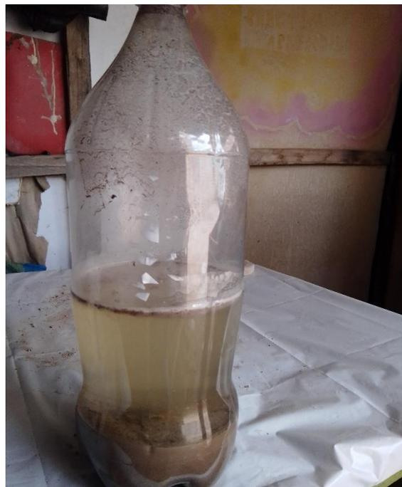
**Figura 8:** Prueba de la botella, para determinar la proporción de los componentes principales.
