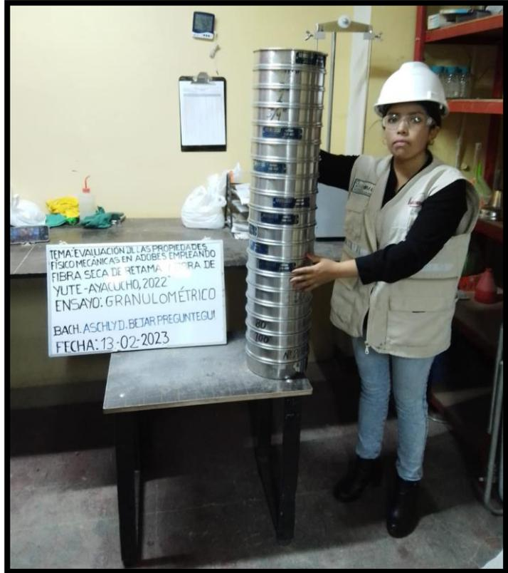
Figura 86: Ensayo de granulometría.
