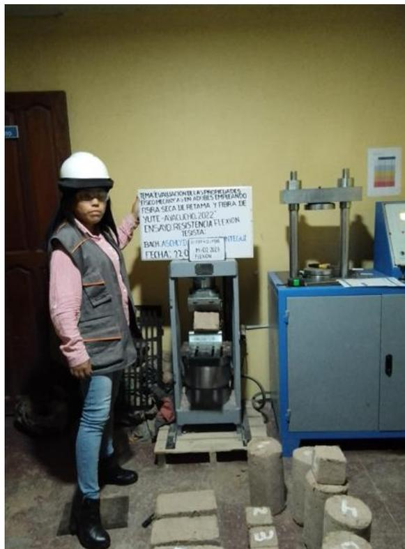
Figura 47: Ensayo esfuerzo a flexión
