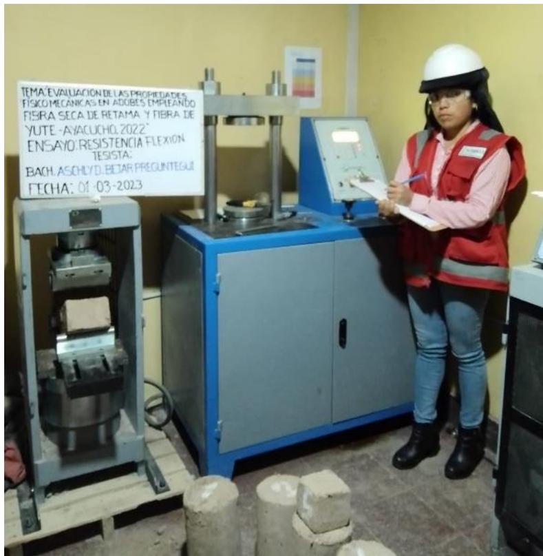
**Figura 28:** *Proceso de elaboración del ensayo de resistencia a la flexión.*
