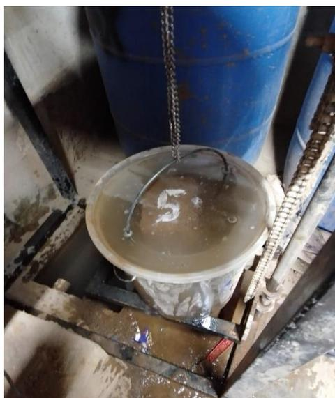
**Figura 3 5 :** Segundo paso para ensayo de absorción.
