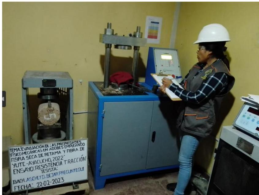
Figura 54: Ensayo resistencia a la tracción
