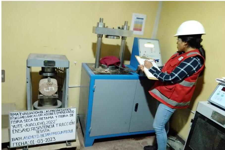
Figura 53: Ensayo resistencia a la tracción
