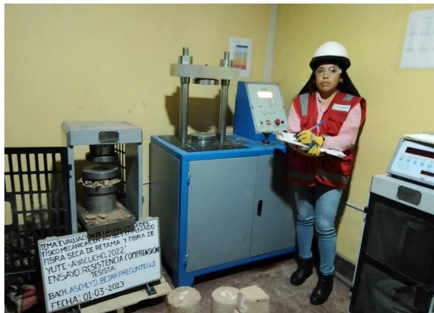
*Figura 27: Proceso del ensayo de resistencia a la compresión.*
