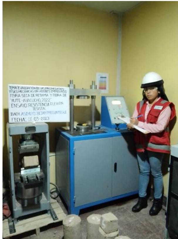
Figura 48: Ensayo esfuerzo a flexión
