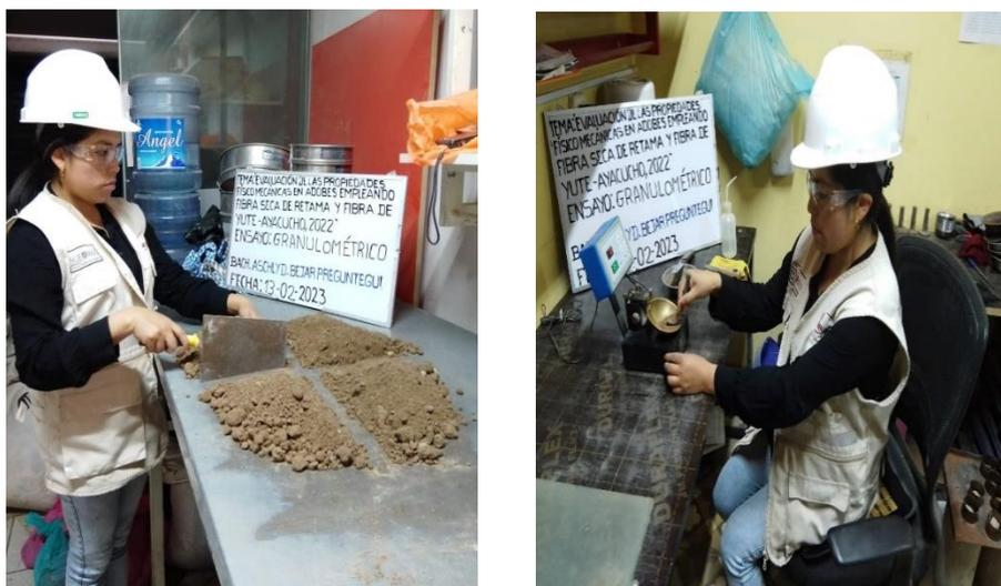
Figura 38. Realizando el ensayo de granulometría.
