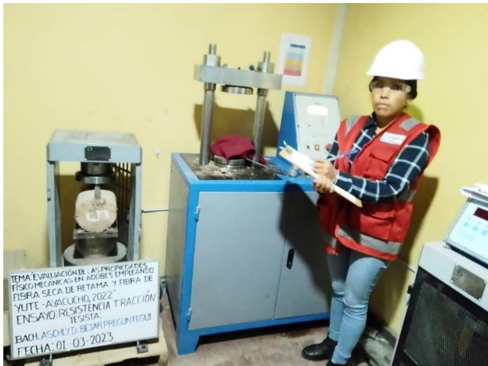
**Figura 29:** *Proceso de elaboración del ensayo de resistencia a la tracción.*
