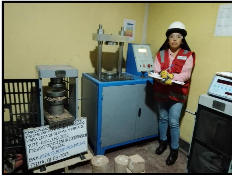
**Figura 79:** *Ensayo de resistencia a la compresión.*
