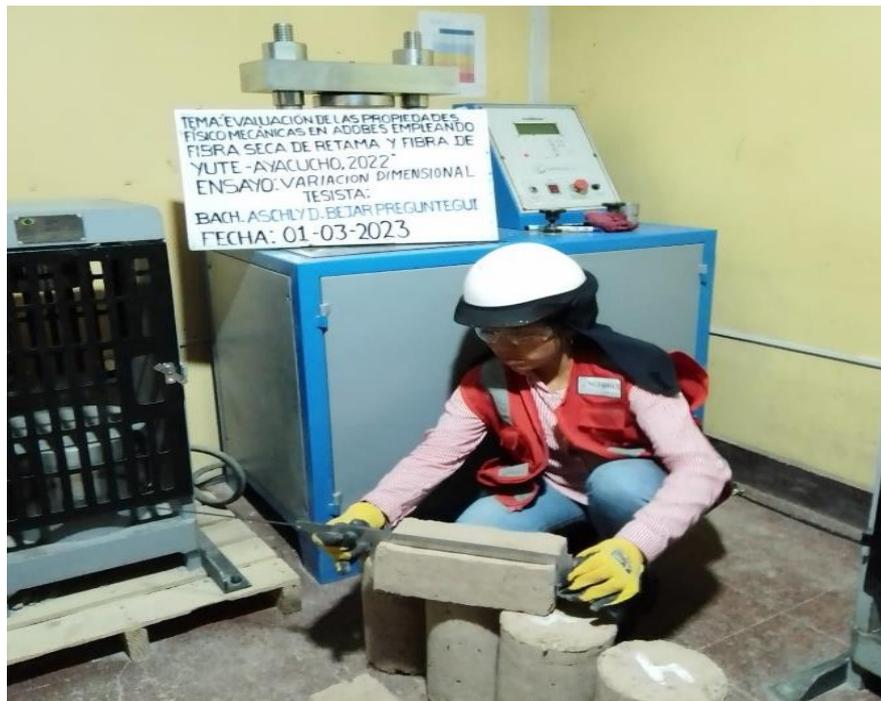
*Figura 26: Realizando ensayo de variación dimensional.*
