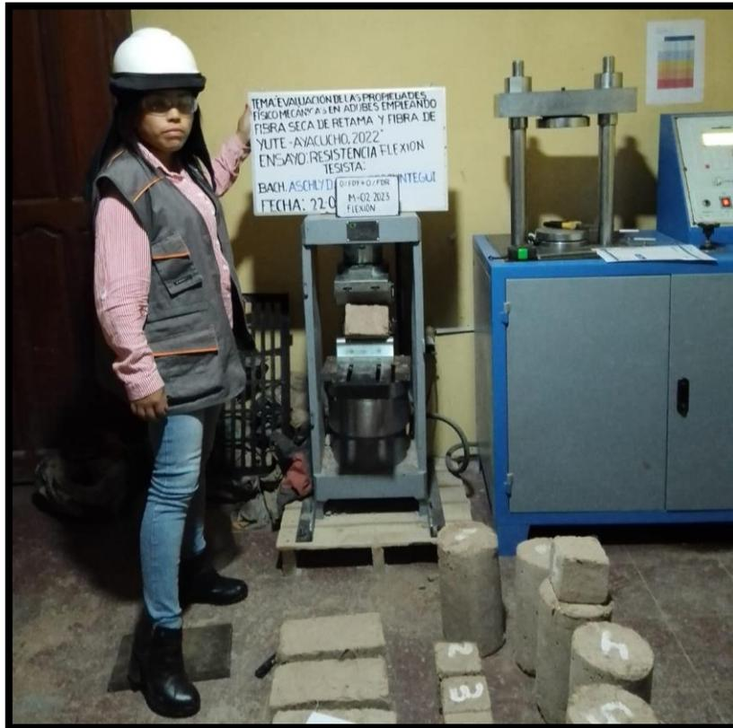
**Figura 81:** *Ensayo de resistencia a la flexión.*
