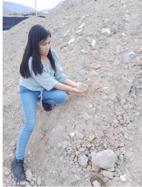
**Figura 68:** *Extracción de una muestra de suelo para ensayo de granulometría.*
