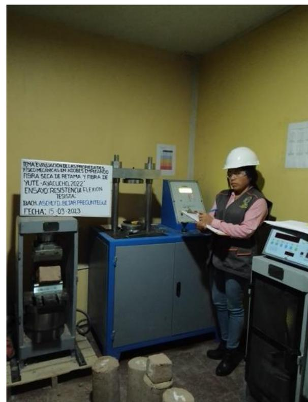
Figura 49: Ensayo esfuerzo a flexión
