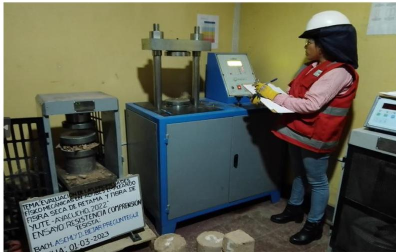
Figura 44: Ensayo a Compresión.
