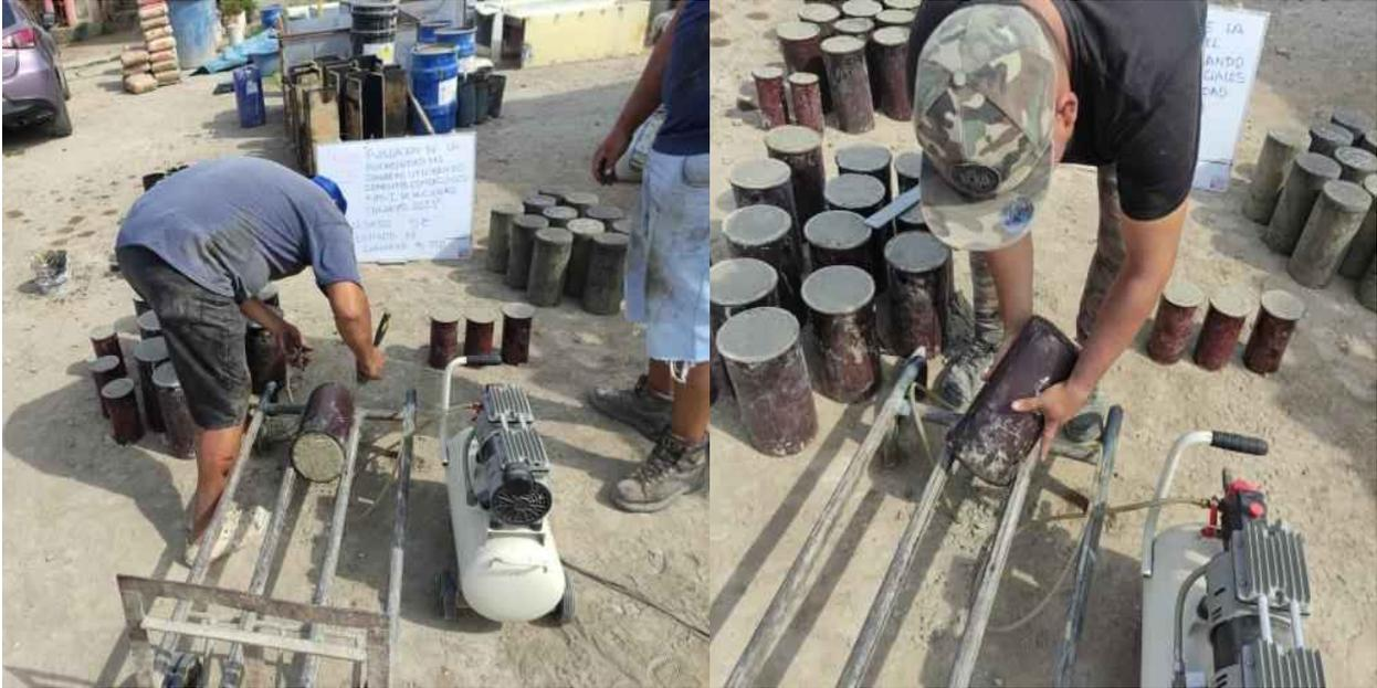
**Curado de probetas de concreto**
