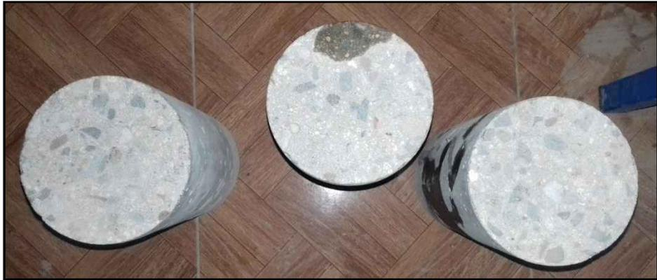
Colocación de las muestras de concreto (QUISQUEYA  $f'c= 175$  kg/cm<sup>2</sup>) en la máquina de ensayo en laboratorio durante 3 días a una presión de 72.52psi.
