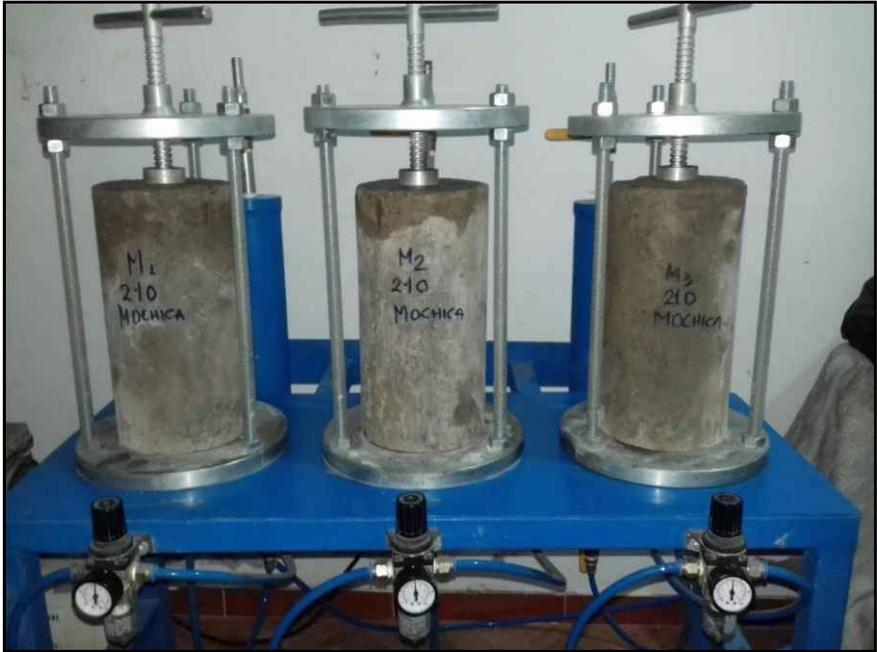
Extracción de las muestras de concreto luego de haberse ensayado por durabilidad de profundidad de penetración de agua ascendida.
