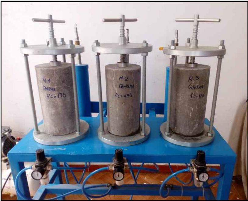
Rotura de las muestras de concreto (QHUNA  $f'c=175 \text{ kg/cm}^2$ ) similar a ensayo de tracción indirecta, posterior a ello se mide la profundidad de humedad ascendida en el interior de la probeta D=6" con un vernier digital.
