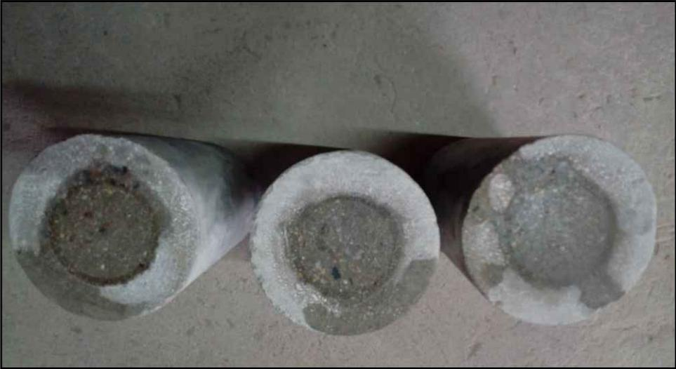
Rotura de las muestras de concreto (MOCHICA  $f'c=210 \text{ kg/cm}^2$ ) similar a ensayo de tracción indirecta.
