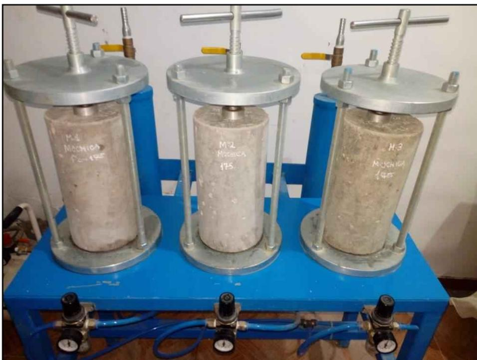
Rotura de las muestras de concreto (MOCHICA  $f'_c=175 \text{ kg/cm}^2$ ) similar a ensayo de tracción indirecta, posterior a ello se mide la profundidad de humedad ascendida en el interior de la probeta D=6" con un vernier digital.
