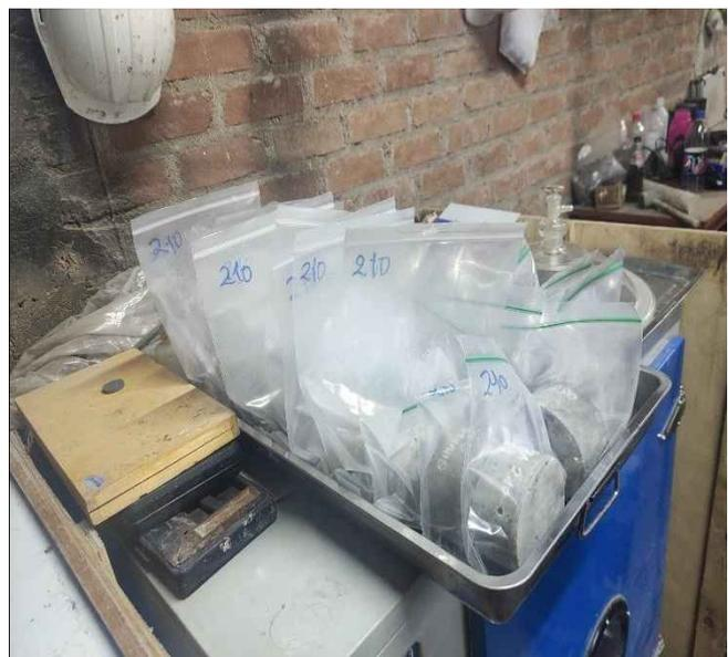
Acondicionamiento y nivelación de recipiente para muestras de concreto previo a realización de ensayo de absorción.
