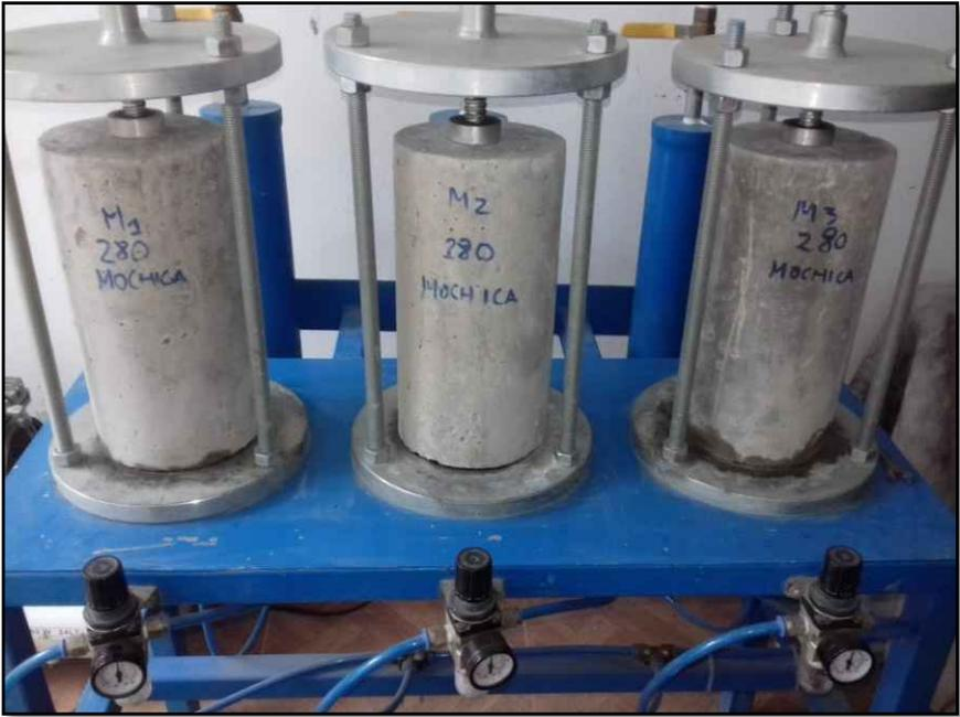
Rotura de las muestras de concreto (MOCHICA  $f'_c=280 \text{ kg/cm}^2$ ) similar a ensayo de tracción indirecta.
