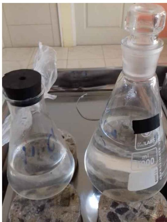
Ensayo de penetración de iones cloruro a partir de paso de corriente eléctrica, tiempo de 6 horas continuas.
