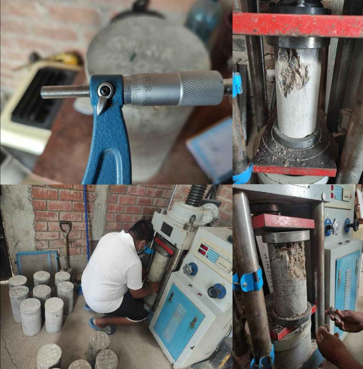
Se toman datos de los diámetros de las probetas y se procede con el ensayo de resistencia a la compresión como indica la norma N.T.P. 339.034:2015
