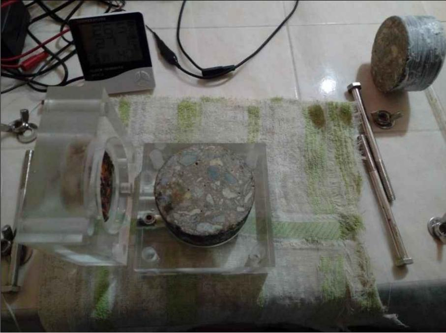
Toma de datos de la intensidad de corriente eléctrica que pasa (A) por cada muestra de concreto de D=4”.
