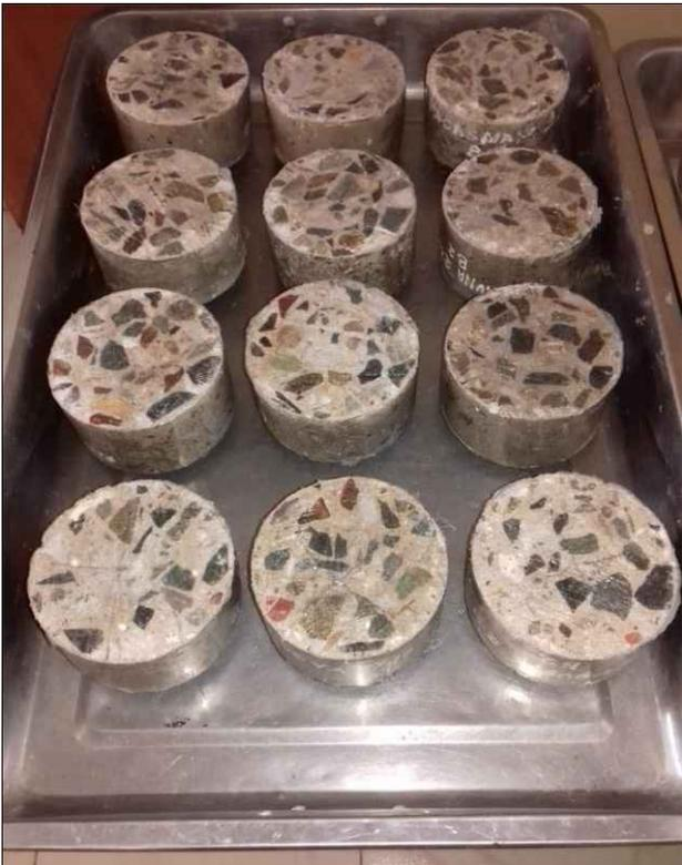
Ensayo de absorción a partir de la variación de masa para las muestras de concreto de  $f'c=280\text{kg/cm}^2$  durante un periodo de 8 días.
