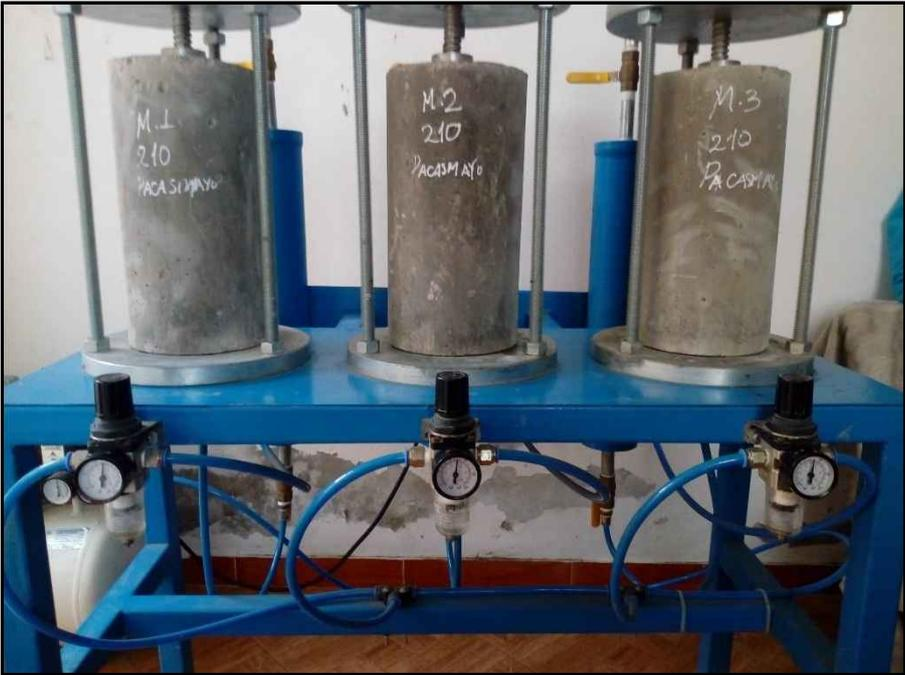
Rotura de las muestras de concreto (PACASMAYO  $f'c=210 \text{ kg/cm}^2$ ) similar a ensayo de tracción indirecta.
