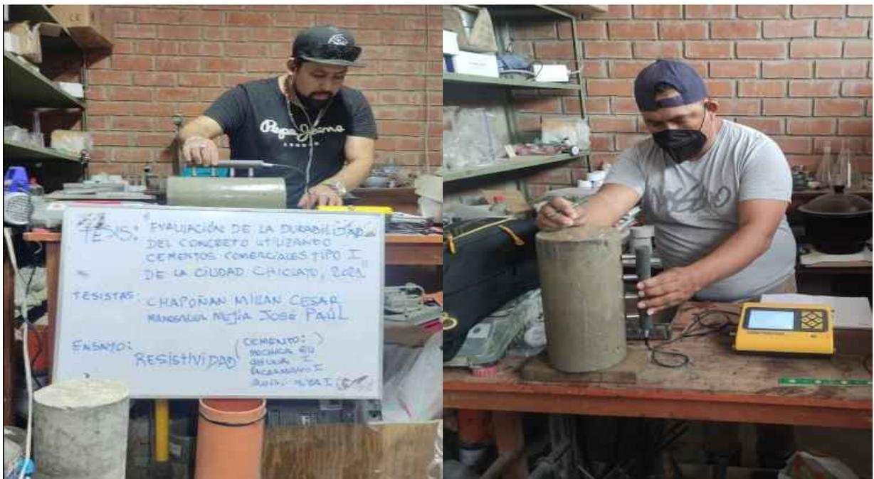
Ensayo de resistividad eléctrica con resistímetro de acuerdo a la norma UNE 83988 – 2 (método de Wenner).
