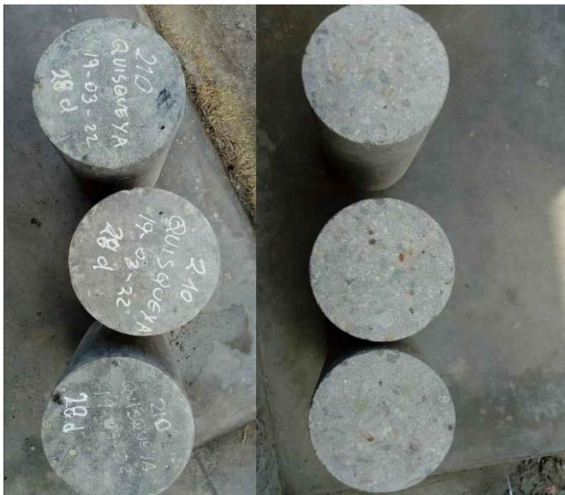
Rotura de las muestras de concreto (QUISQUEYA  $f'c=210$  kg/cm<sup>2</sup>) similar a ensayo de tracción indirecta, posterior a ello se mide la profundidad de humedad ascendida en el interior de la probeta D=6" con un vernier digital.
