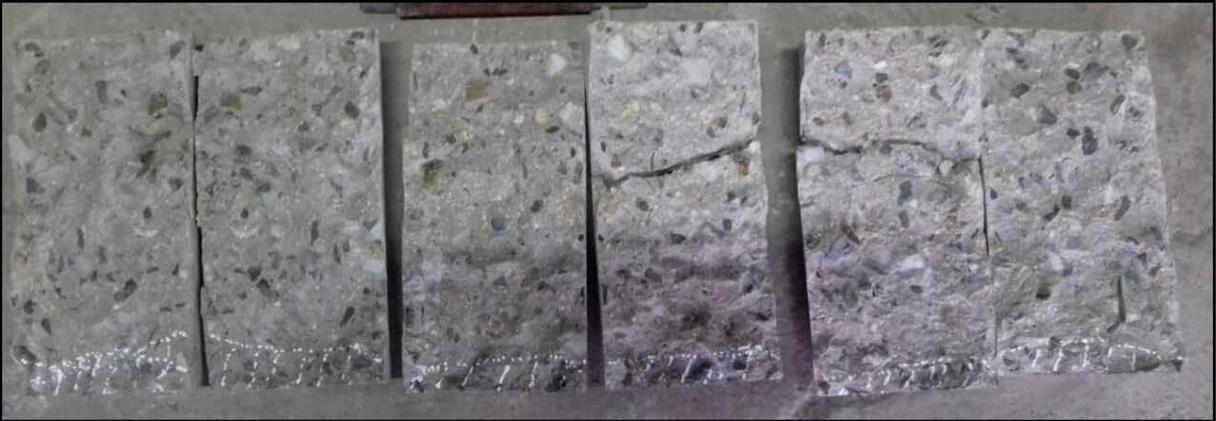
Medición de la profundidad de humedad ascendida en el interior de la probeta D=6" con un vernier digital.
