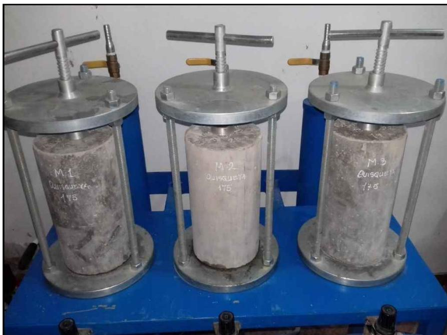
Rotura de las muestras de concreto (QUISQUEYA  $f'c=175 \text{ kg/cm}^2$ ) similar a ensayo de tracción indirecta, posterior a ello se mide la profundidad de humedad ascendida en el interior de la probeta  $D=6''$  con un vernier digital.
