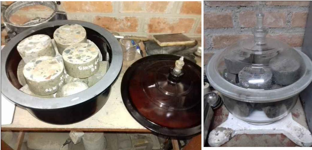
Colocación de las muestras de concreto y desecador en una estufa a T de  $50 \pm 2^\circ\text{C}$  durante un tiempo de 3 días.
