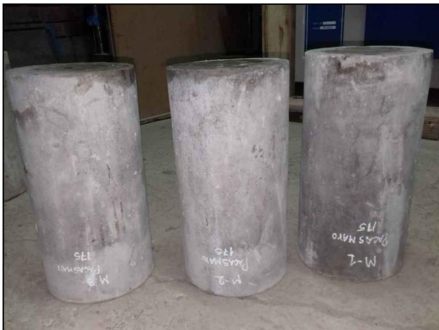
Rotura de las muestras de concreto (PACASMAYO  $f'c=175 \text{ kg/cm}^2$ ) similar a ensayo de tracción indirecta, posterior a ello se mide la profundidad de humedad ascendida en el interior de la probeta D=6" con un vernier digital.
