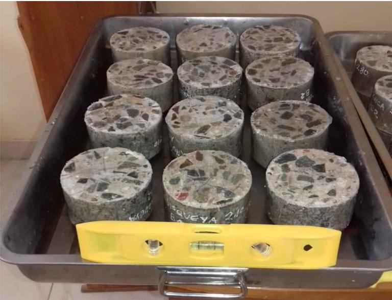
Ensayo de absorción a partir de la variación de masa para las muestras de concreto de  $f'c=210\text{kg/cm}^2$  durante un periodo de 8 días.
