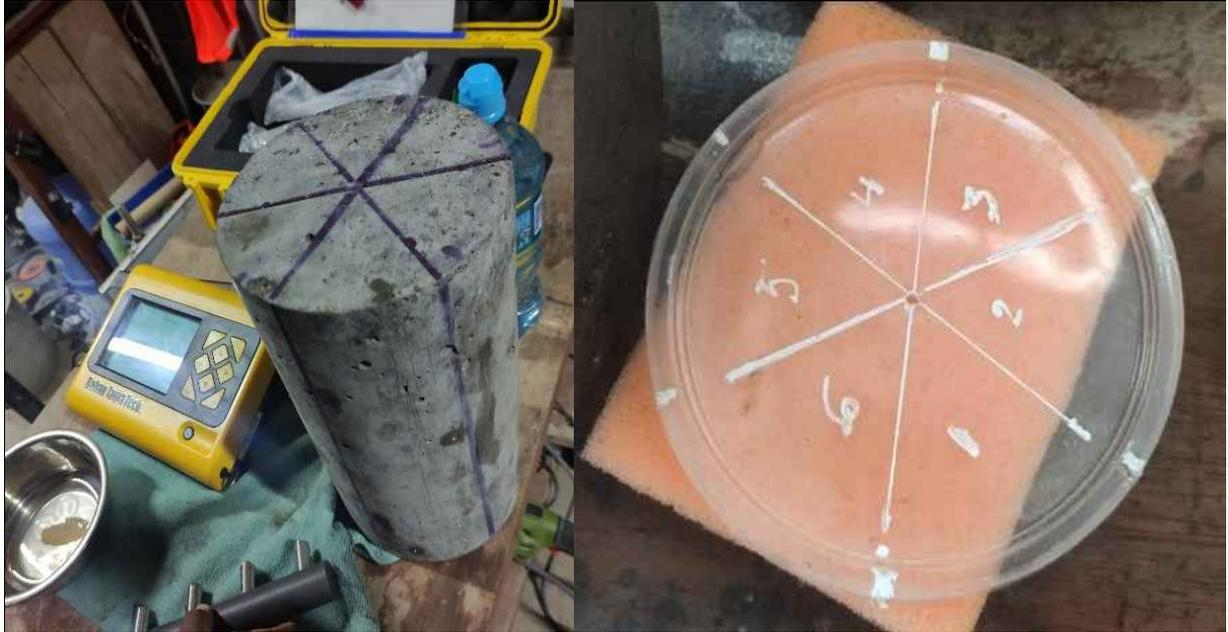
Ensayo de resistividad eléctrica (manteniendo siempre saturada la muestra y las almohadillas de los electrodos) de acuerdo a la norma UNE 83988 – 2.
