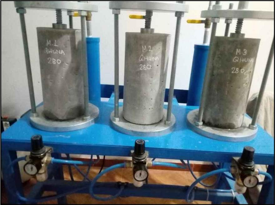
Rotura de las muestras de concreto (QHUNA  $f'_c=280 \text{ kg/cm}^2$ ) similar a ensayo de tracción indirecta.
