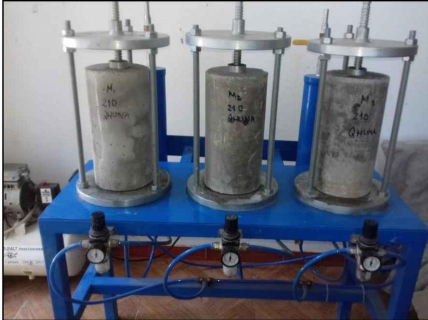
Preparación y escarificación de la terna de muestras de concreto (QHUNA  $f'c = 210 \text{ kg/cm}^2$ ).
