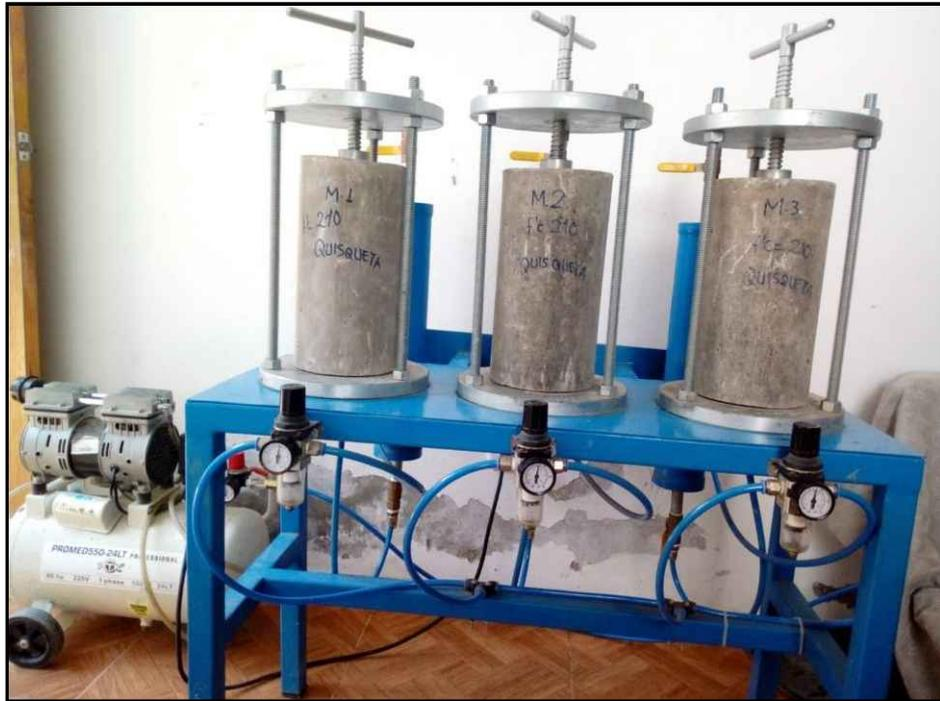
Preparación y escarificación de la terna de muestras de concreto (QHUNA  $f'c= 210$  kg/cm<sup>2</sup>).
