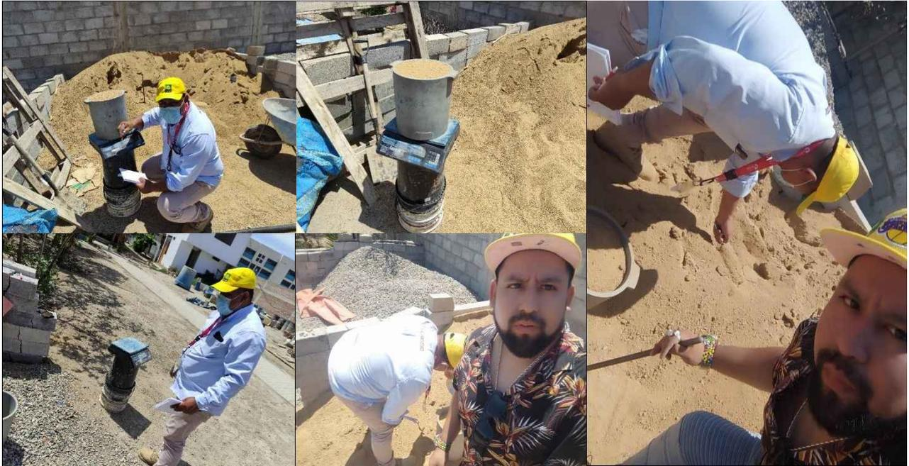
Pesado de muestras para ensayo de granulometría.
