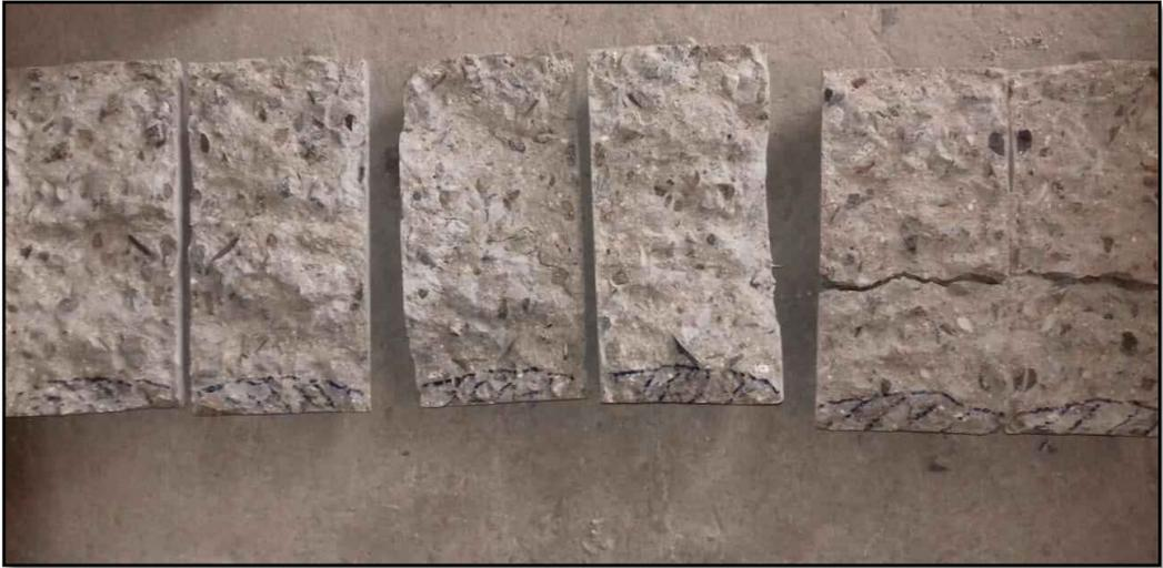
Medición de la profundidad de humedad ascendida en el interior de la probeta D=6" con un vernier digital.
