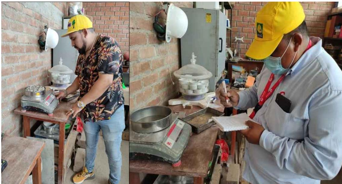
Tamizado de agregado fino y agregado grueso.
