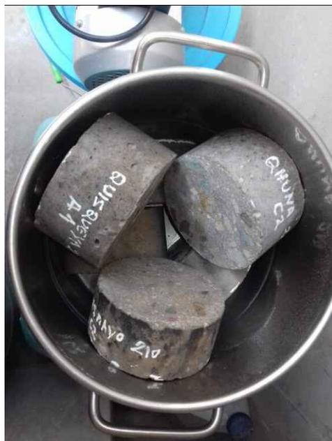
Habilitación de soluciones químicas de Hidróxido de sodio (cátodo) y Cloruro de sodio (ánodo) para el ensayo de penetración de iones de cloruro.
