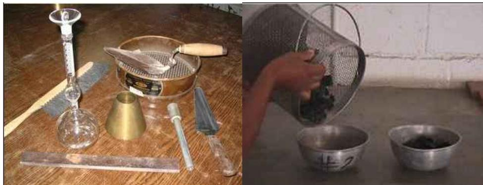
Secado superficial de muestras para proceder con el ensayo de absorción.
