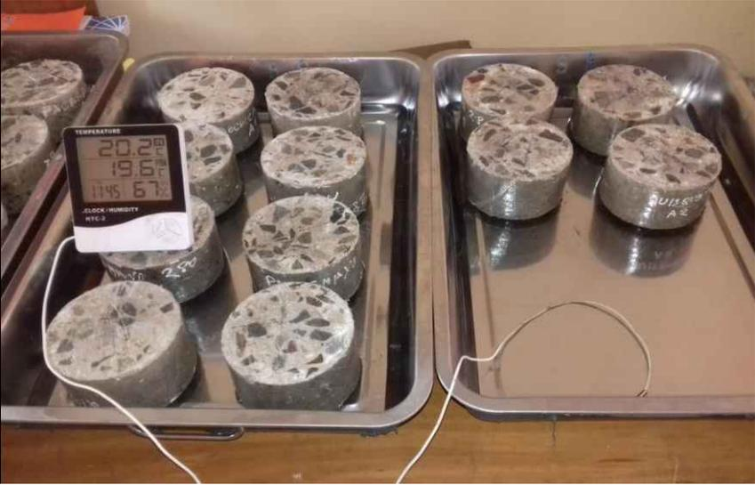
Ensayo de absorción a partir de la variación de masa para las muestras de concreto de  $f'c=175\text{kg/cm}^2$  durante un periodo de 8 días.
