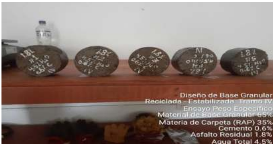
Briquetas desencofradas después de 24 horas
