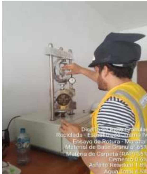
Roturas de Briquetas en Prensa Marshall
