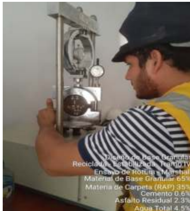
Roturas del Grupo Seco
