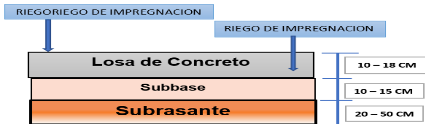
Figura 1. Dimensiones del Carpeta del pavimento rígido.
