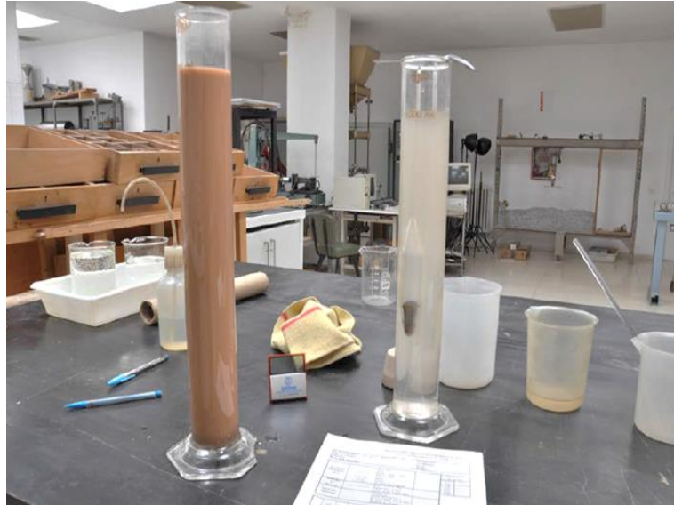
Figura 7. Probetas con muestra de suelo y agua destilada.
