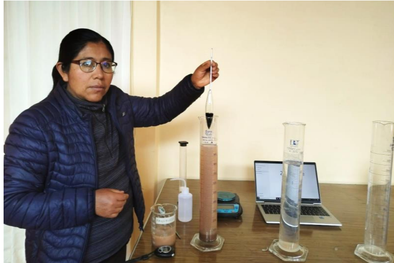
Figura 18. Registro de sólidos en suspensión con Hidrómetro.
