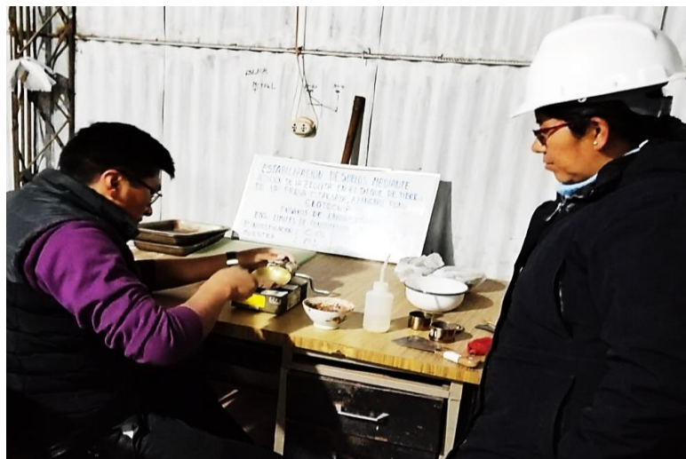
Figura 15. Ensayo de Limite Liquido, ranura en la copa de Casagrande.
