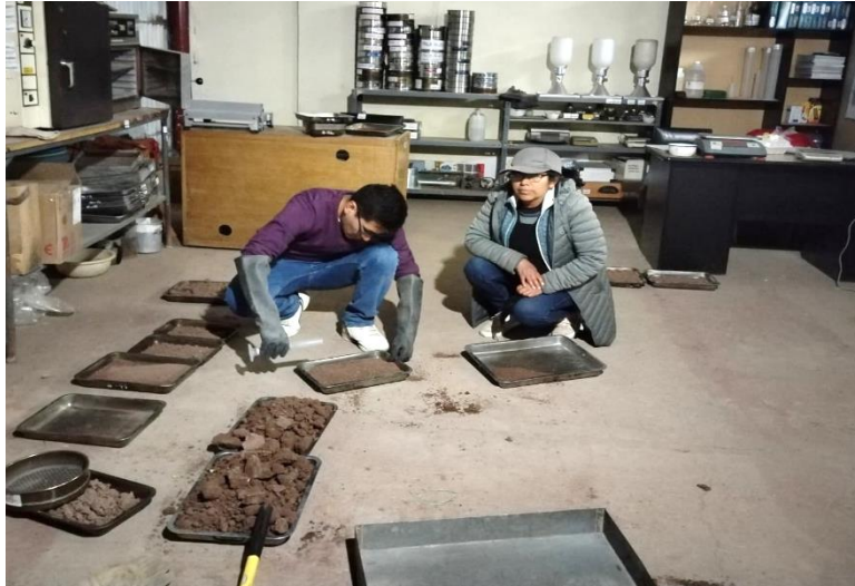
Figura 19. Ensayo de Proctor Estándar, distribución uniforme del agua en la muestra preparada.
