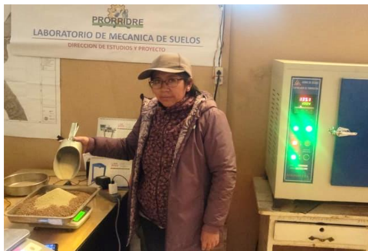
Figura 14. Dosificación del suelo y la Zeolita en peso.
