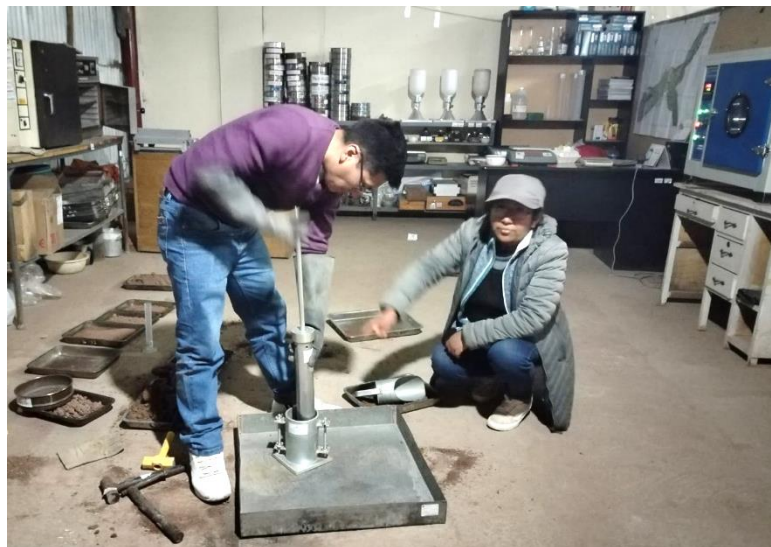
Figura 20. Compactación de la muestra a 25 golpes - Ensayo Proctor Estándar
