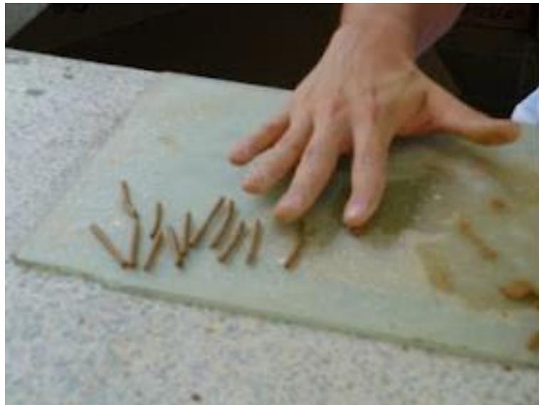
Figura 10. Cilindros de suelo de 3 mm de diámetro, ensayo de límite de plástico.
