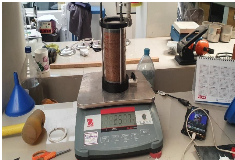
Figura 21. Cilindro con muestra compactada para el ensayo de Permeámetro de Carga Variable
