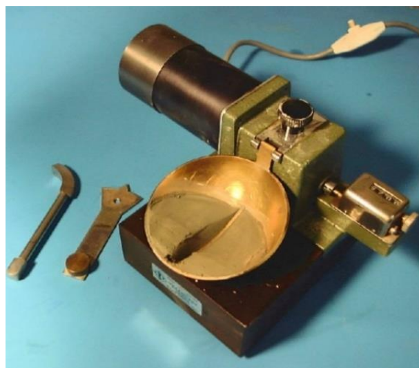
Figura 9. Ensayo de límite líquido - suelo con ranura de 2mm
