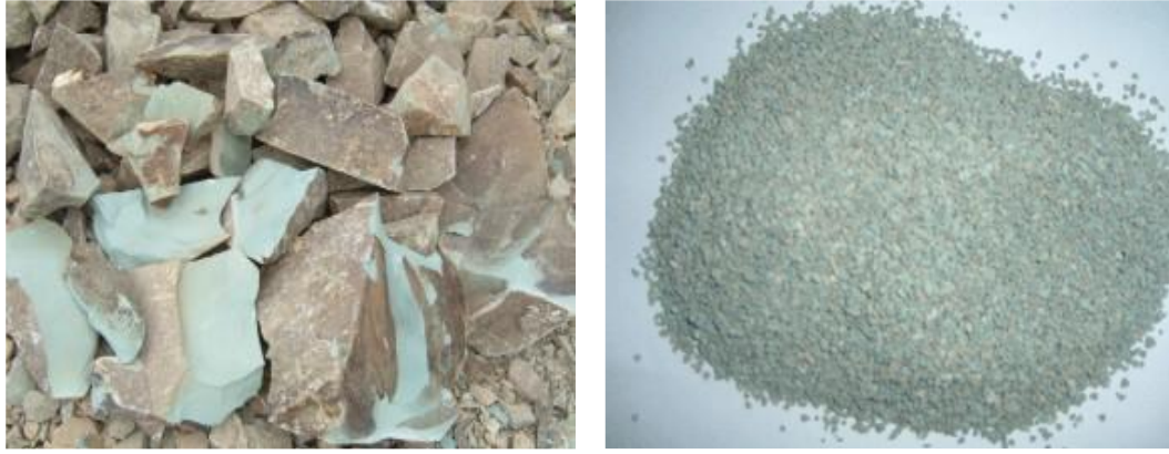
Figura 1. Zeolita en forma de piedra (a) y sometida a un proceso de trituración (b)
