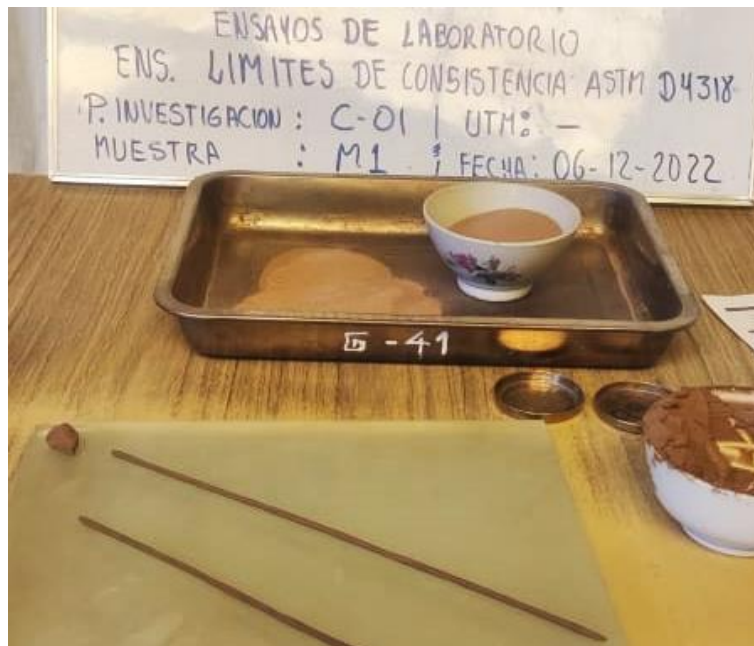
Figura 16. Cilindros de suelo con diámetros de 1/8 pulg - ensayo del Limite Plástico
