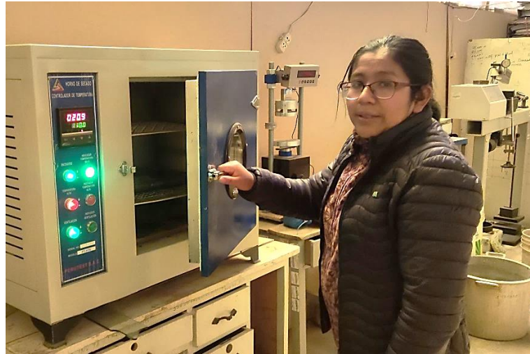
Figura 13. Horno para el secado del material suelo.
