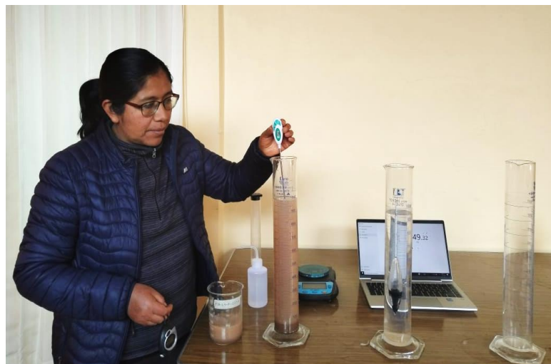
Figura 17. Ensayo del Doble Hidrómetro, registro de temperatura.
