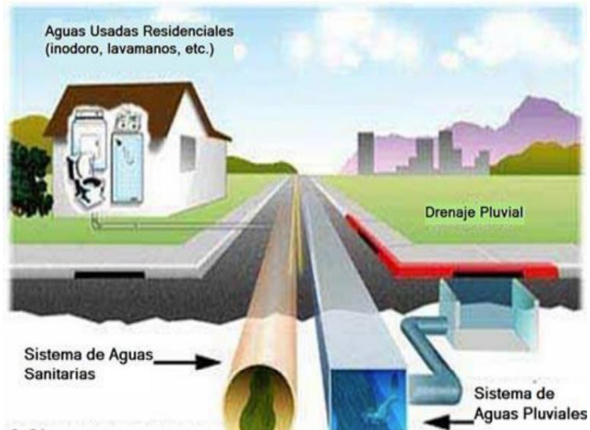
Figura 01. Sistema de Alcantarillado Convencional
