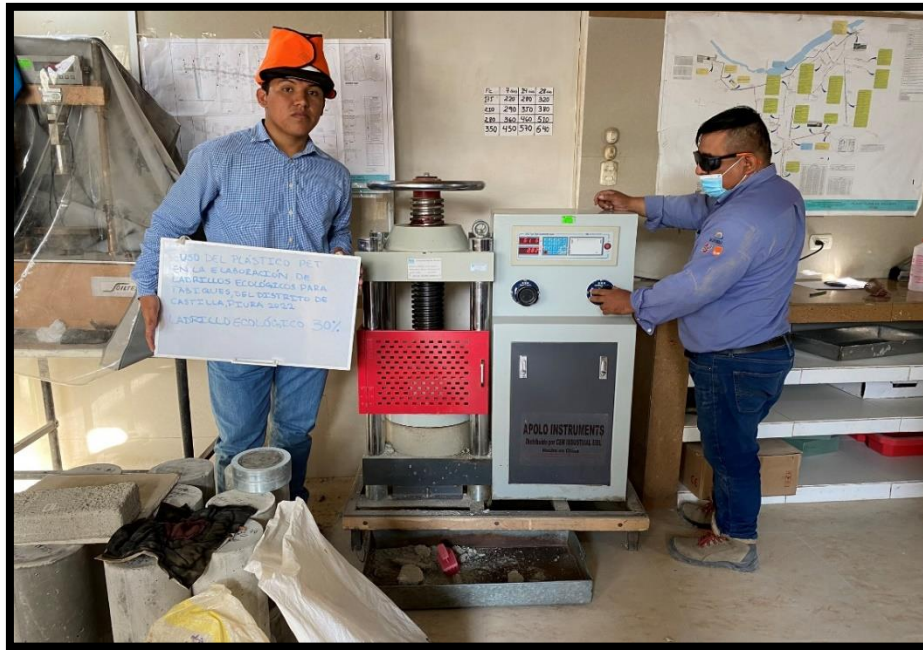
FIGURA N°15: Ensayo de resistencia a la compresión del ladrillo 30% de (PET).
