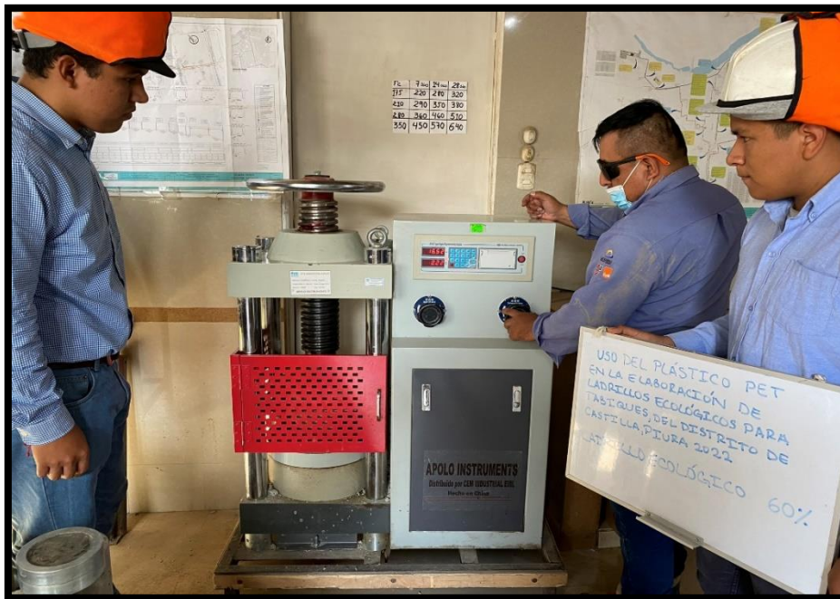
FIGURA N°13: Ensayo de resistencia a la compresión del ladrillo 60% de (PET).
