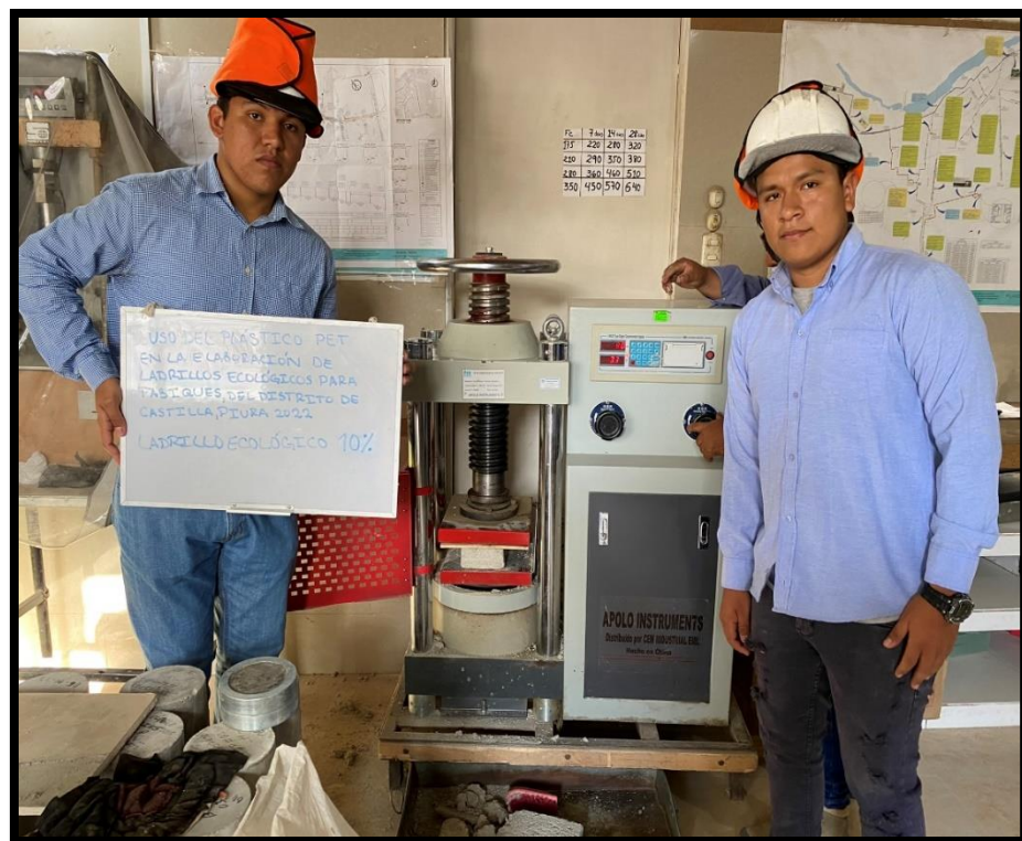
FIGURA N°14: Ensayo de resistencia a la compresión del ladrillo 10% de (PET).
