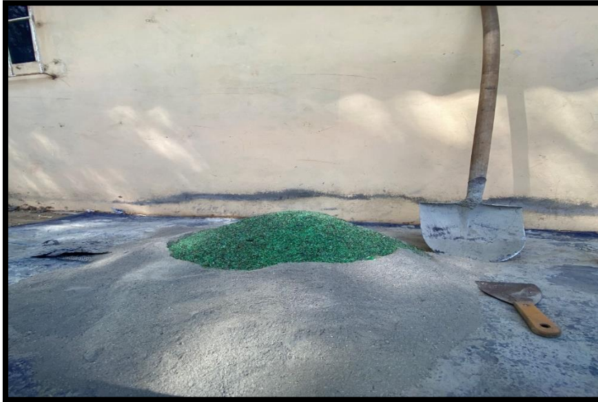
FIGURA N°03: Preparación del ladrillo ecológico con Plástico (PET).
