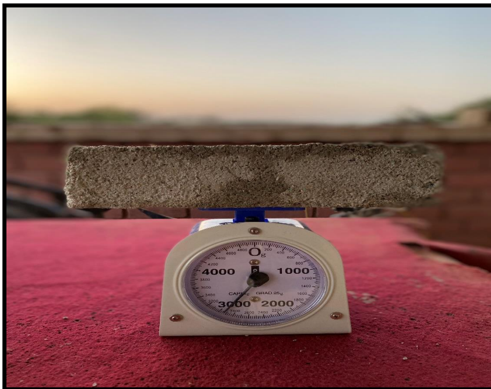
FIGURA N°20: Ensayo a la absorción de ladrillos ecológicos.
