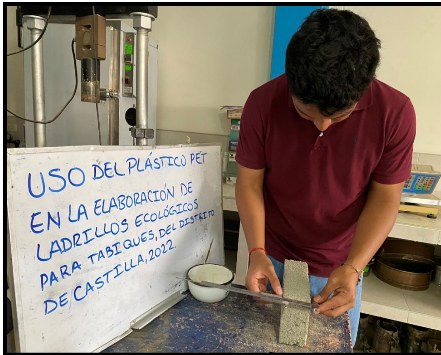
FIGURA N°22: Ensayo de alabeo en ladrillos ecológicos.
