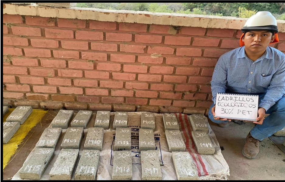
FIGURA N°11: Ladrillos ecológicos con 30% de plástico (PET) después de 14 días.
