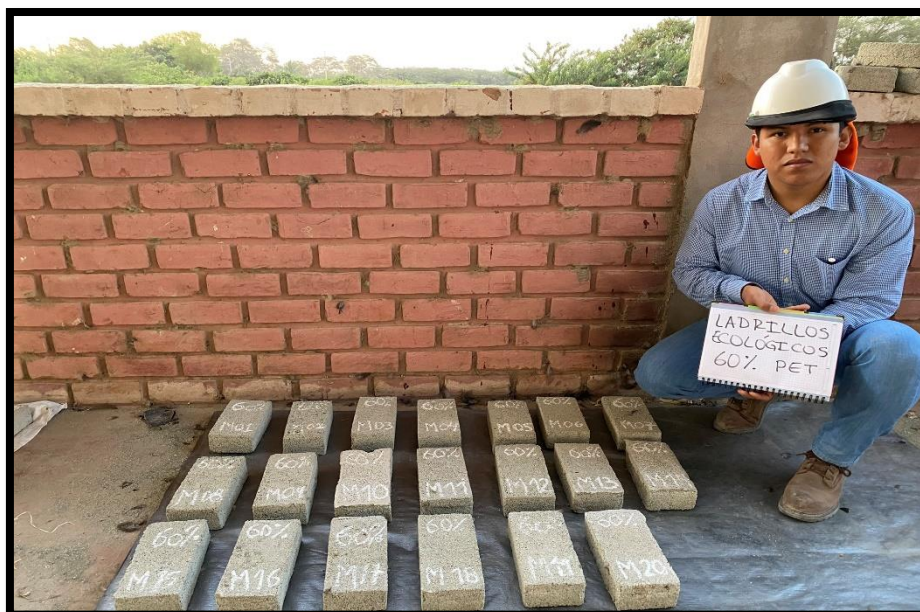
FIGURA N°12: Ladrillos ecológicos con 60% de plástico (PET) después de 14 días.
