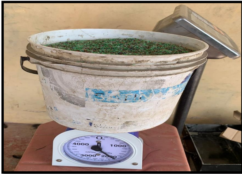
FIGURA N°01: Material plástico (PET) para el ladrillo ecológico.
