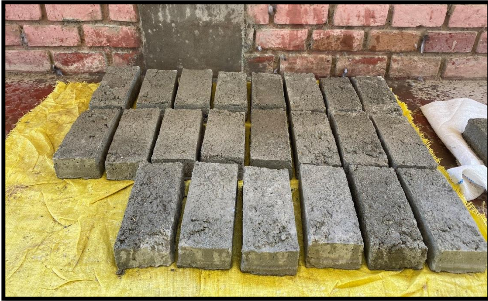
FIGURA N°09: Curado de ladrillo ecológico.
