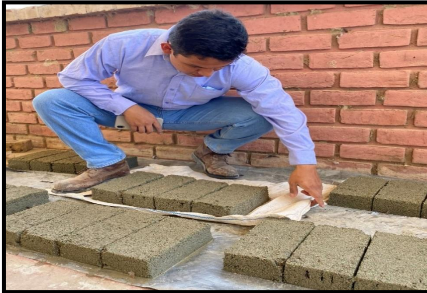
FIGURA N°07: Ladrillo ecológico elaborado con 30% de plástico (PET).
