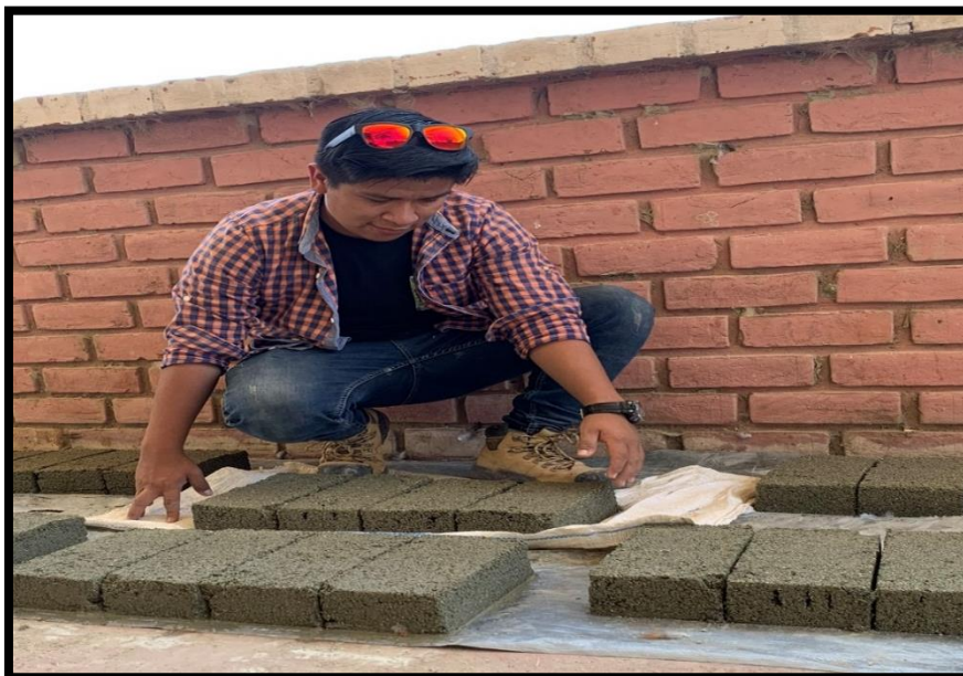
FIGURA N°08: Ladrillo ecológico elaborado con 60% de plástico (PET).
