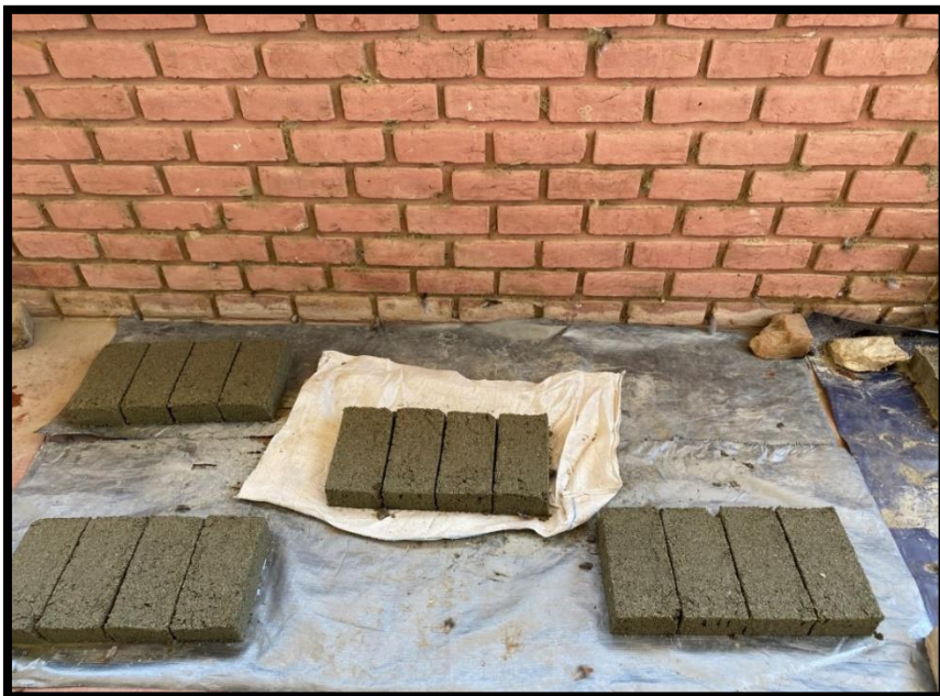
FIGURA N°06: Ladrillo ecológico elaborado con 10% de plástico (PET).
