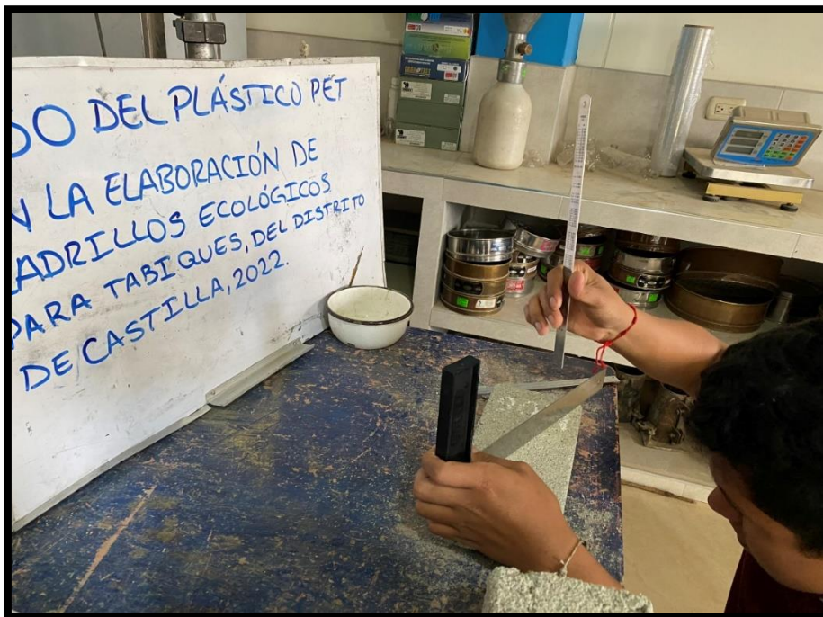
FIGURA N°24: Ensayo de alabeo en ladrillos ecológicos.
