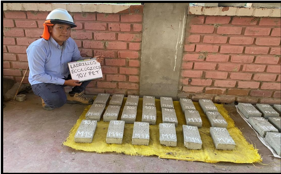
FIGURA N°10: Ladrillos ecológicos con 10% de plástico (PET) después de 14 días.
