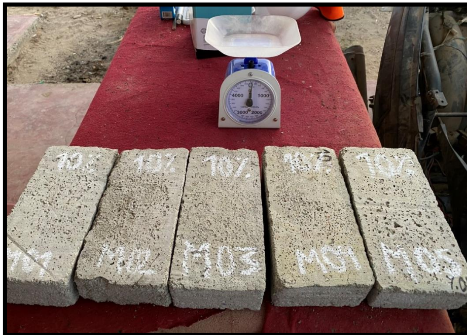
FIGURA N°16: Selección de muestras para ensayo de Absorción de ladrillos ecológicos de 10% PET.
