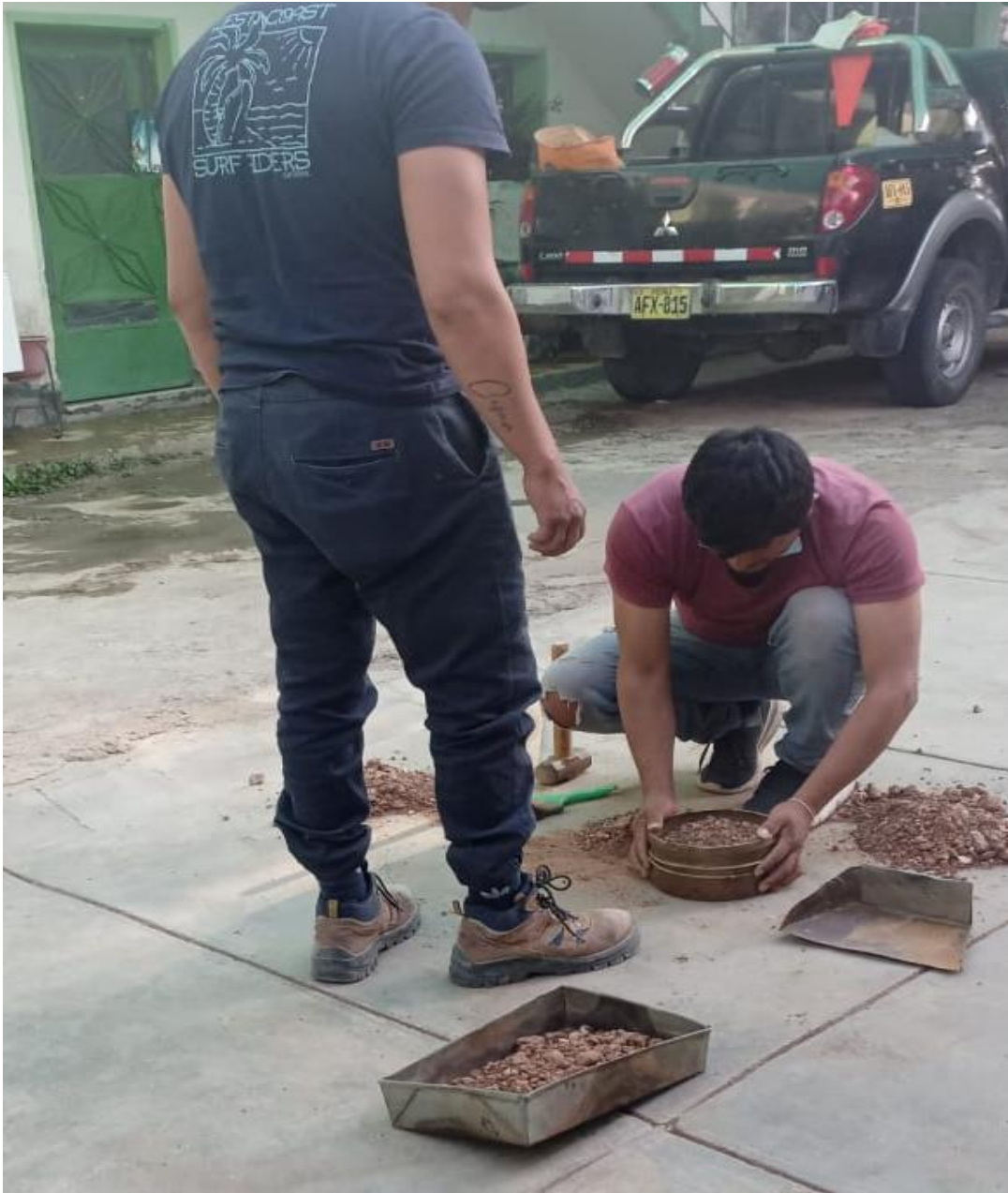
FIGURA A método del cuarteo de la muestra llevada al laboratorio
