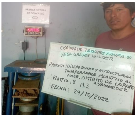
Figura 13 ensayo de resistencia a la compresión con 14 días.
