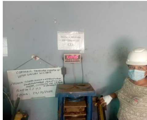
figura 14 ensayo de resistencia a la compresión incluyendo 1%, 1.5% y 2 % de plástico PET reciclado
