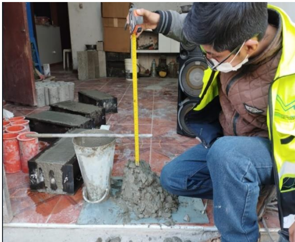
Ensayo de Slump
