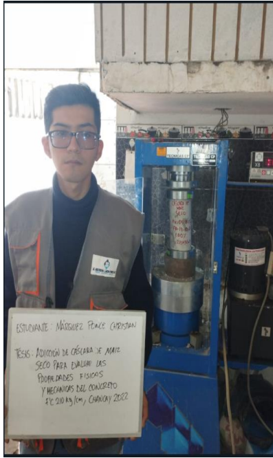
Figura 20: Rotura a los 14 días
