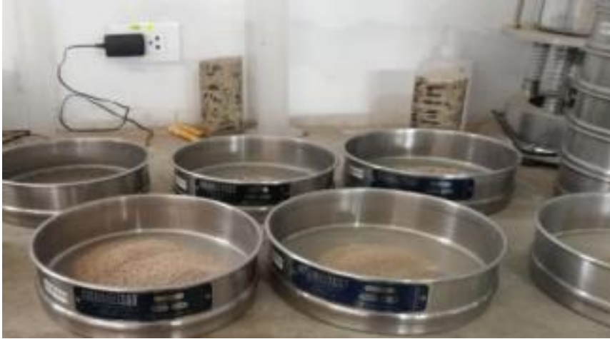
Figura 08: Granulometría agregado fino. Fuente: Elaboración propia.
