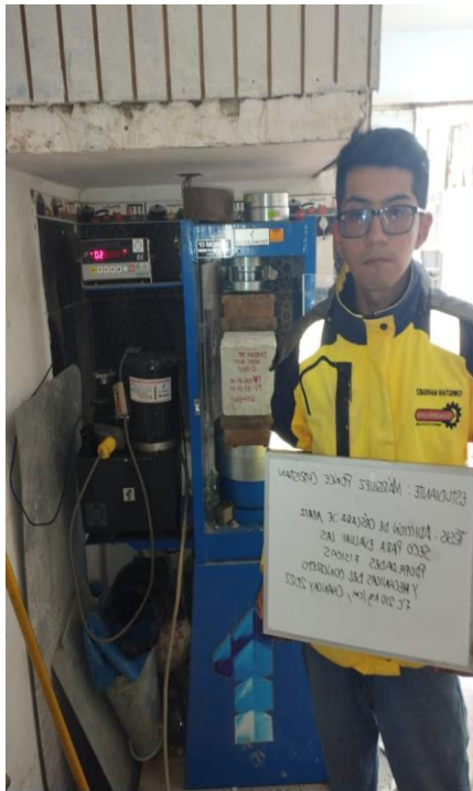
Figura 26: Ensayo a la deflexión
