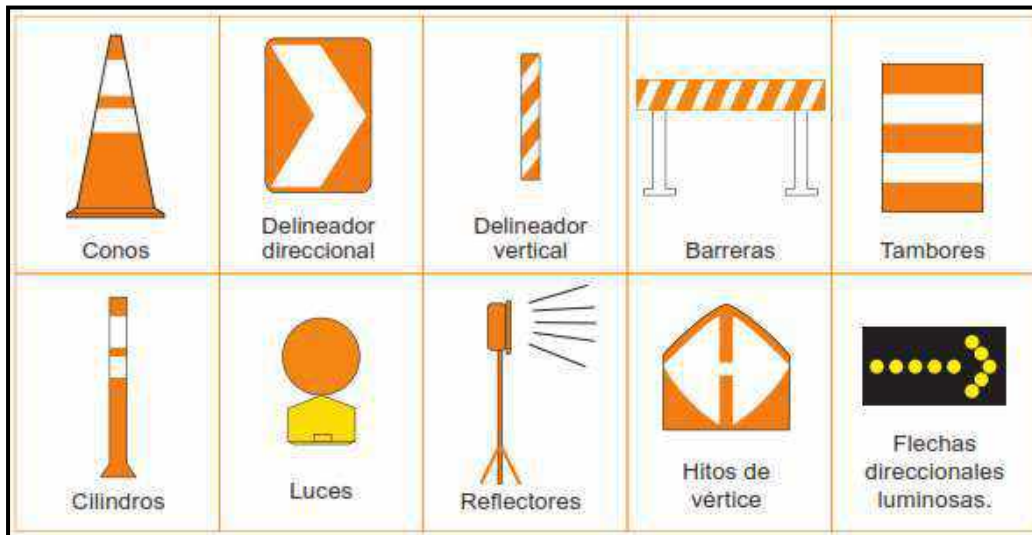
Figura 5. Elementos canalizadores de tránsito.
