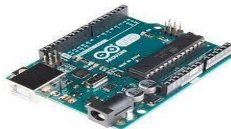
**Figura 4.** tarjeta Arduino (Santiago, 2017).
