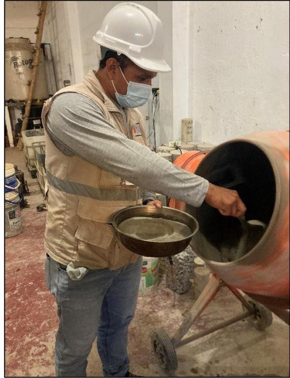
**FOTO N°15 y 16: en la imagen se muestra al autor adicionando el aditivo PET en polvo a la mezcla**
