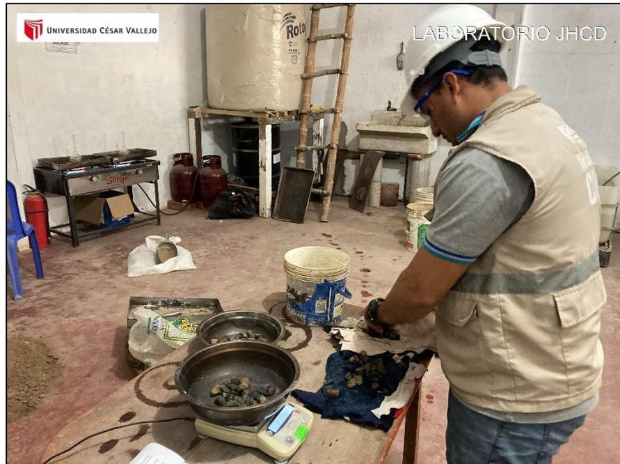
**FOTO N° 7: En la imagen se puede apreciar al autor realizando los pesos de los agregados para el análisis de peso específico del agregado grueso.**
