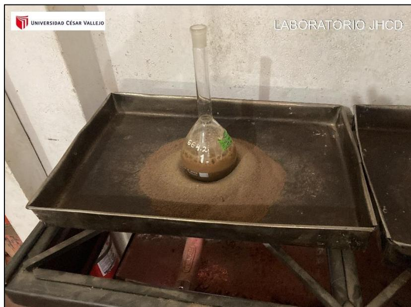
**FOTO N°9: en la imagen se muestra el análisis de peso específico y absorción**
