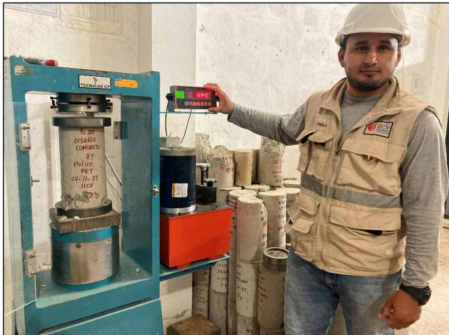
**FOTO N° 22: En la imagen se muestra al autor indicando la fuerza axial ejercida en la prensa hidráulica, mostrando el resultado de la resistencia del concreto.**
