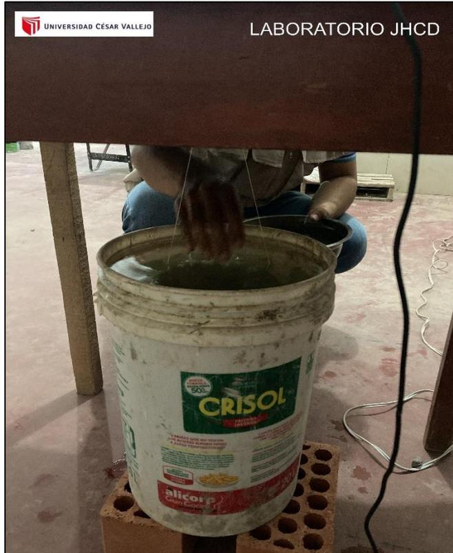
**FOTO N°8: Ensayo de peso específico**
