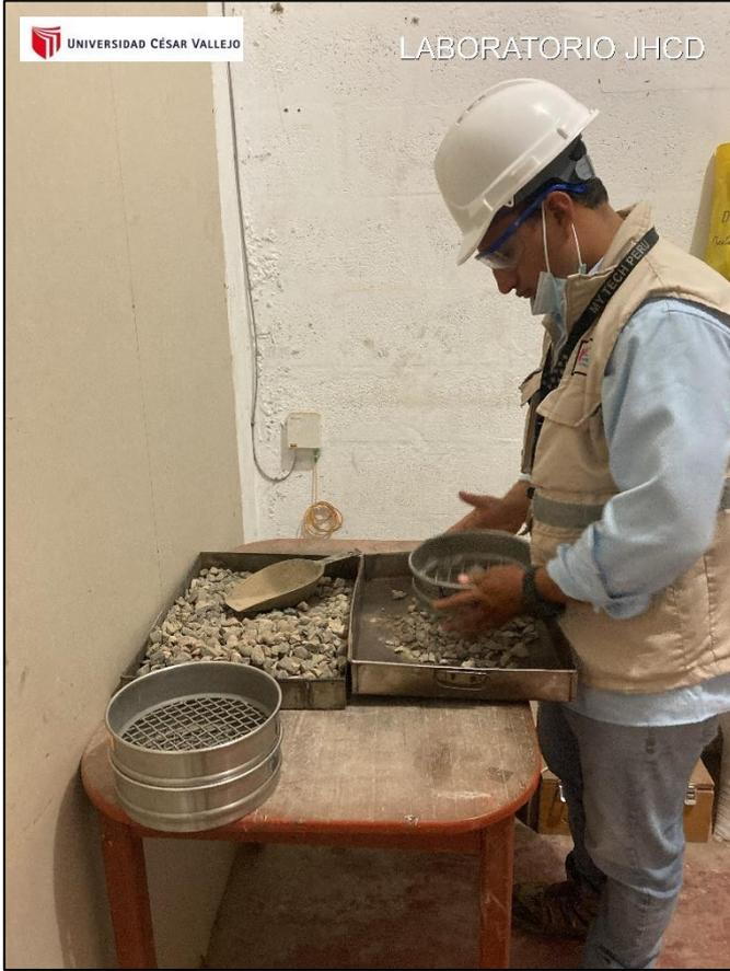
**FOTO N°6: En la imagen se aprecia al autor realizando el tamizado para el análisis de granulometría.**
