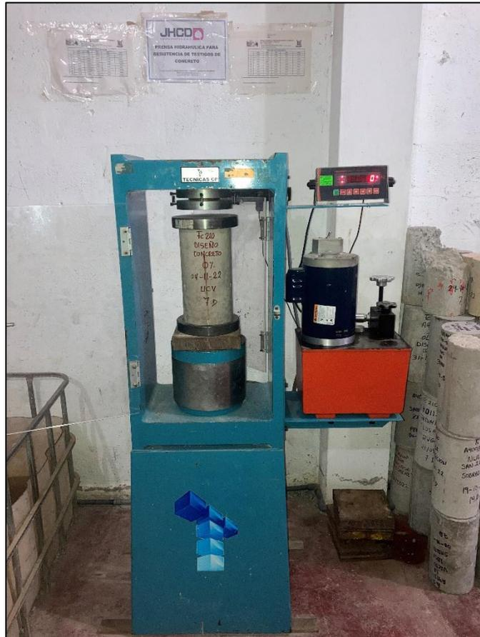
FOTO N° 21: En la imagen se muestra la prensa hidráulica
