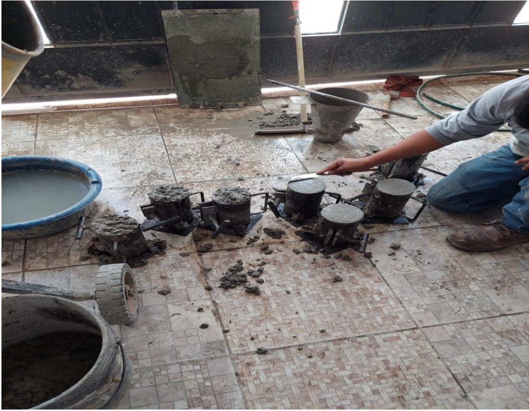
Figura 29. Vaciado de concreto en probetas.
