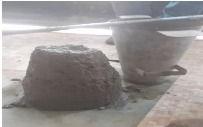
Figura 4. Ensayo de Asentamiento.
