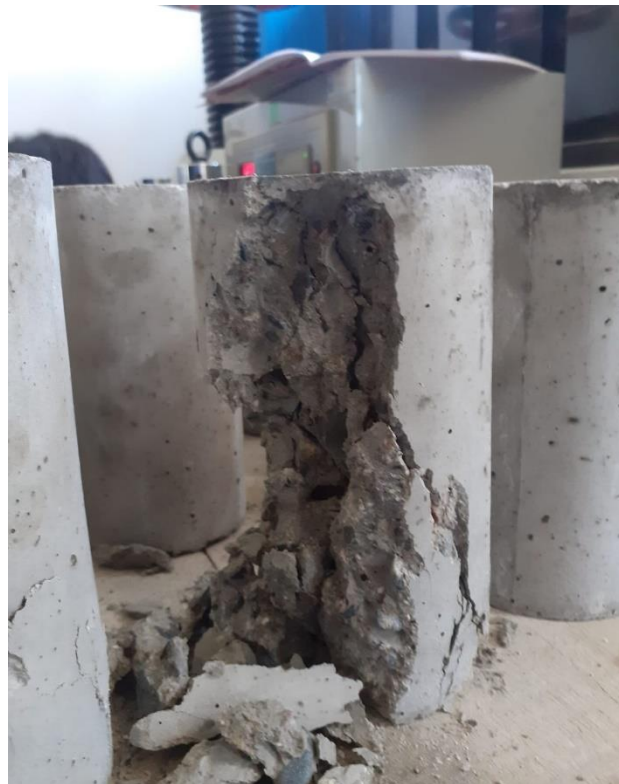
Figura 37. Falla en probeta con adición de CCA
