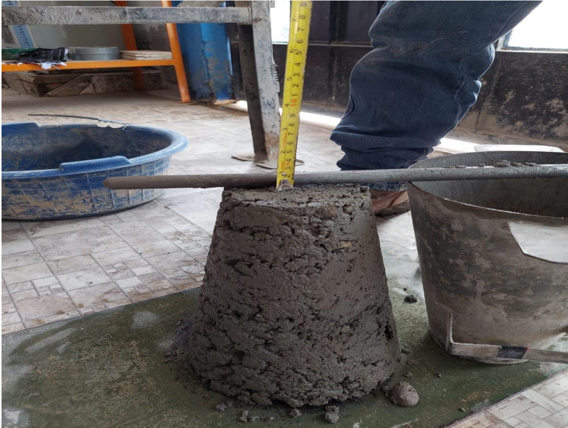
Figura 27. Prueba de asentamiento de concreto con adición de CCA.
