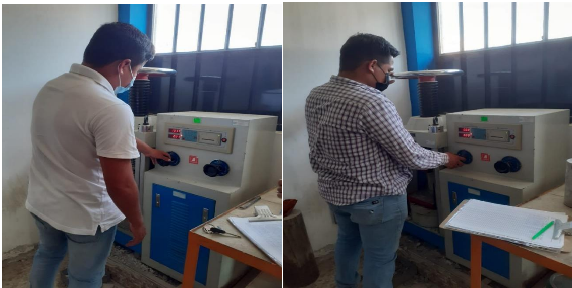
Figura 8. Ensayo a compresión de testigos.
