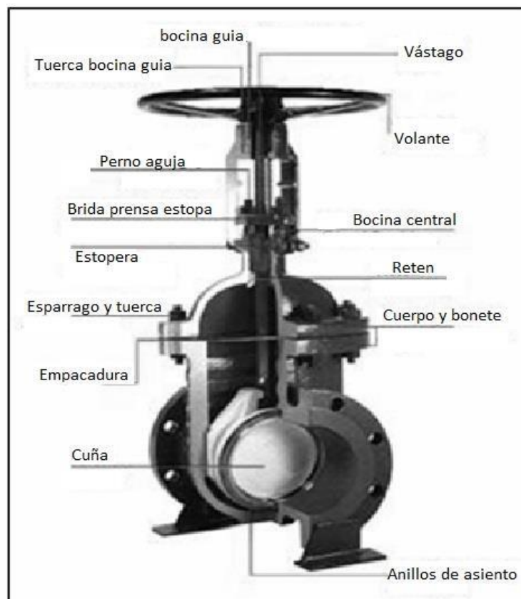
Figura 4: Válvula de Compuerta.
