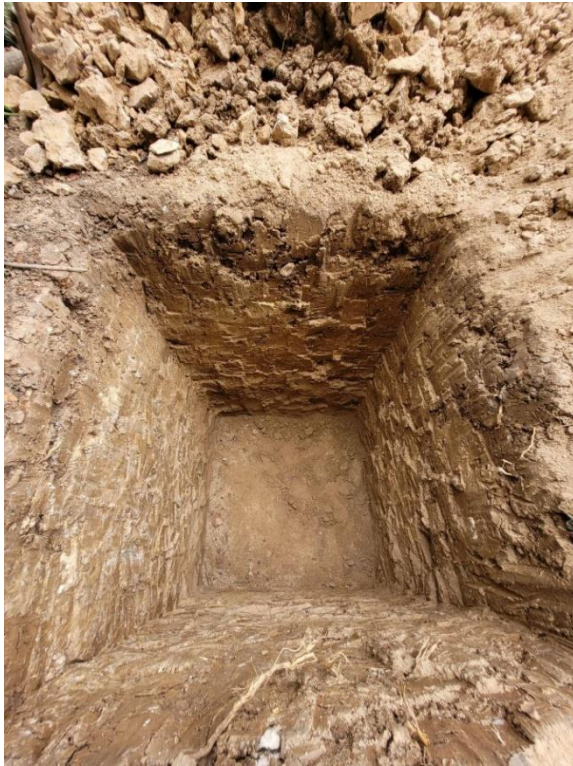
Imagen N° 10: fotografía de calicata para estudio de mecánica de suelo
