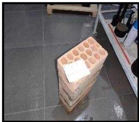
Colocación de pila de ladrillo para rotura (28 días)
