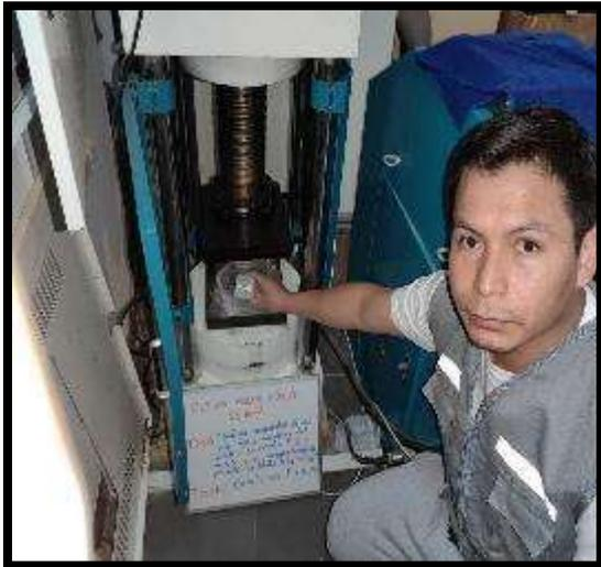
Colocación de cubo para su rotura
