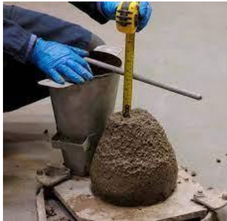
Figura 9. Trabajabilidad del concreto (Slump)
