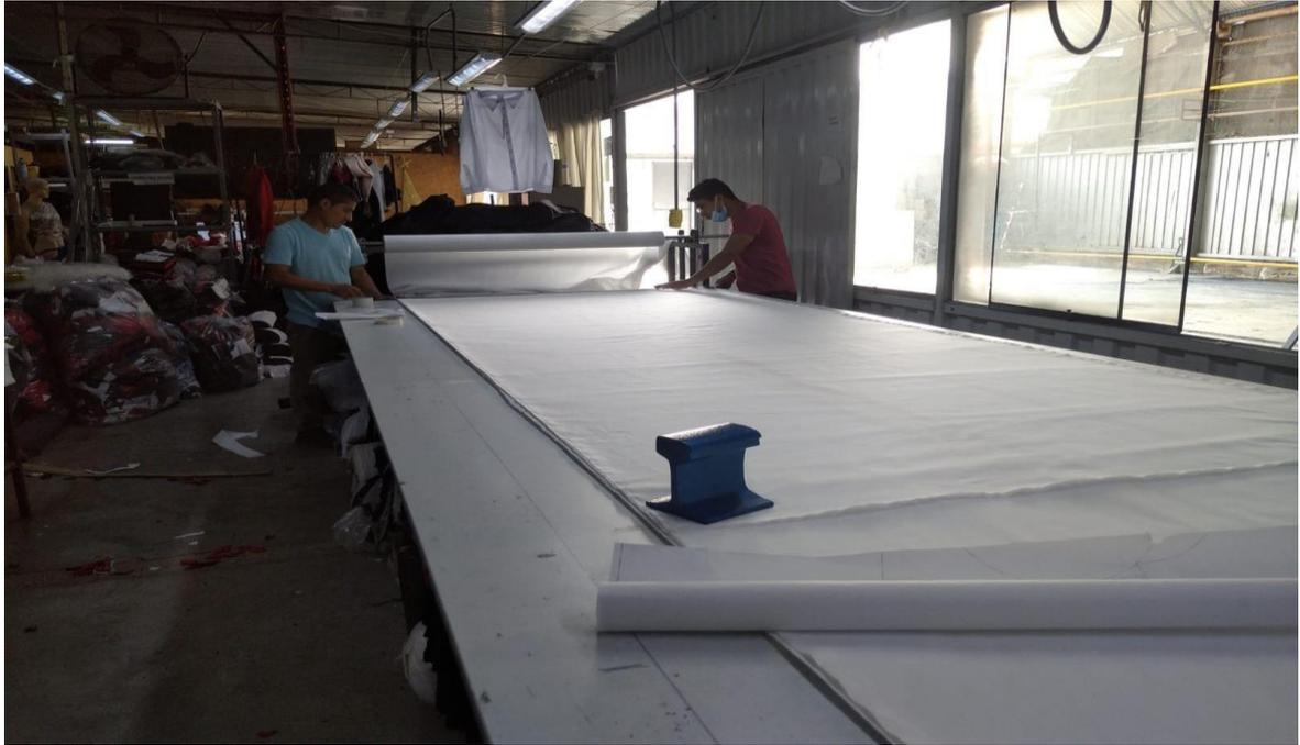
**Figura 5: Tendido de la materia prima para corte**
