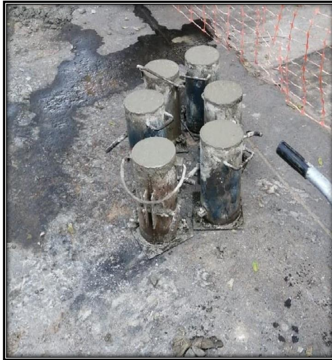
Figura 11. Elaboración de probetas de concreto simple. Fuente: El autor.
