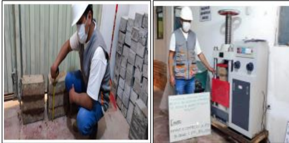
Figura 17. Resistencia a la compresión en murete de pila.
