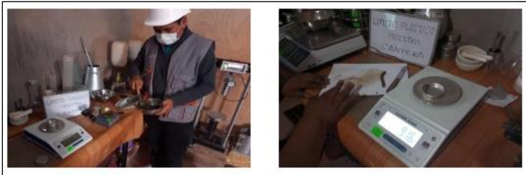
Figura 13. Obtención del límite de atterberg
