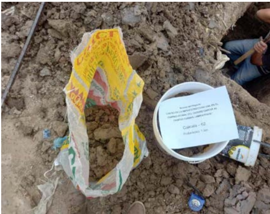
Imagen 26: Muestra de suelo extraída para ensayo de suelo.
