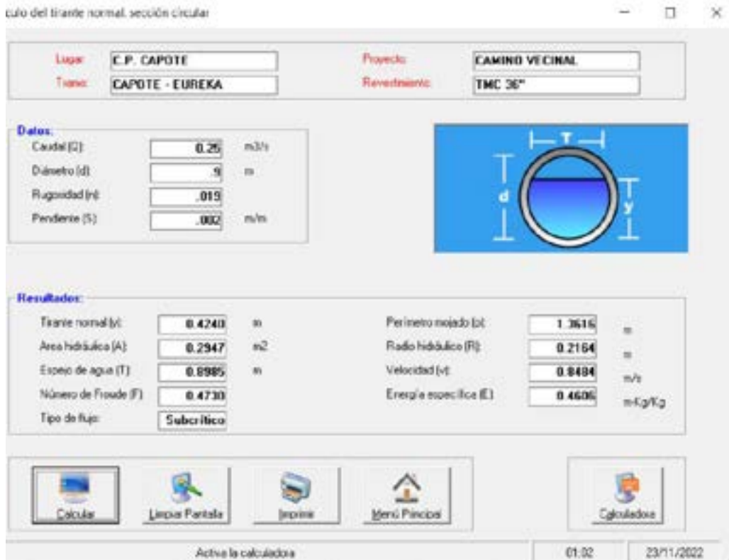
Imagen 86: Cálculo tirante normal sección Circular con pendiente 0.2%:
