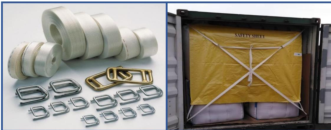
Figura 8 Flejes y hebillas de trincado de FCL.
