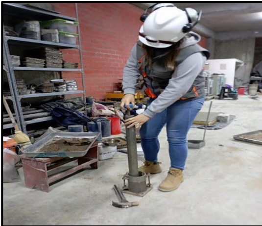
Caída de pisón (Proctor modificado)
