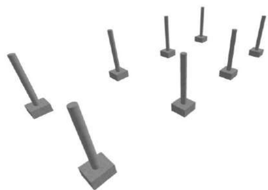
COLUMNAS DE CONCRETO ARMADO
