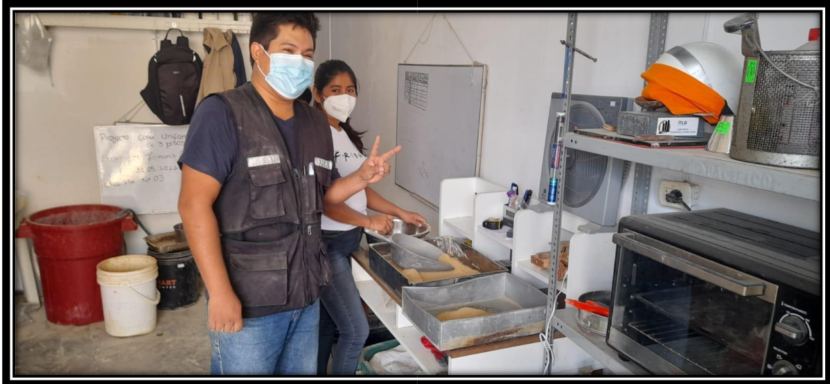
IMÁGENES 11: realización de ensayo de proctor con 6% de cal
