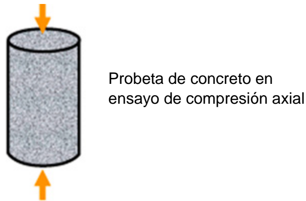
Figura 7: Probeta de concreto en ensayo de compresión axial
