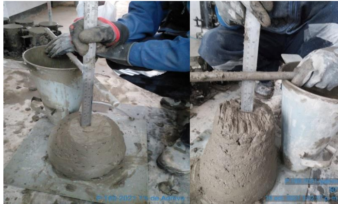
Figura 13: Medición del slump.
