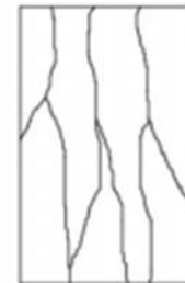
TIPO III: Cono no bien formado con grietas columnares verticales
