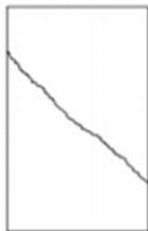
TIPO IV: Corte diagonal en ambas bases sin grieta.
