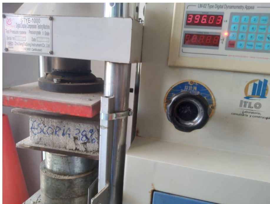
Resistencia a la compresión ladrillo con 38% de escoria
