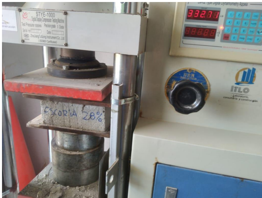
Resistencia a la compresión ladrillo con 28% de escoria
