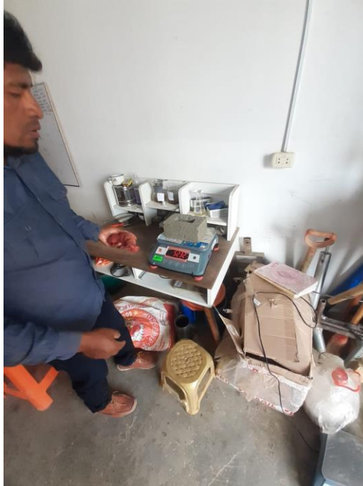
Pesado del ladrillo para el ensayo de absorción
