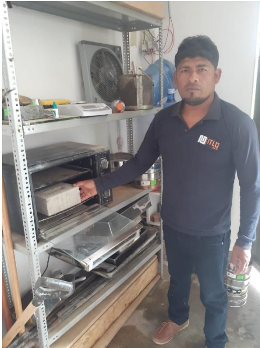
Retiro de ladrillos del horno para el ensayo de absorción
