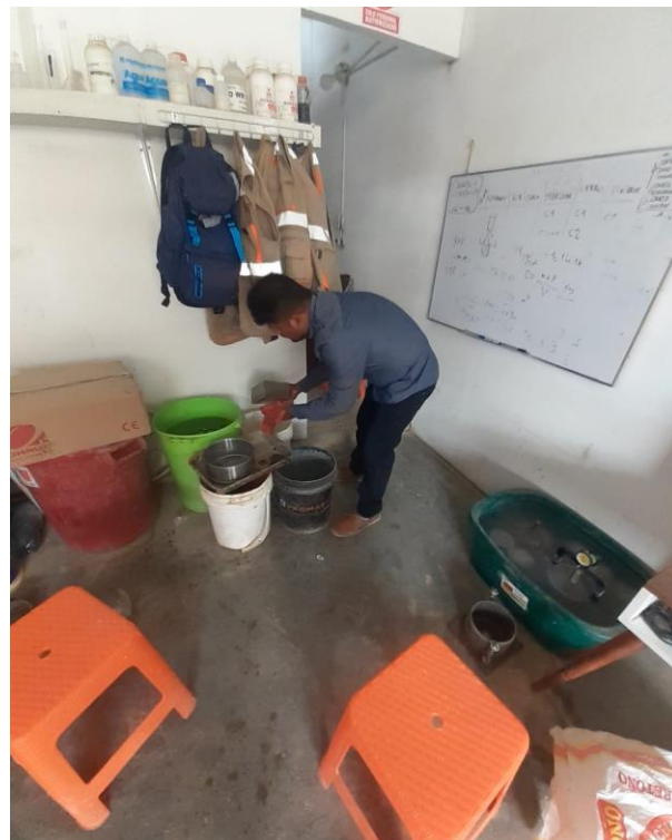
Retiro de ladrillos para el ensayo de absorción
