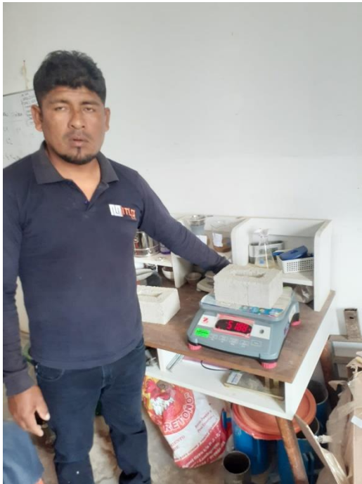
Pesaje del ladrillo para el ensayo de densidad
