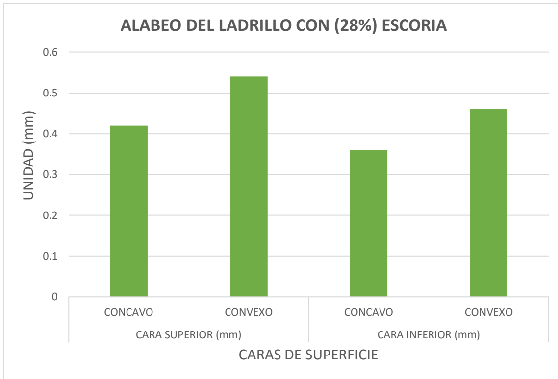
Ilustración 8 Alabeo de ladrillo con (28%) escoria
