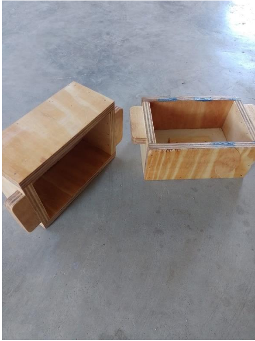
Molde para el ladrillo, 20cm largo, 13cm, ancho y 9cm de alto.
