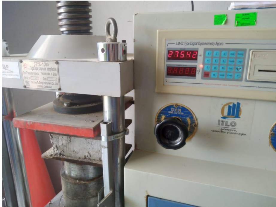
Resistencia a la compresión Ladrillo patrón 0% de escoria
