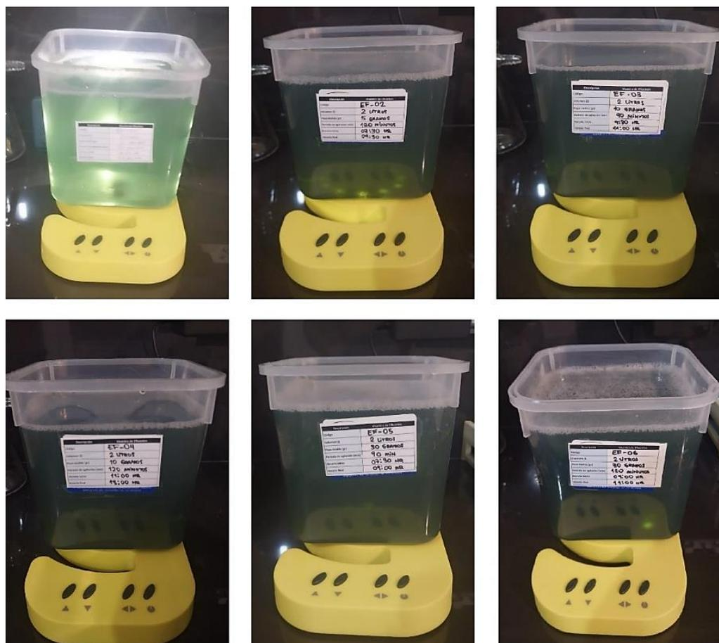
*Figura 11. Colocación de las mezclas rotuladas en los agitadores magnéticos.*
