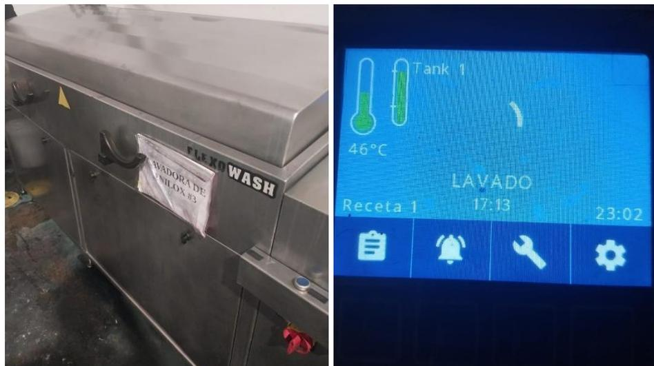
*Figura 6.* Lavadora de Anilox en proceso de lavado y secado.
