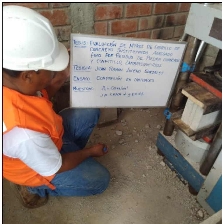
Figura 59. Ensayo de resistencia a la compresión de la unidad de albañilería ( f'_b ) a los 7 días de curado.
