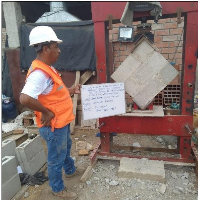
Figura 31. Resistencia a la compresión diagonal de muretes de albañilería ( V'm )
