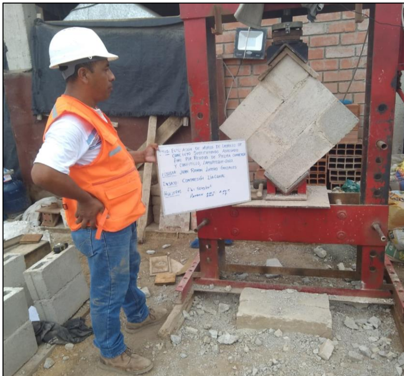
Figura 63. Ensayo de resistencia a la compresión diagonal de muretes de albañilería (V'm)
