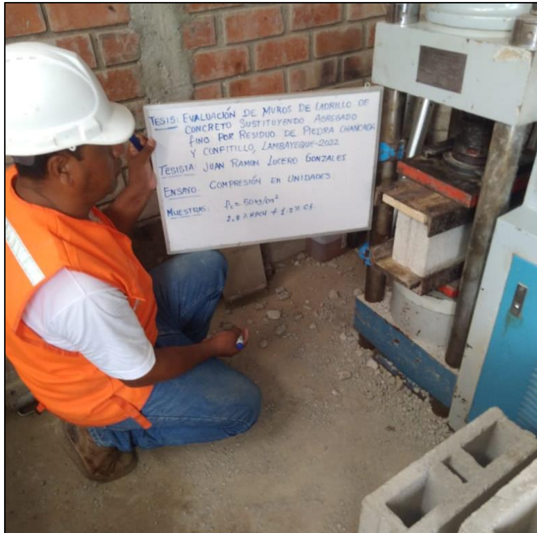
Figura 60. Ensayo de resistencia a la compresión de la unidad de albañilería (f' b) a los 14 días de curado.
