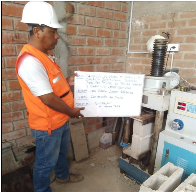
Figura 62. Ensayo de resistencia a la compresión axial de prismas de albañilería (f'm)
