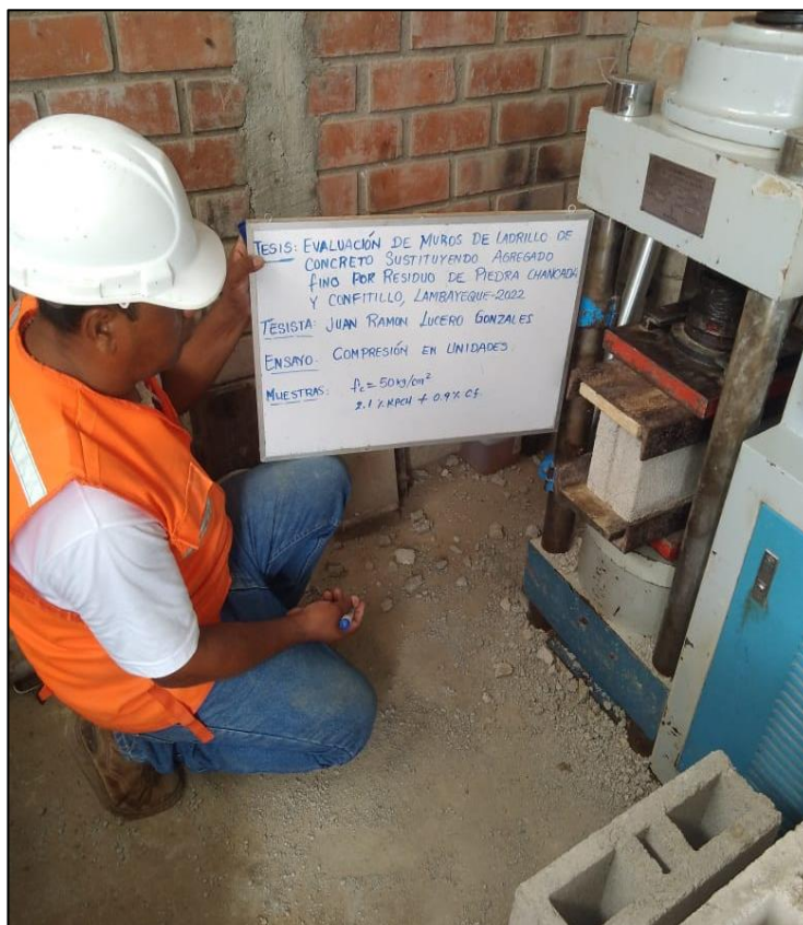
Figura 26. Resistencia a la compresión de la unidad de albañilería (f'b) a los 28 días de curado.
