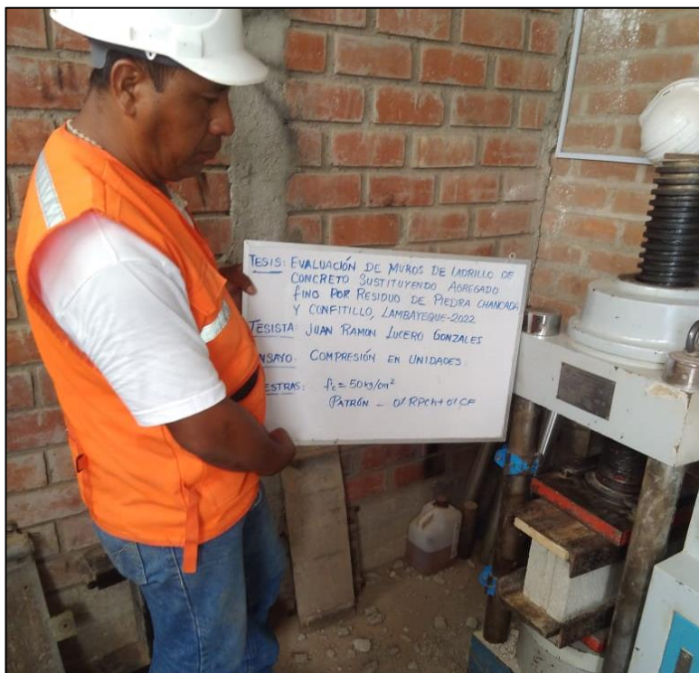
Figura 61. Ensayo de resistencia a la compresión de la unidad de albañilería (f' b) a los 28 días de curado.
