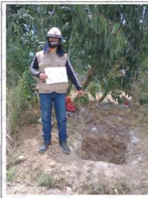
**Foto N°04:** Vista de la C-04, presencia de Arena Limosa con Grava (SM) de consistencia compacta, ligeramente húmeda y de color beige claro de 0.00 a 1.50m.
