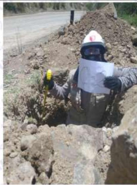
**Foto N°02:** Vista de la C-02, presencia de Limo Arenoso (ML) de consistencia compacta, húmeda y de color beige claro de 0.00 a 1.50m.
