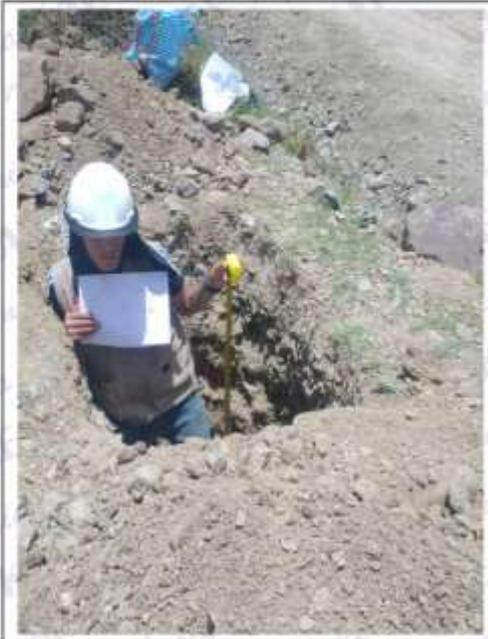
**Foto N°03:** Vista de la C-05, presencia de Arena Limosa con Grava (SM) de consistencia compacta, húmeda y de color beige claro de 0.00 a 1.50m.
