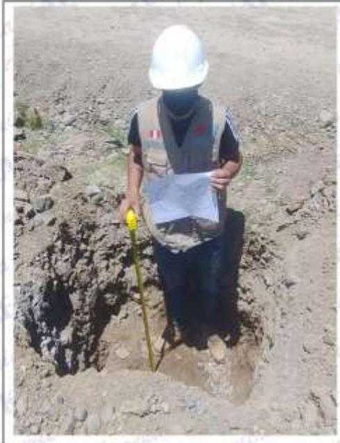
**Foto N°03:** Vista de la C-03, presencia de Grava Limosa con Arena (GM) de consistencia compacta, ligeramente húmeda y de color beige claro de 0.00 a 1.50m.
