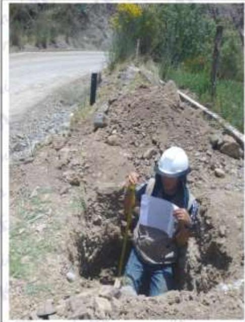
Foto N°03: Vista de la C-05, presencia de Arena Limosa con Grava (SM) de consistencia compacta, ligeramente húmeda y de color beige claro de 0.00 a 1.50m.
