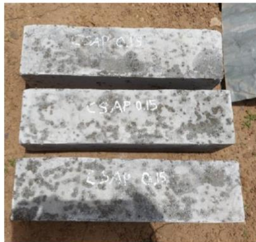
Foto N°38. Vigas de concreto con 0.15% de SAP para ser ensayados a resistencia a flexión.
