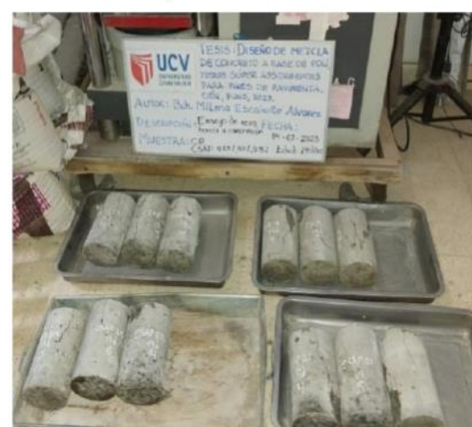
Foto N°33. Briquetas de concreto ensayados a compresión a los 14 días.
