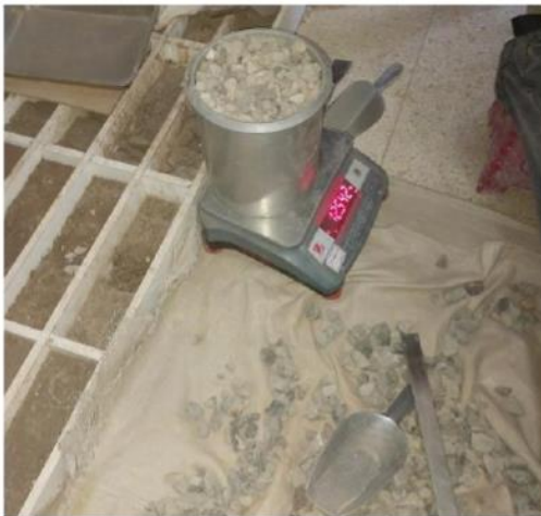
Foto N°7. Registro de peso unitario del agregado grueso.
