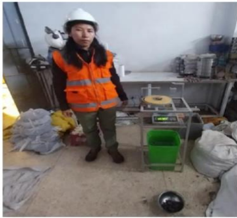
Foto N°11. Ensayo normalizado de peso específico del agregado grueso.
