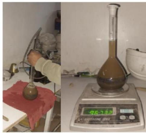
Foto N°14. Picnómetro con el agregado fino y agua, de donde se extrajo el aire atrapado mecánicamente y luego fue pesado.
