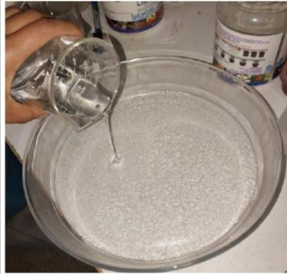
Foto N°18. Prueba de absorción de los SAP en agua potable.
