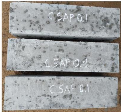
Foto N°37. Vigas de concreto con 0.10% de SAP para ser ensayados a resistencia a flexión.
