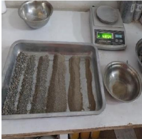
Foto N°5. Tamizado del agregado grueso para análisis granulométrico.
