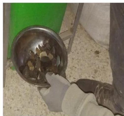
Foto N°10. Agregado grueso saturado superficialmente seco empleado para determinar su absorción.
