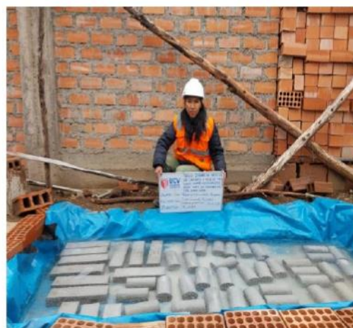
Foto N°28. Curado de probetas de estudio en poza de curado
