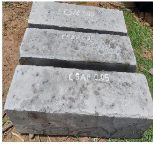
Foto N°36. Vigas de concreto con 0.05% de SAP para ser ensayados a resistencia a flexión.
