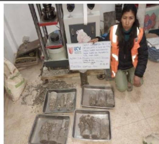
Foto N°31. Briquetas de concreto ensayados a compresión a los 7 días.
