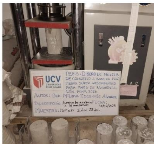
Foto N°34. Rotura de probetas de concreto a los 28 días de edad.
