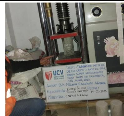
Foto N°32. Rotura de probetas de concreto a los 14 días de edad.
