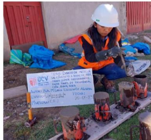
Foto N°26. Elaboración de probetas cilíndricas de concreto.
