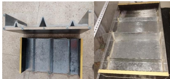
Figura 12. Moldes fabricados para las losas de concreto a ensayar.
