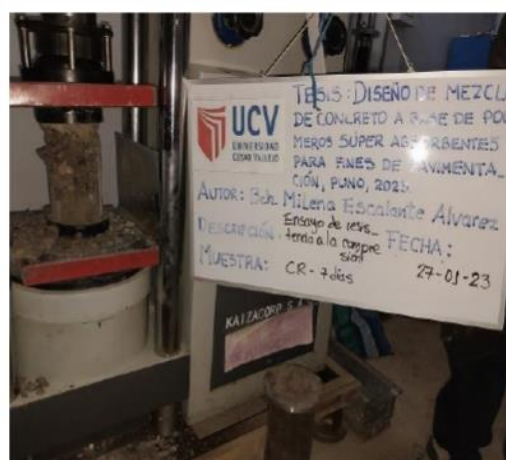
Foto N°30. Rotura de probetas de concreto a los 7 días de edad.
