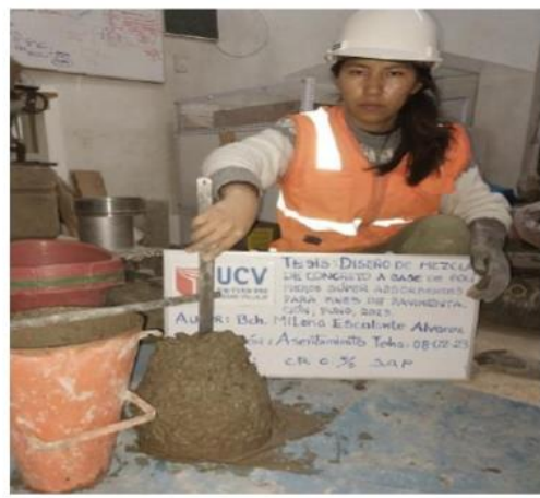
Foto N°42. Ensayo de asentamiento del concreto para los paneles del ensayo ASTM-C-1579.
