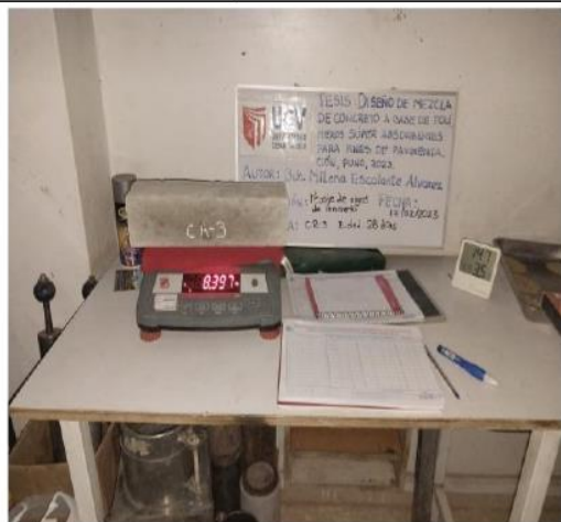
Foto N°39. Registro de medidas y peso de probetas prismáticas de concreto.
