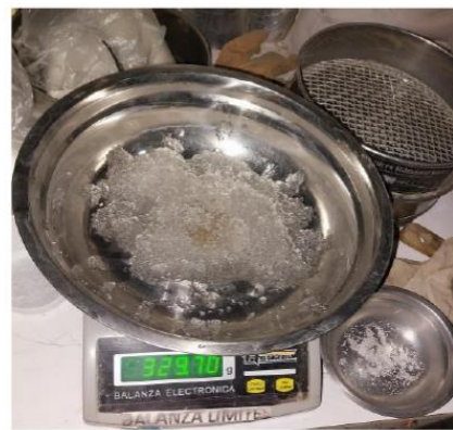
Foto N°20. Saturación de los SAP previo al mezclado de los materiales.
