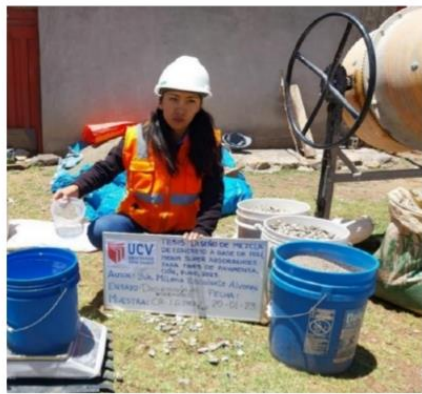
Foto N°19. Pesado de materiales para las mezclas de concreto.
