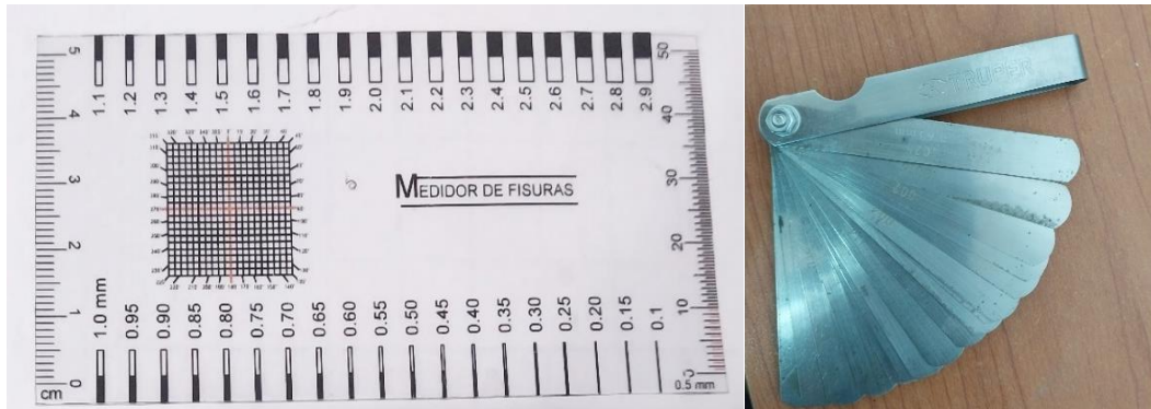
Figura 15. Herramientas para la medición de ancho de fisuras.
