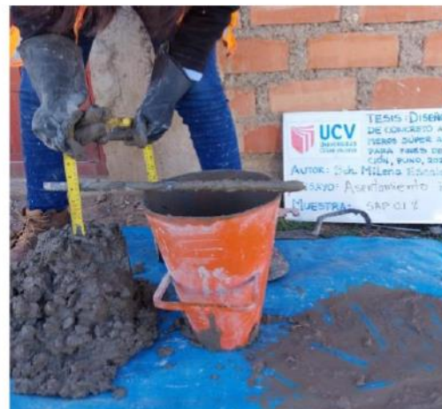
Foto N°24. Ensayo de asentamiento del concreto con 0.10% de SAP.
