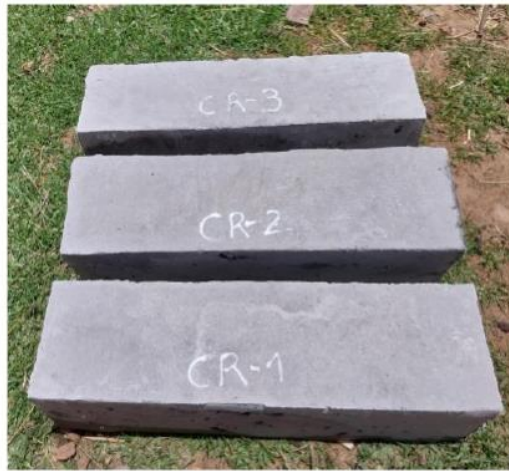
Foto N°35. Vigas de concreto de referencia para ser ensayados a resistencia a flexión.
