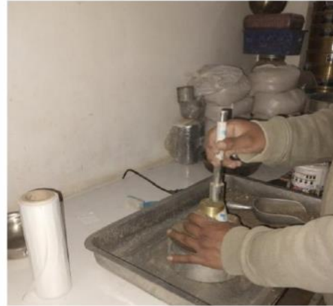
Foto N°12. Apisonado de AF en cono para asimiento de humedad superficial, en ensayo de gravedad específica y absorción.
