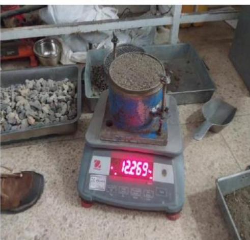
Foto N°9. Registro de peso unitario del agregado grueso.
