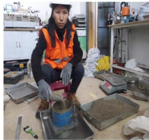
Foto N°8. Ensayo de peso unitario suelto y varillado del agregado fino.
