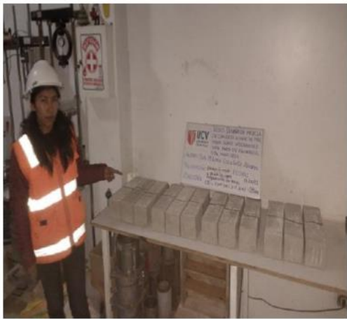
Foto N°41. Vigas de concreto después de ser ensayadas a flexión a los 28 días de edad.
