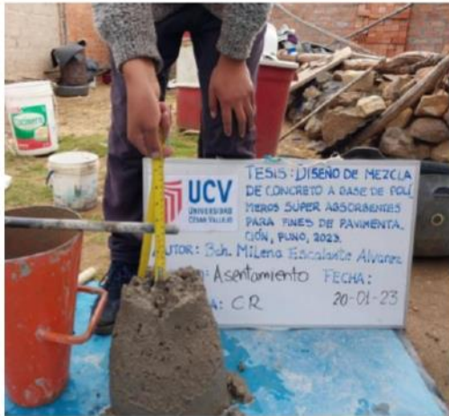
Foto N°23. Ensayo de asentamiento del concreto de referencia.
