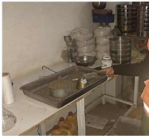
Foto N°13. Desmoronamiento del agregado fino después de retirar el cono, indicando que tiene la condición de superficie seca.
