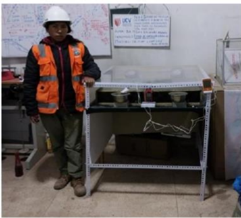
Foto N°43. Armado de cámara ambiental para el ensayo de contracción plástica del concreto.
