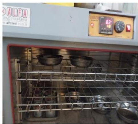
Foto N°15. Secado de agregados en horno eléctrico para determinar su contenido de humedad.
