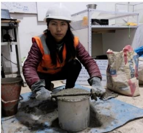
Foto N°25. Enrasado de recipiente con concreto fresco en el ensayo de peso unitario.
