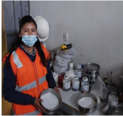
Foto N°17. Tamizado de polímeros super absorbentes.
