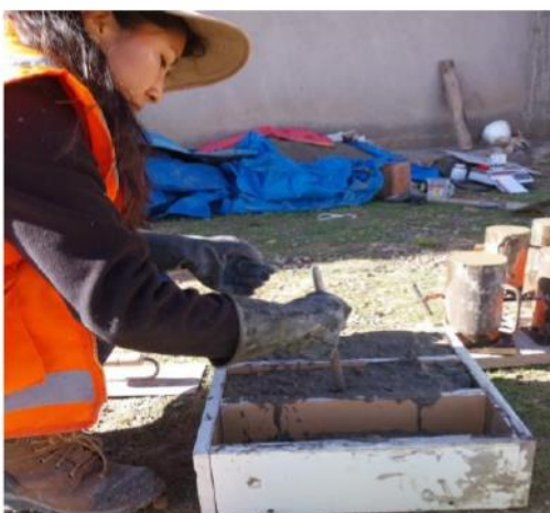
Foto N°27. Elaboración de probetas prismáticas de concreto.
