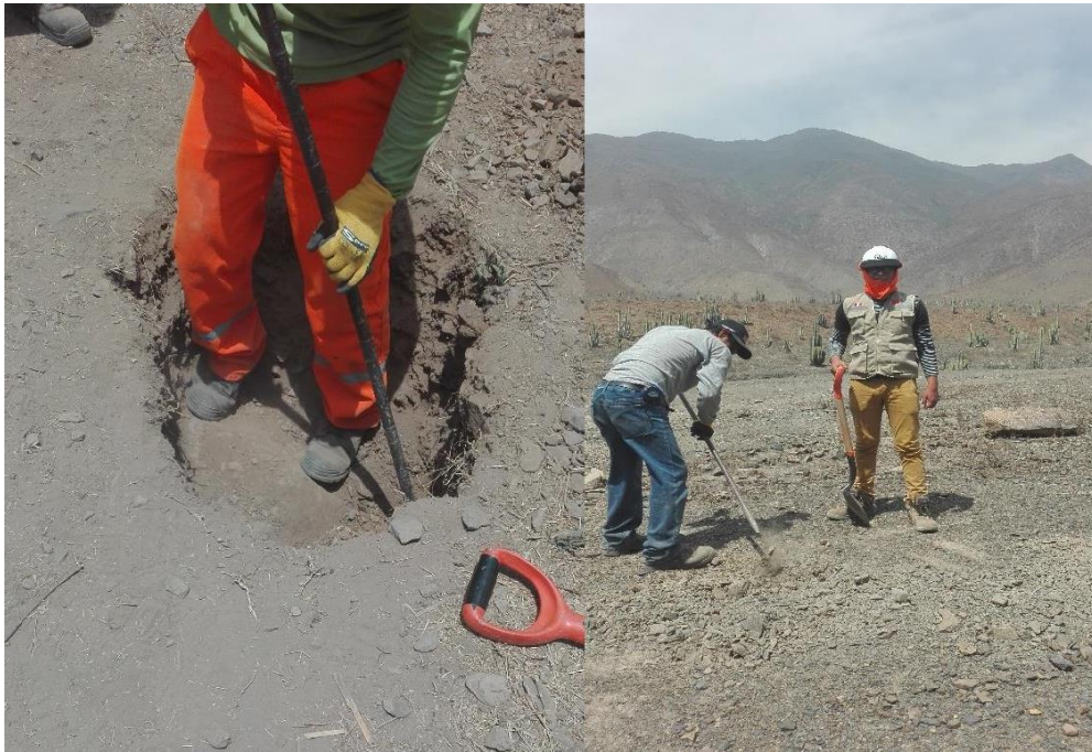
FOTOGRAFÍA N° 06: REALIZACIÓN DE LAS CALICATAS
