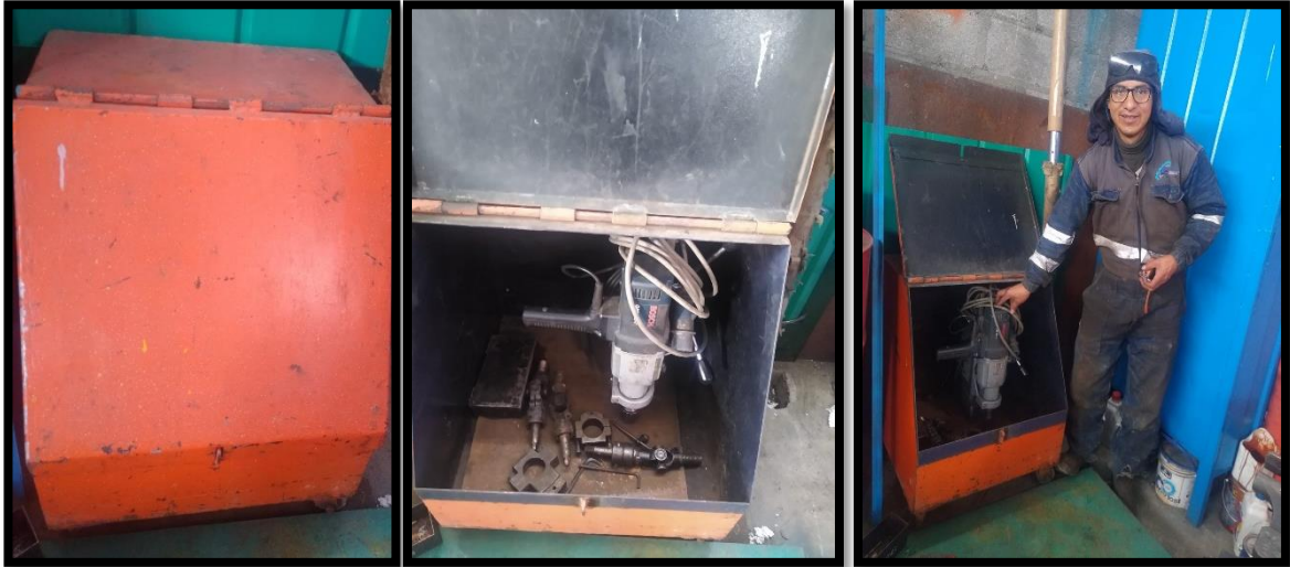
Figura 28. Caja de accesorios de mandrinadora eléctrica
