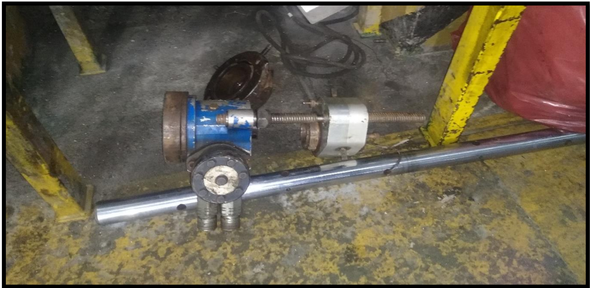
Figura 7. Alineación y montaje de mandrinadora portátil.
