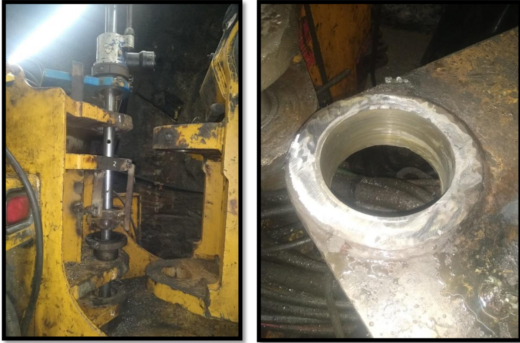
Figura 13. Mandrinado de alojamiento en socavón.
