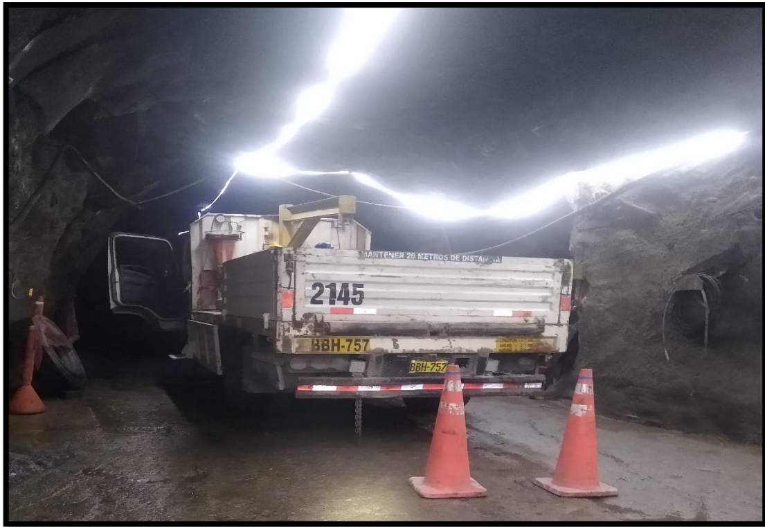
Figura 10. Camión liviano para carga de mandrinadora en mina - socavón
