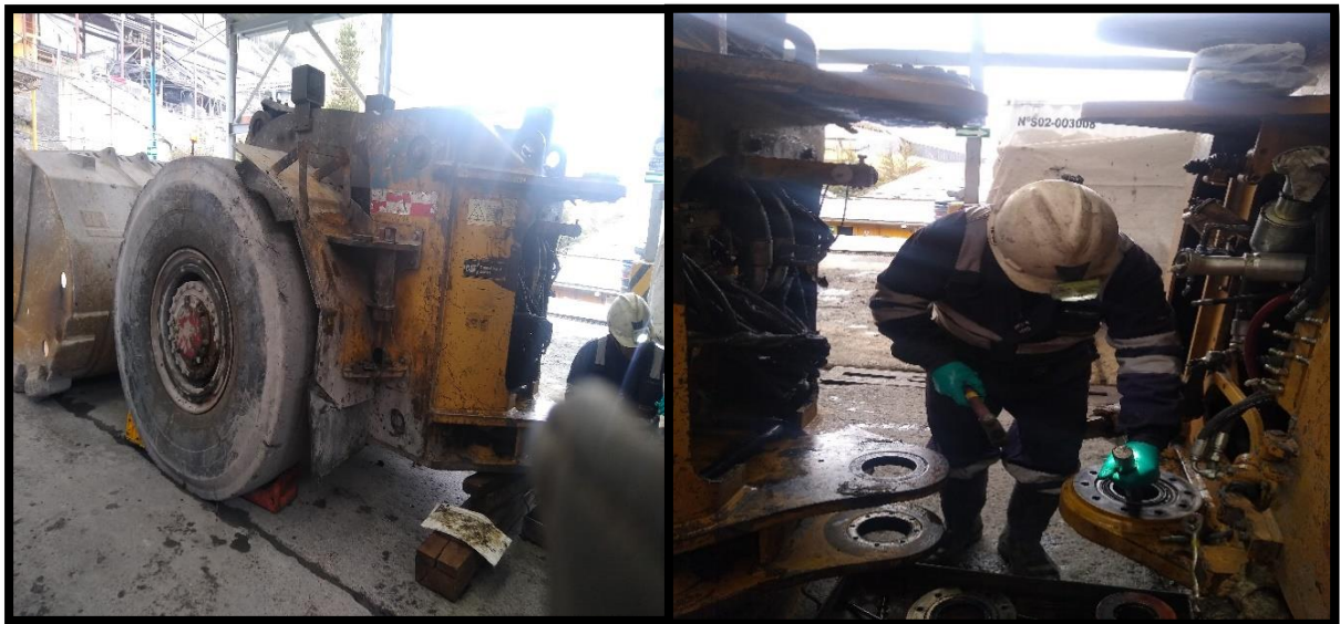
Figura 5. Inspección de Equipo a mandrinar en empresa minera - superficie
