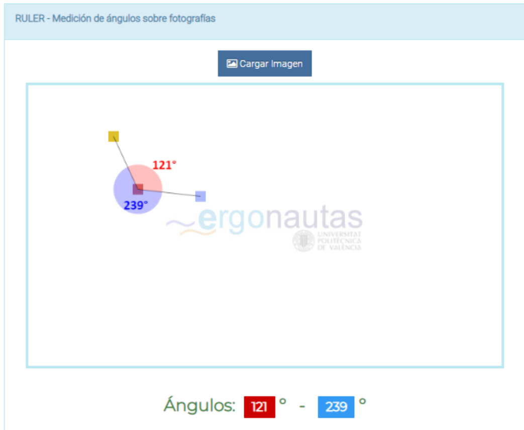
Figura 65. Herramienta RULER para la medición angular de las posturas
