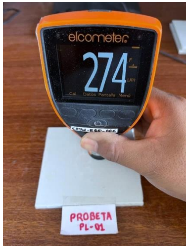
Fotografía de valor medido a la Probeta PL-01
