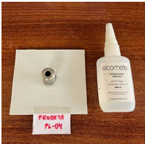
Fotografía de valor medido a la Probeta PL-04: 1900 PSI
