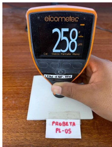
Fotografía de valor medido a la Probeta PL-05
