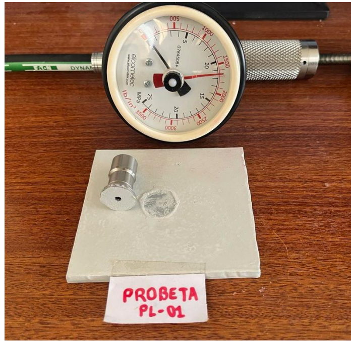
Fotografía de valor medido a la Probeta PL-01: 1650 PSI
