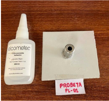
Fotografía de valor medido a la Probeta PL-01: 1650 PSI
