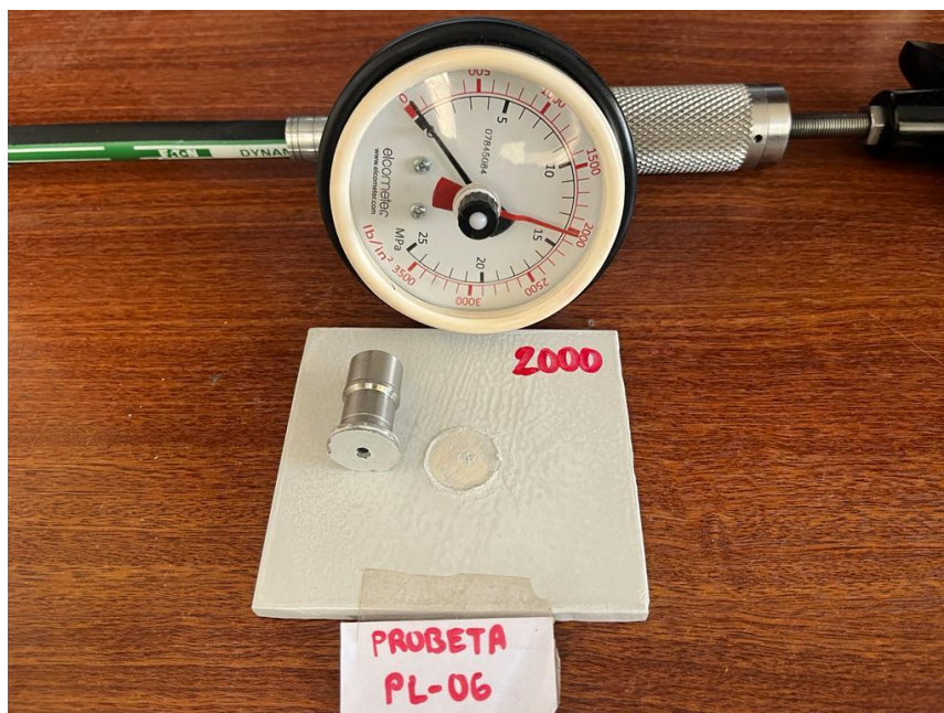
Fotografía de valor medido a la Probeta PL-06: 2000 PSI
