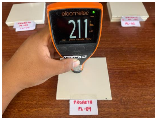
Fotografía de valor medido a la Probeta PL-04
