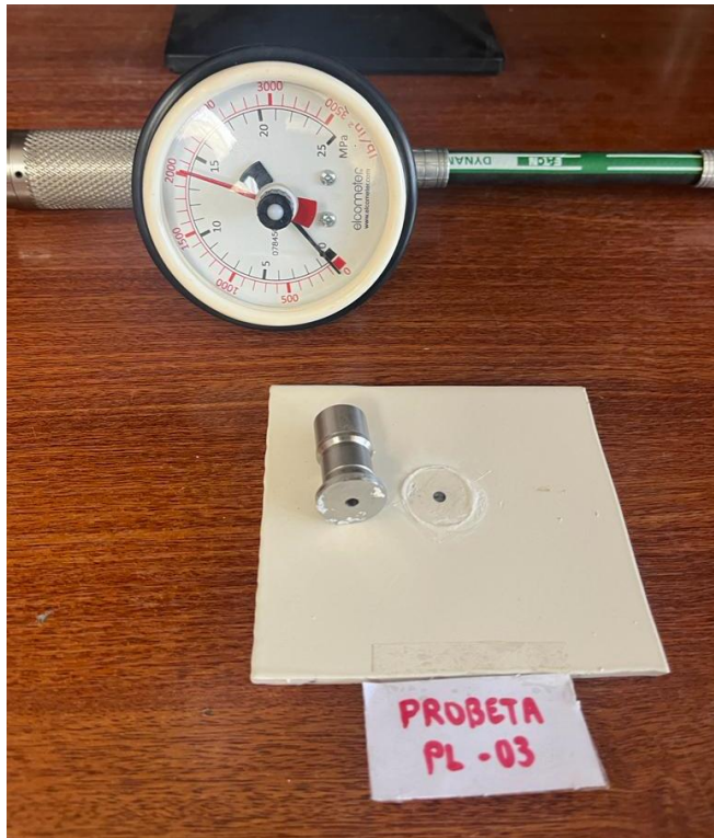
Fotografía de valor medido a la Probeta PL-03: 2000 PSI
