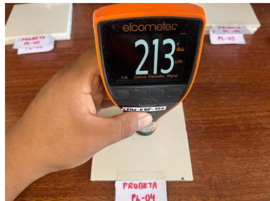
Fotografía de valor medido a la Probeta PL-04
