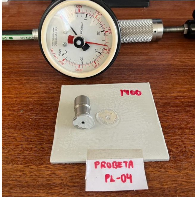
Fotografía de valor medido a la Probeta PL-04: 1900 PSI
