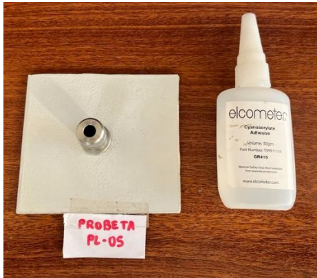
Fotografía de valor medido a la Probeta PL-05: 1850 PSI
