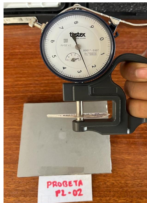
Fotografía de valor medido a la Probeta PL-02.
