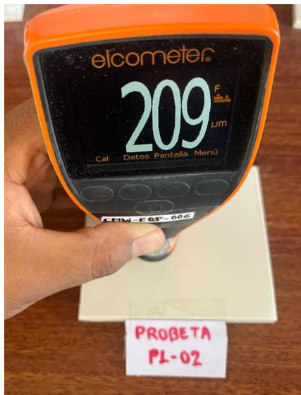
Fotografía de valor medido a la Probeta PL-02
