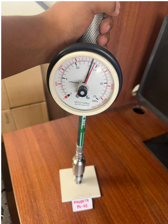
Fotografía de valor medido a la Probeta PL-02: 2200 PSI
