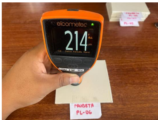
Fotografía de valor medido a la Probeta PL-06
