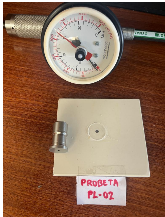
Fotografía de valor medido a la Probeta PL-02: 2200 PSI
