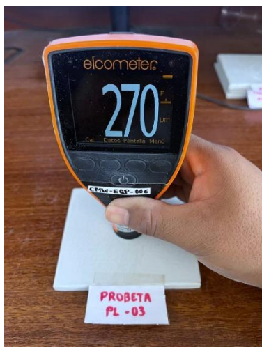
Fotografía de valor medido a la Probeta PL-03
