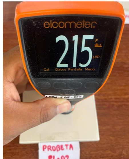
Fotografía de valor medido a la Probeta PL-02
