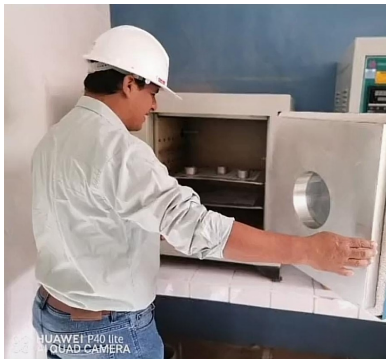
Figura 18-19. Hornos eléctricos del laboratorio para secado de las muestras.
