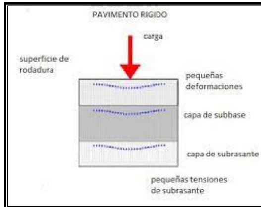
Figura 1: Estructura de Pavimento Rígido
