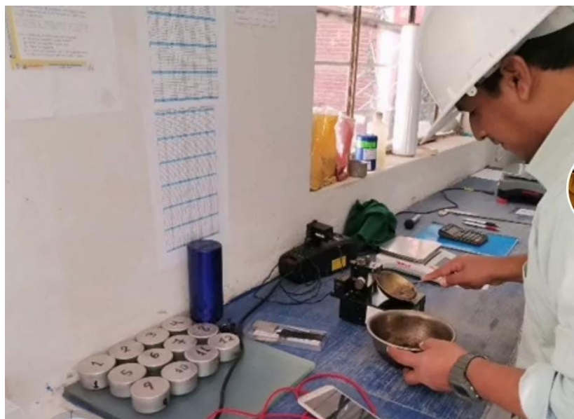
Figura 14-15. En el Laboratorio A&C Exploración, Geotecnia y Mecánica de Suelos S.R.Ltda., realizando Método Casagrande – Determinación del Limite Líquido.
