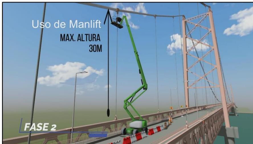
Figura 23. Simulaciones espaciales usando el equipo manlift.
