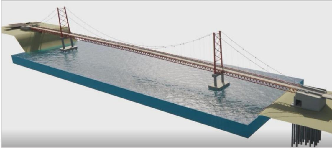
Figura 24. Modelo federado y renderizado Puente Billinghamurst integrando especialidades estructural e hidráulica.
