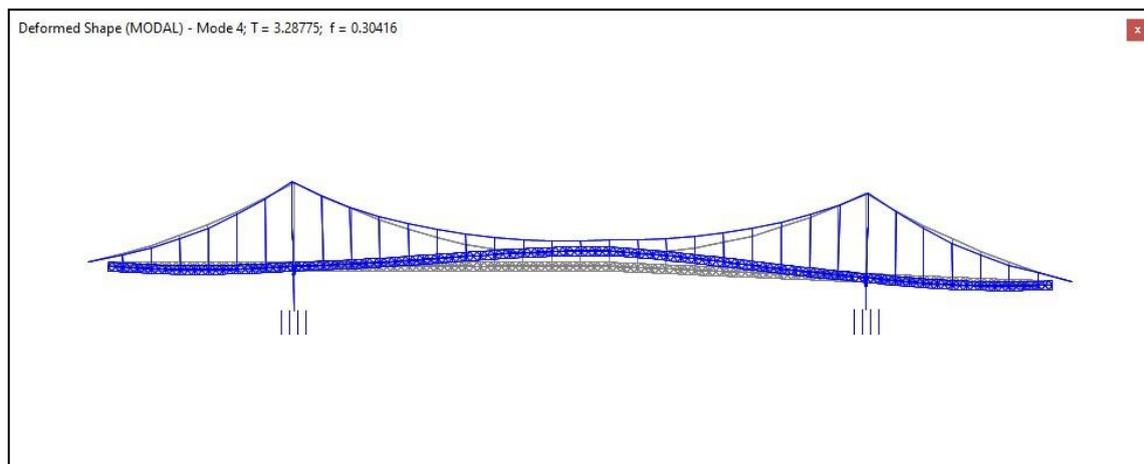
**Figura 27.** Modelo CSiBridge - Primera Forma de Modo Vertical (Oscilación Simétrica) **f= 0.304Hz**
