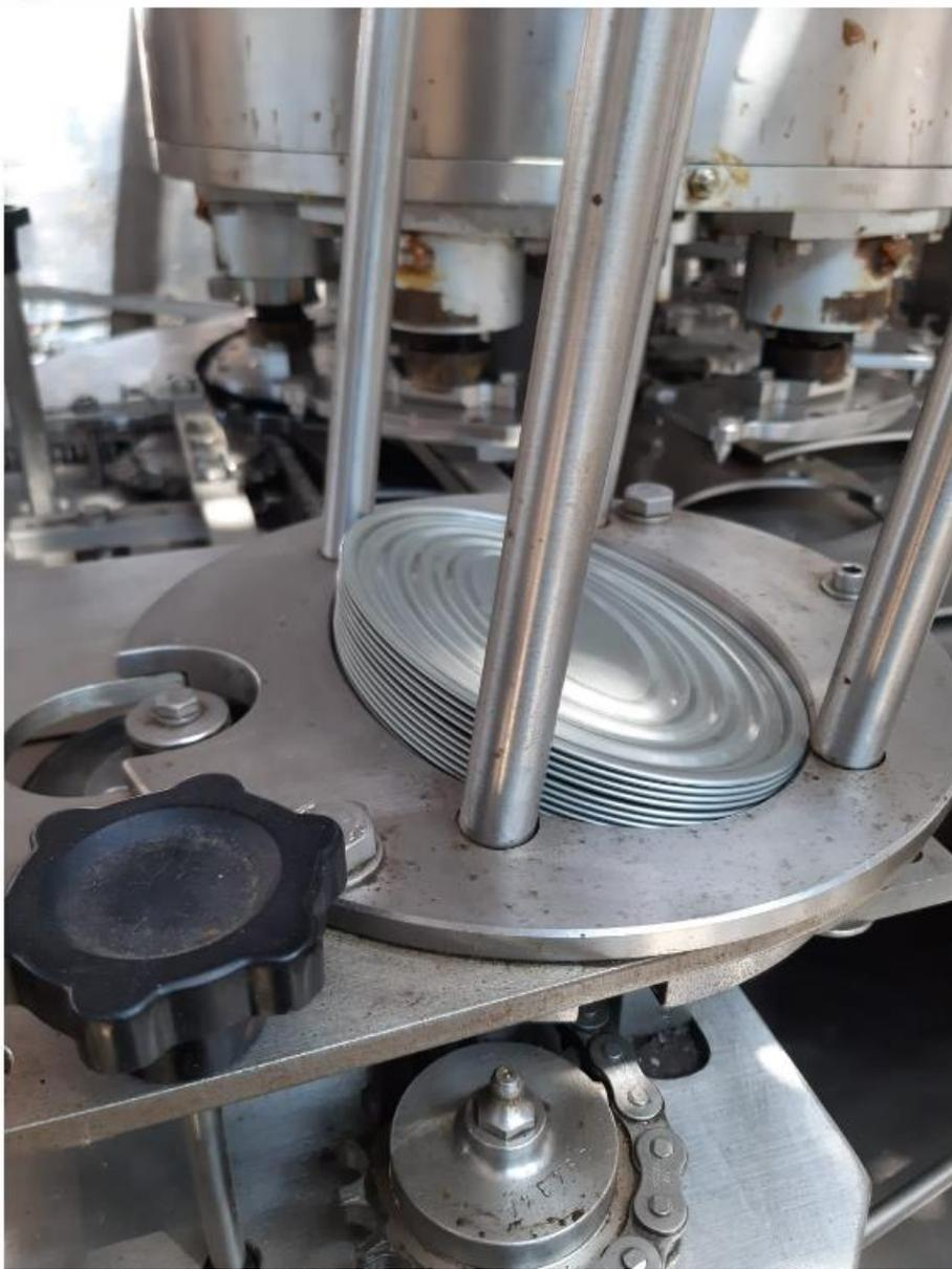
*Nota.* Prueba del depósito de tapas y varillas para el formato oval
