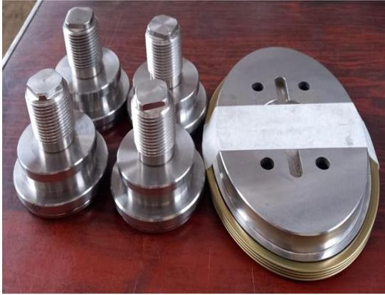
*Nota.* Mandril y rolas fabricados para la máquina cerradora
