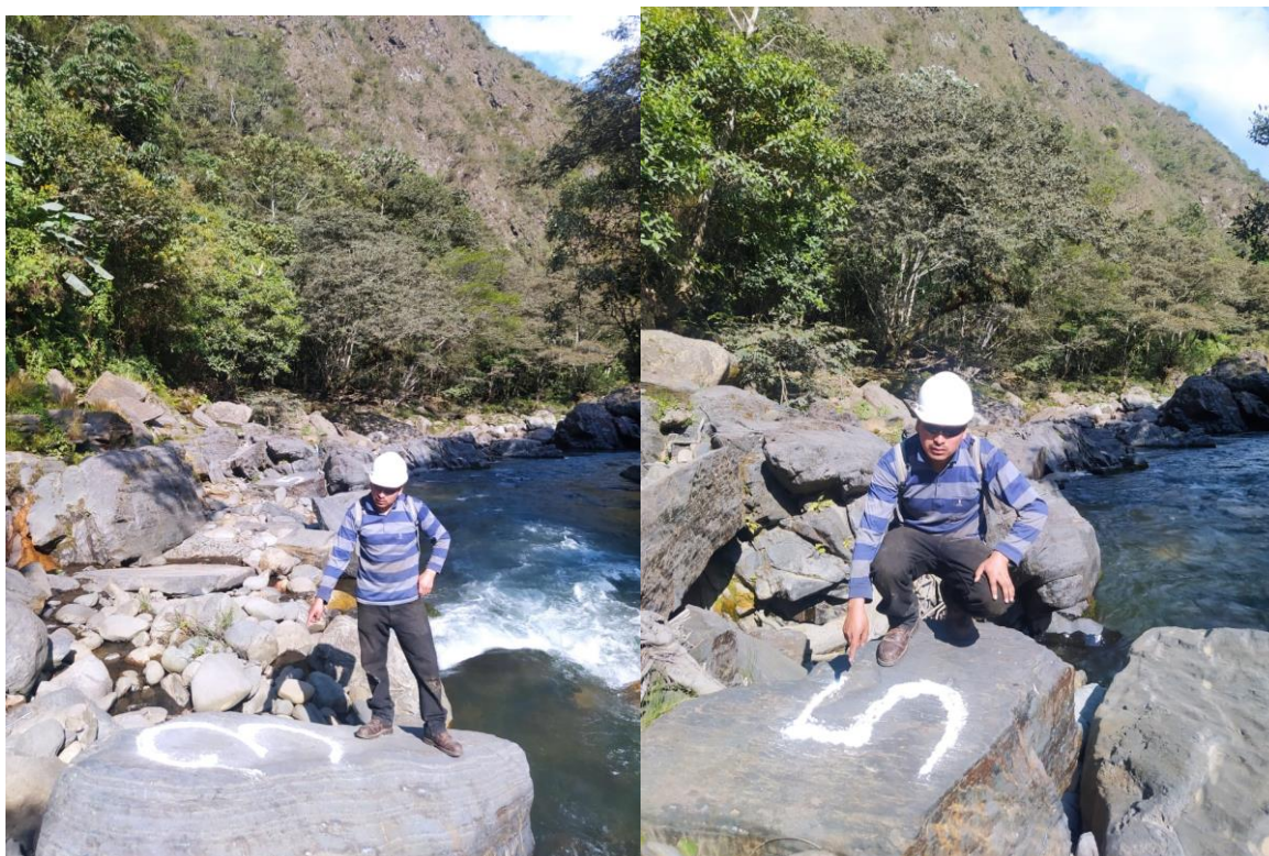
Anexo 9: Puntos de Control para la fotogrametría aérea en el Centro Poblado de Iparo.
