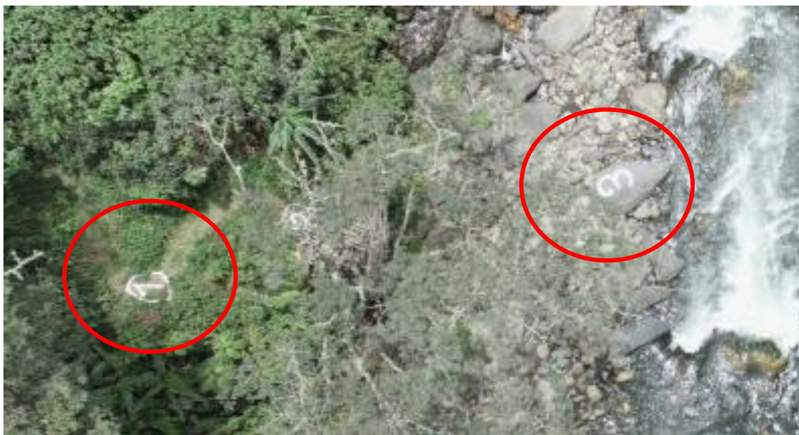
Anexo 10: Puntos de Control tomadas con dron del margen Izquierdo del río Inambari en el Centro Poblado de Iparo.
