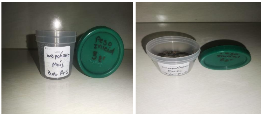
Prototipos en su encapsulación con tierra orgánica verificación de la degradación
