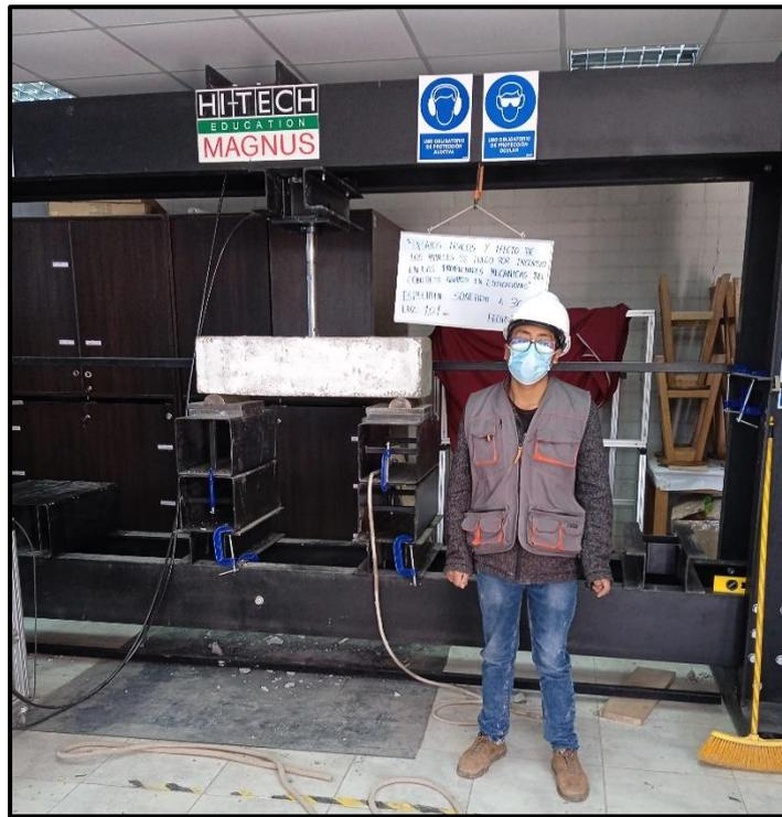
**Figura 29.** Ensayo a flexión viga sometida a 300°C.
