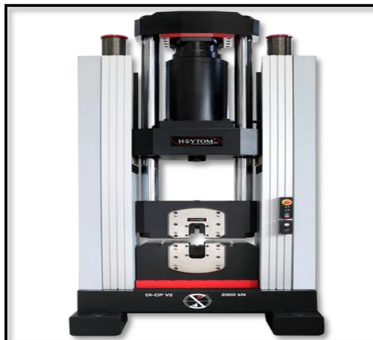
**Figura 11.** Máquina de ensayo a tracción.
