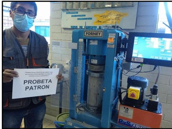
**Figura 24.** Ensayo a compresión de probeta patrón.
