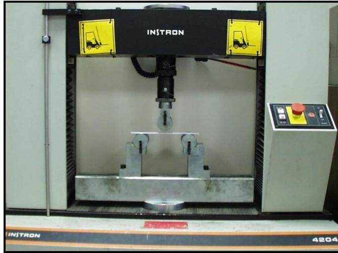
**Figura 10.** Máquina de ensayo a flexión.
