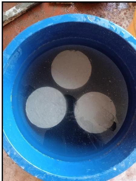
**Figura 14.** Curado de cilindros de concreto.
