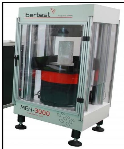
**Figura 9.** Máquina de ensayo a compresión.
