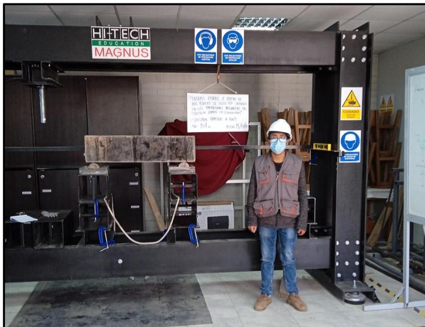
**Figura 30.** Ensayo a flexión viga sometida a 500°C.
