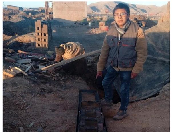
**Panel fotográfico 12:** Puente de acero para el ingreso de los especímenes al horno.
