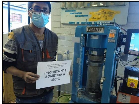
**Figura 25.** Ensayo a compresión de probeta sometida a 300°C.
