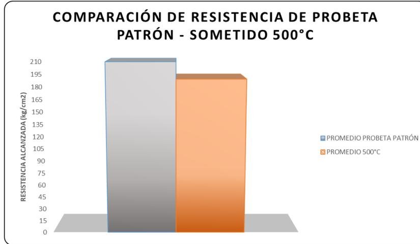
**Figura 34.** Comparación resistencia compresión de probeta patrón y 500°C.
