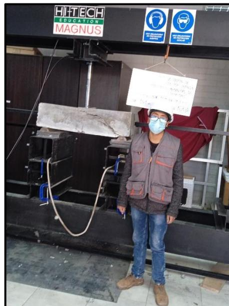
**Figura 28.** Ensayo a flexión viga patrón.
