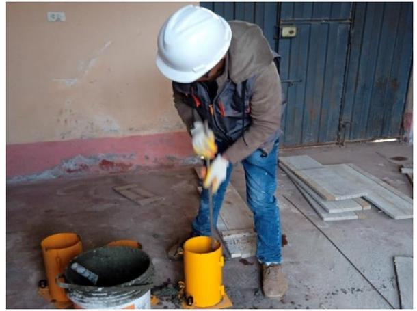
**Panel fotográfico 8:** Vaciado y varillado del concreto en briquetas.
