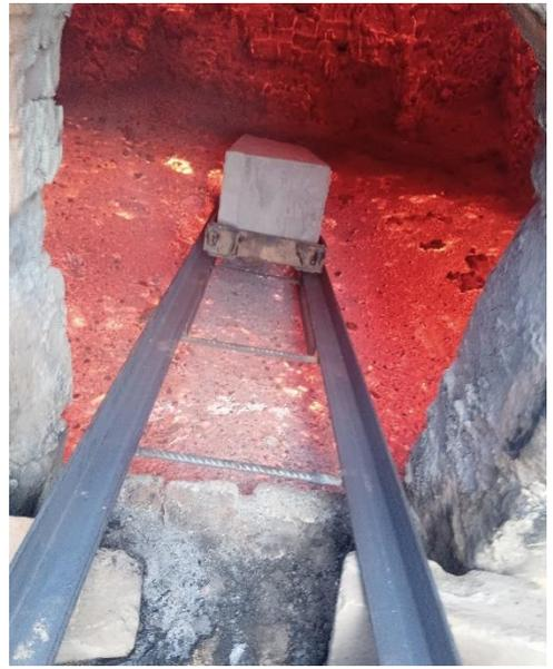
**Panel fotográfico 14:** Viga dentro del horno listo para ser sometido a fuego.
