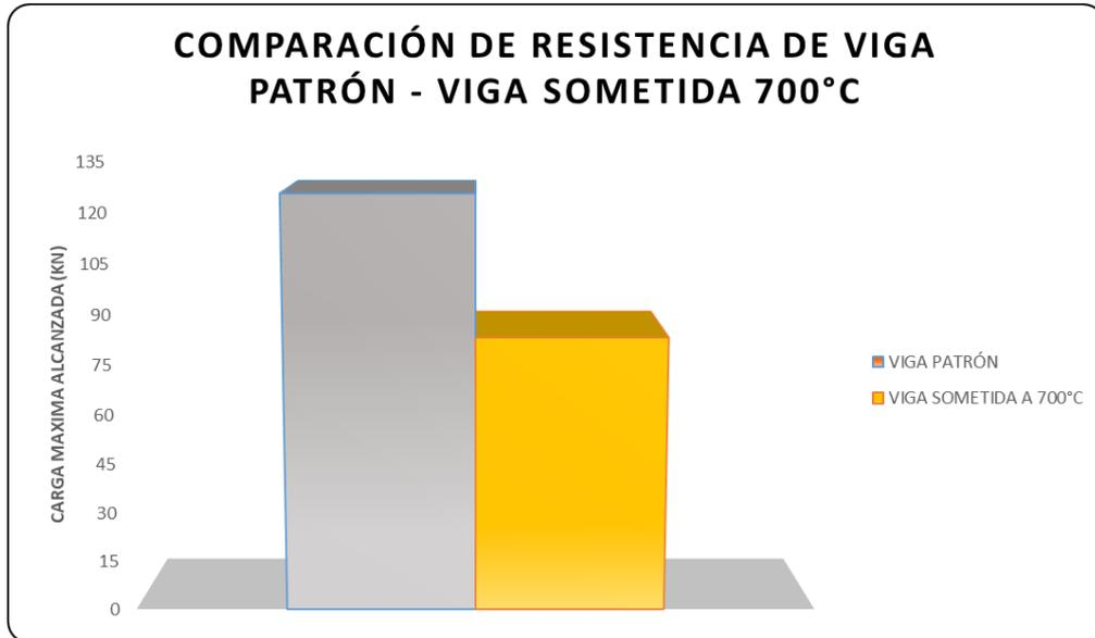
**Figura 39.** Comparación resistencia a la flexión de viga patrón y 700°C.
