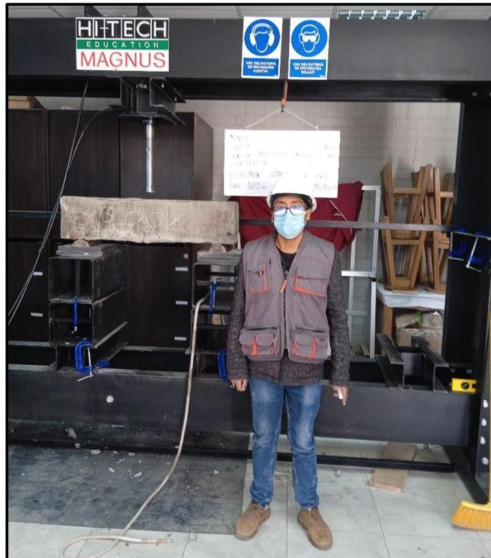
**Figura 31.** Ensayo a flexión viga sometida a 700°C.
