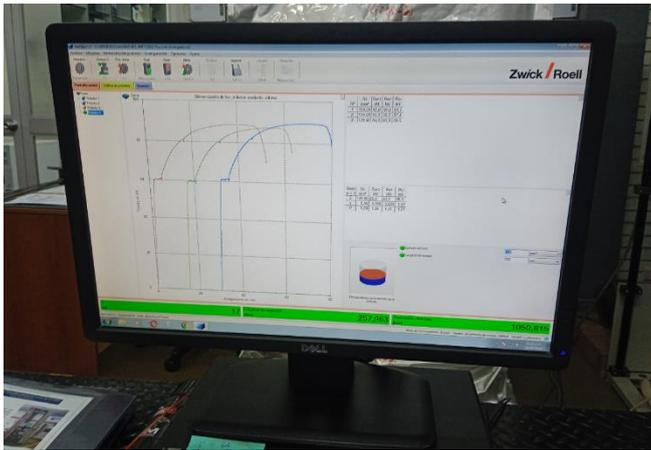
**Panel fotográfico 31:** Grafica esfuerzo-deformación.
