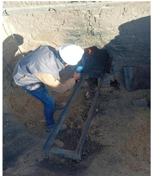
**Panel fotográfico 16:** Control de temperatura con pirómetro.
