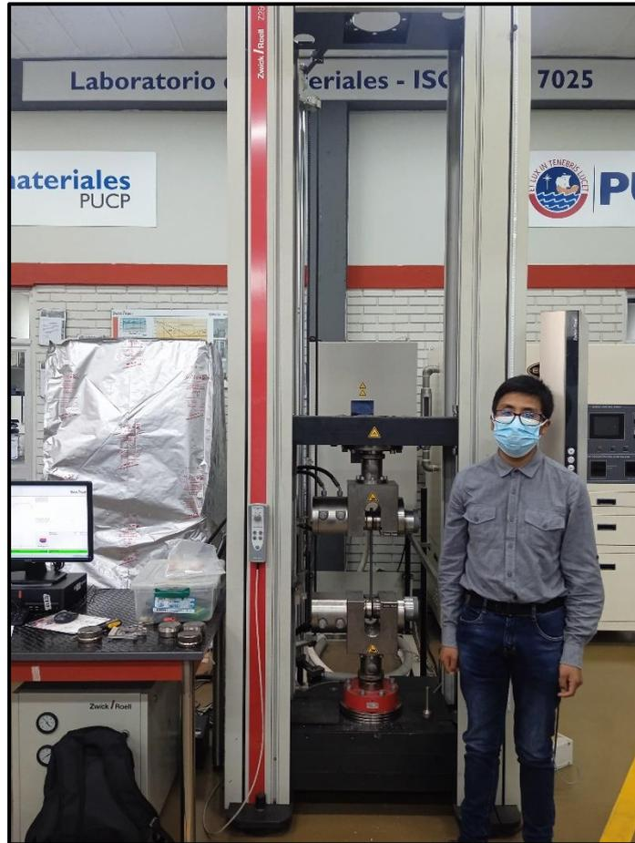
**Figura 32.** Ensayo de tracción del acero.
