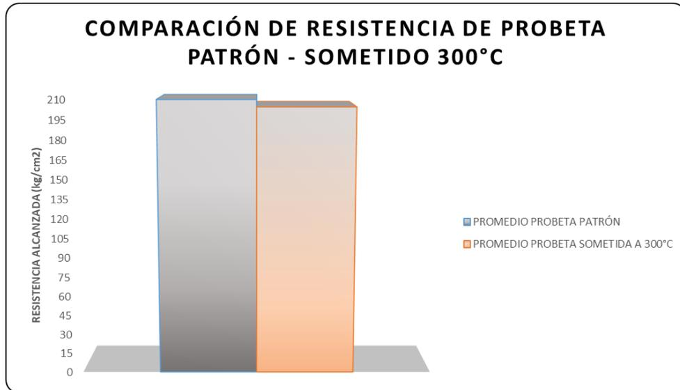
**Figura 33.** Comparación resistencia compresión de probeta patrón y 300°C.
