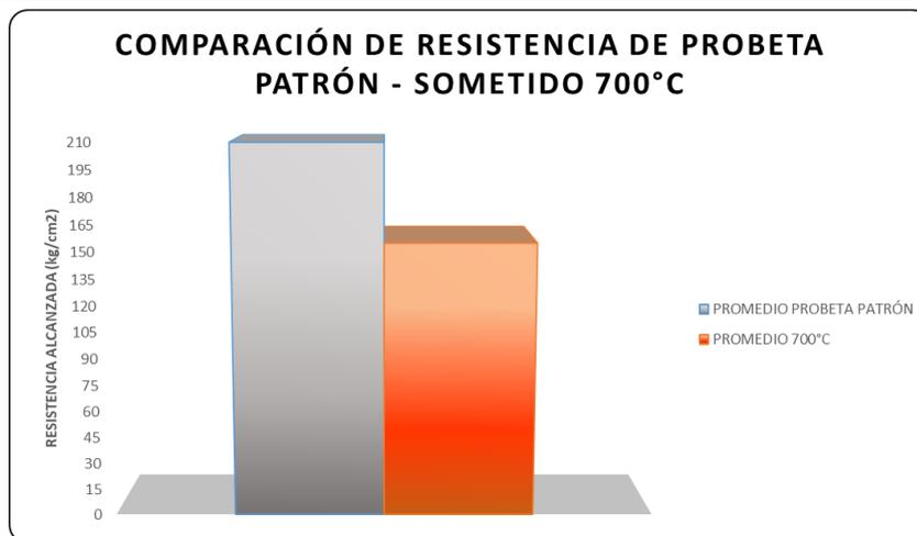
**Figura 35.** Comparación resistencia compresión de probeta patrón y 700°C
