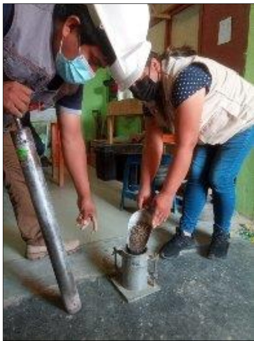
Figura 21: Incorporación de bolsas de polietileno fundido para realizar los ensayos correspondientes y evaluar los resultados.
