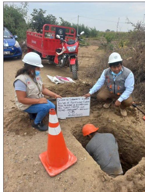
Figura 13: En las fotografías apreciamos la estratigrafía de cada calicata, estas tienen una profundidad de 1.50 metros, las cuales fueron excavadas cada 1000 metros a lo largo del tramo.
