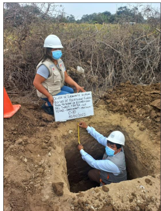
Figura14: Vista de la calicata C-10. Se evidencia Suelo clasificado como GC (Grava Arcillosa con arena) según SUCS y A-4 (3) según AASHTO.
