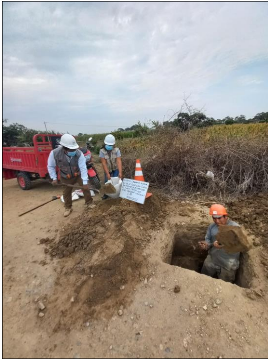
Figura 13: Una vez extraídas las muestras de las calicatas se empackaron en sacos para poder transportarlas al laboratorio.
