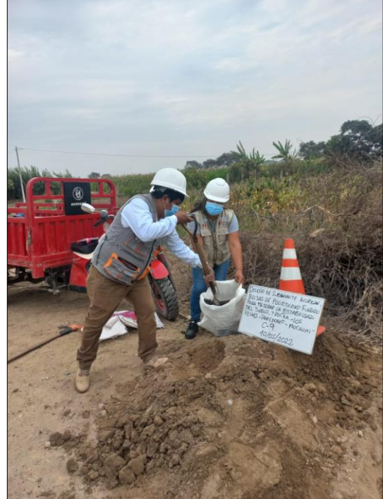
Figura 13: Una vez extraídas las muestras de las calicatas se empackaron en sacos para poder transportarlas al laboratorio.
