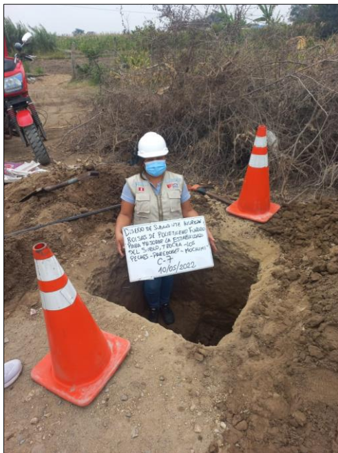
Figura 13: En las fotografías apreciamos la estratigrafía de cada calicata, estas tienen una profundidad de 1.50 metros, las cuales fueron excavadas cada 1000 metros a lo largo del tramo.
