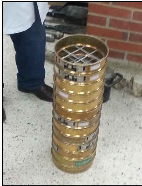
Figura 8: Los tamices se utilizan para medir el tamaño de las partículas.
