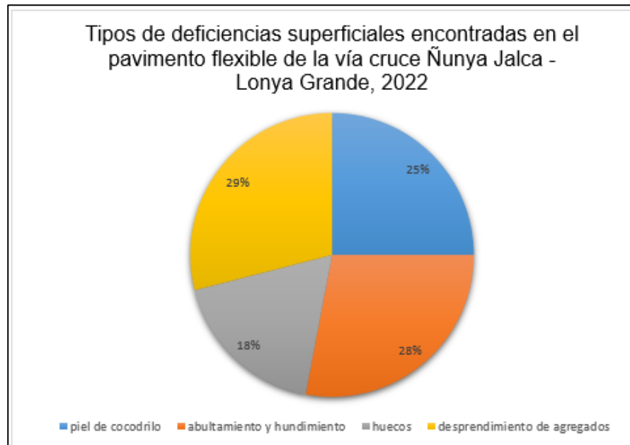
Figura 28. Deficiencias encontradas en el pavimento flexible del Kilómetro 13 km + 280 m
