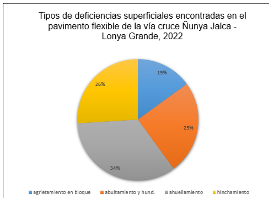
Figura 29. Deficiencias encontradas en el pavimento flexible del Kilómetro 13 km + 320 m
