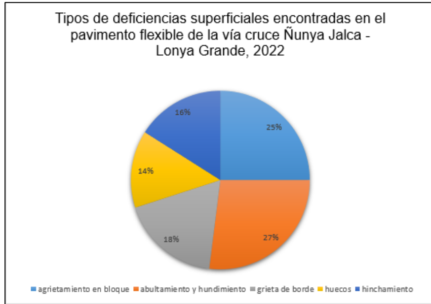
Figura 26. Deficiencias encontradas en el pavimento flexible del Kilómetro 13 km + 200 m
