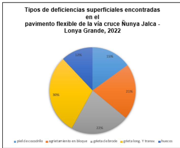
Figura 25. Deficiencias encontradas en el pavimento flexible del Kilómetro 13 km + 160 m
