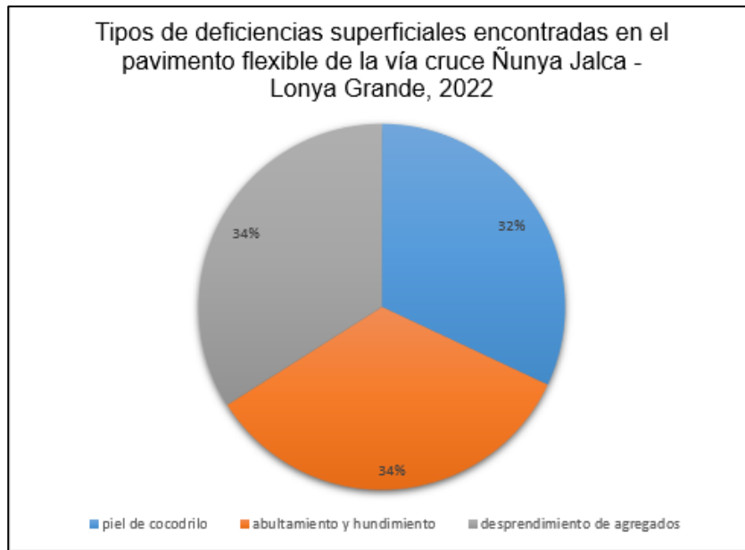
Figura 30. Deficiencias encontradas en el pavimento flexible del Kilómetro 13 km + 360 m
