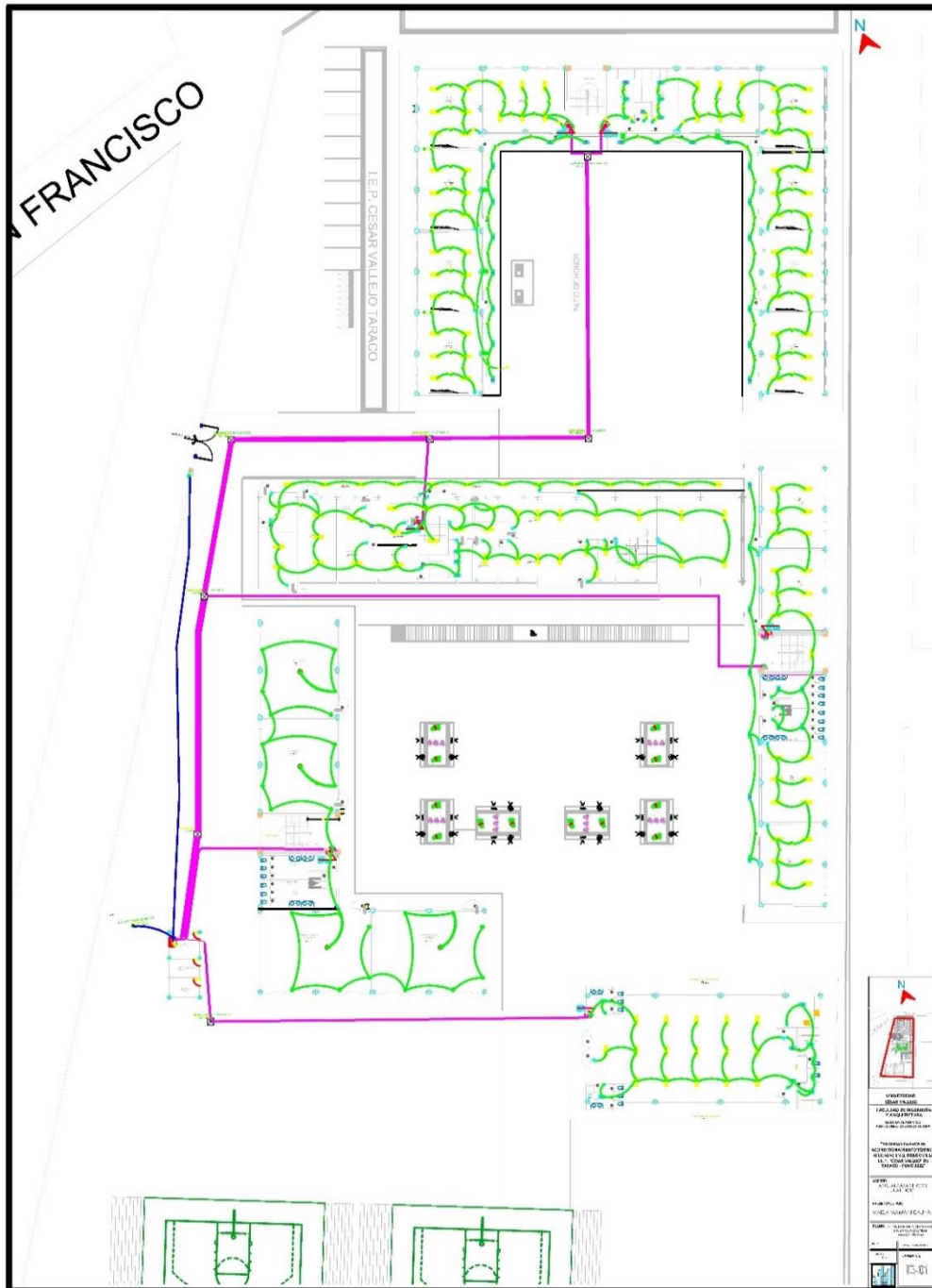
Figura 77: Plano general de instalaciones eléctricas
