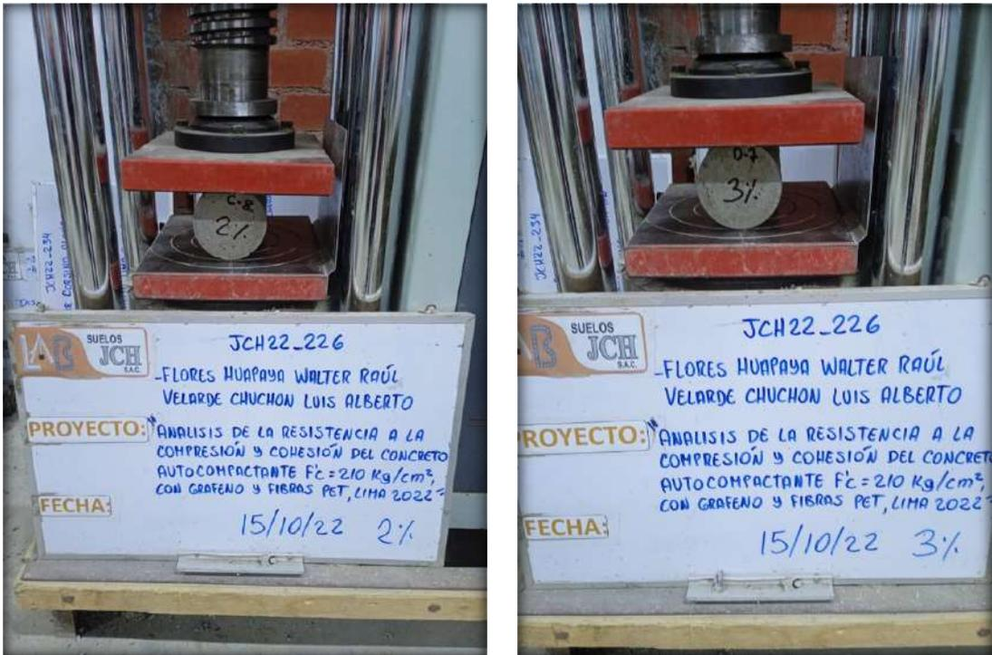
FOTO 12. MUESTRAS ENSAYADAS A LA TRACCIÓN INDIRECTA A LOS 7 DÍAS DE CURADO
