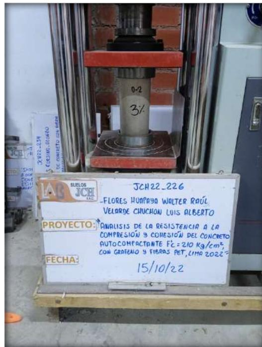
FOTO 9. MUESTRAS ENSAYADAS A LA COMPRESIÓN A LOS 7 DÍAS DE CURADO
