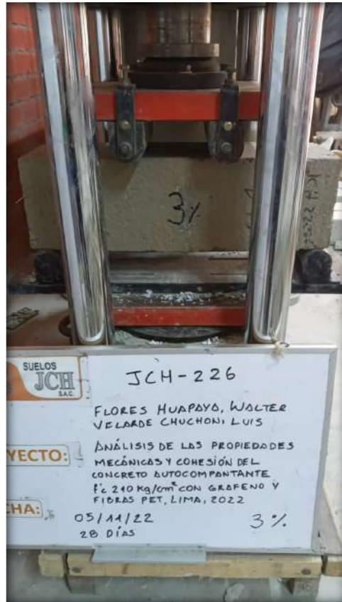
FOTO 14. MUESTRAS ENSAYADAS A LA FLEXIÓN A LOS 28 DÍAS DE CURADO
