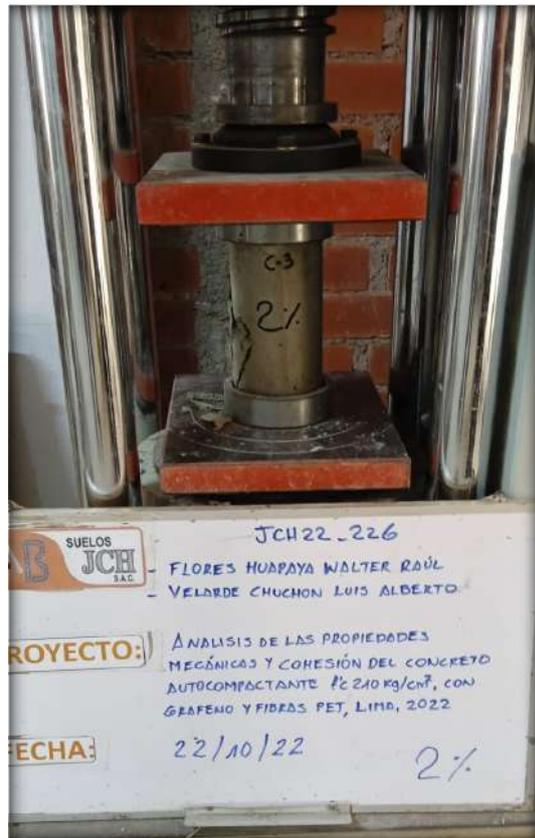
FOTO 10. MUESTRAS ENSAYADAS A LA COMPRESIÓN A LOS 14 DÍAS DE CURADO
