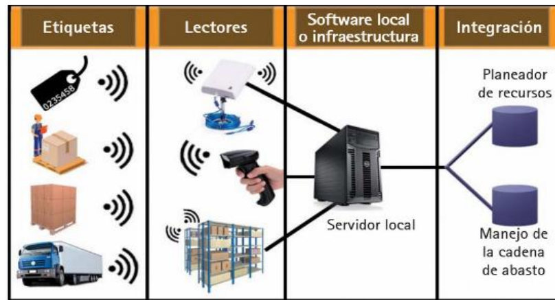
Figura 1. Funcionamiento del RFID
